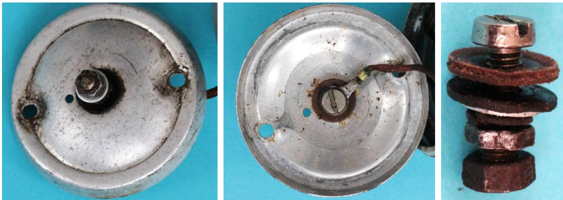
Bild 4.5: Spannung führender Kontakt: a) Isolierte Befestigung im Boden, b) Ankeranschluss mit Kabelschuh auf der Innenseite, c) Kabelbolzen mit Isolierscheiben
