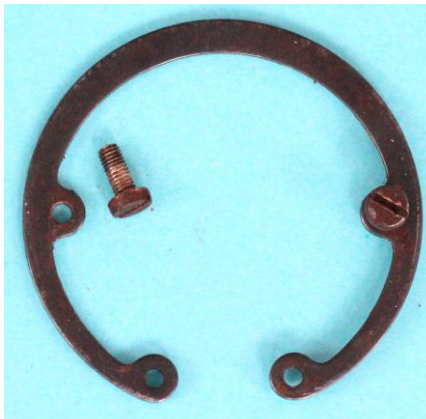
Bild 3.7: Klauenpol- anker: a) Anker im Gehäuse gesichert, b) Spreizring mit zwei Gewindebohrungen
