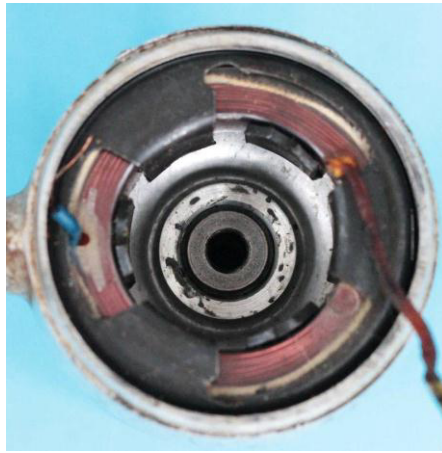
Bild 4.9: Anker: a) Stirnseiten des Polrades und des Ankers, b) Blick durch den Anker auf das untere Gleitlager
