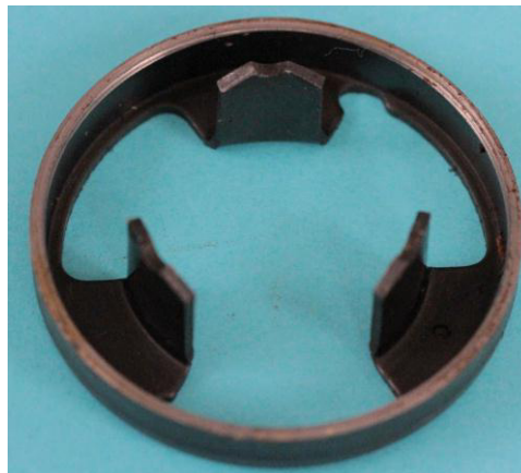
Bild 4.8: Ankereisen: a) Positionierung der Klauenpolkränze zueinander, b) Klauenpolring
