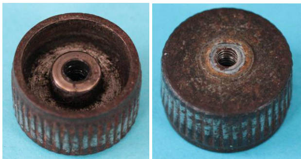
Bild 4.3: Reibrad: a) Freiraum für einen Filzring, b) Glatte Oberfläche mit Gewindebohrung
