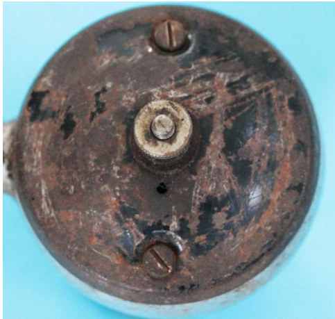
Bild 3.3: Boden aus Eisenblech: a) Bodenansicht, b) Abgenommener Boden
