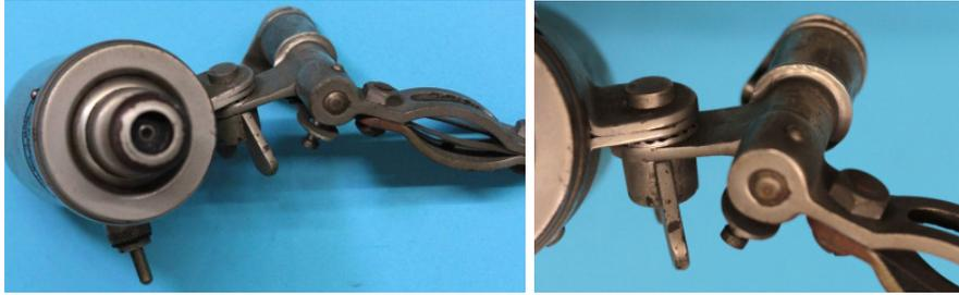
Bild 2.15: Ansichten der Kippvorrichtung von oben
