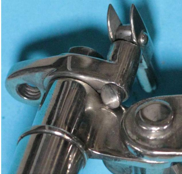
Bild 2.5: Sperrstift in der Raststellung
