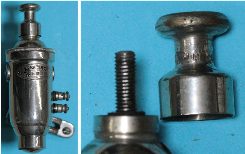
Bild 2.3: Reibrad mit glatter Lauffläche
