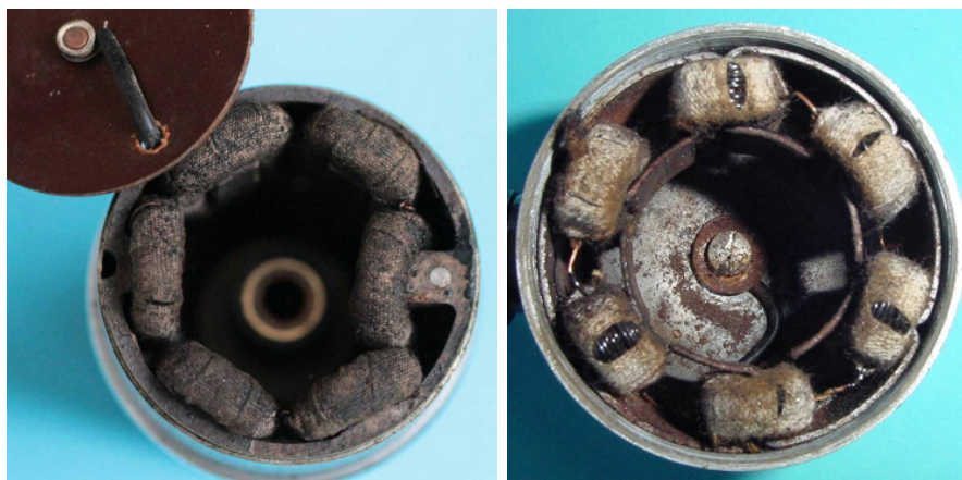
Bild 1.5: Ankerwicklungen: a) Spannbanddynamo, b) Dynamo mit Aluminiumgehäuse
