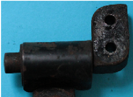
Bild 2.4: Kippvorrichtung und Spannband: a) Drehbolzen mit massivem Klemmstück, b) Federnder Spannring mit angeschweißten Laschen
