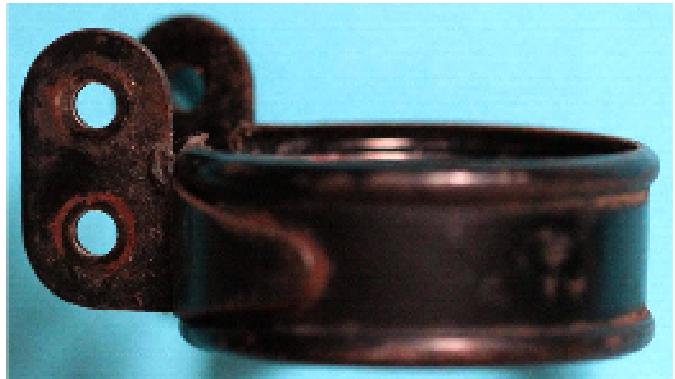
Bild 2.4: Kippvorrichtung und Spannband: a) Drehbolzen mit massivem Klemmstück, b) Federnder Spannring mit angeschweißten Laschen
