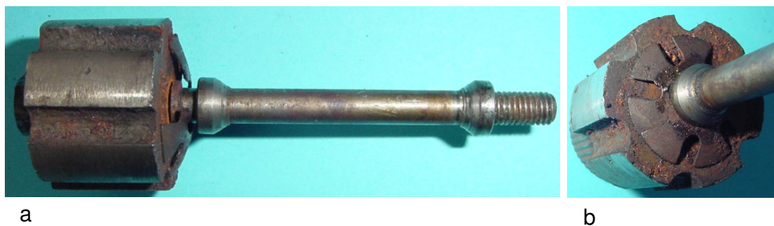
Bild 2.14: Polrad mit Nuten in den Pollücken, Länge: 17mm, Durchmesser: 24,5 mm
