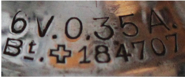
Bild 1.3: Nenndaten, Fertigungsnummer und Länderkennzeichen des Dynamos mit Spannband
