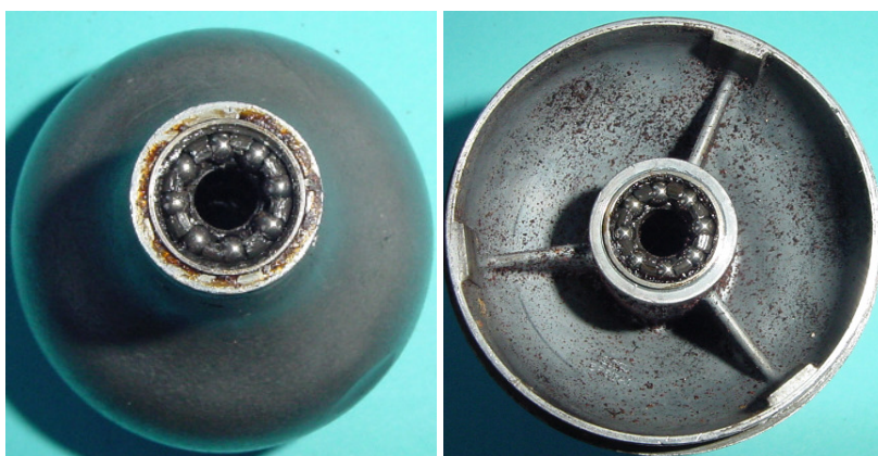
Bild 2.15: Lagerung a) Oberes Kugellager b) Unteres Kugellager
