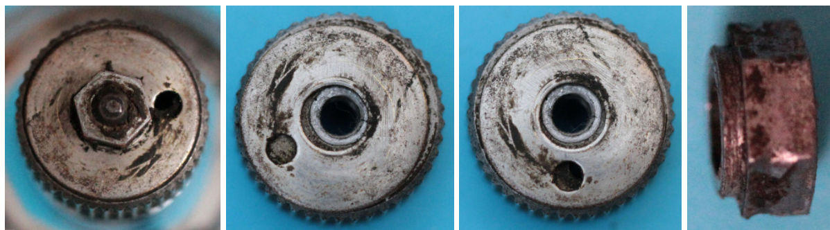
Bild 2.7: Verschließbare Ölbohrung im Reibrad: a) Reibrad mit Kontermutter, b) Verdeckte Ölbohrung, c) Teilweise sichtbare Ölbohrung, d) Abgesetzte Kontermutter
