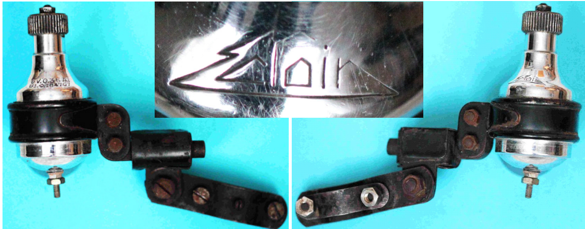
Bild 2.1: Eclair mit Spannbandbefestigung
