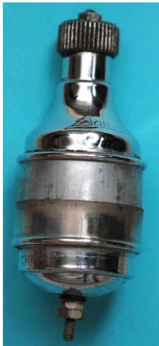
Bild 2.5: Gehäuse: a) Ineinander geschobener Lagerhals- und Bodentopf
