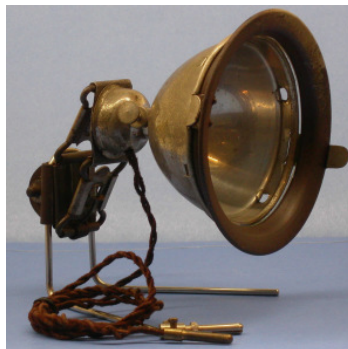
Bild 2.6: Quast & Co: Erster Blender in der Fahrradlichtanlage „Original S.S.Lampe“: a) Abbildung im Rad Markt März 1910, b) Ausgeführter Blender
