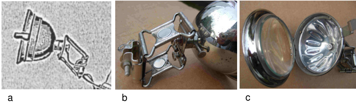
Bild 2.7: Quast & Co, Blender aus dem Jahre 1911, Zylinderförmiger Übergang vom Reflektorgehäuse zur Schwinge: a) Darstellung in der Beschreibung von / 6/ , b) und c) Ausgeführter Blender als Teil der Anlage „Original S.S. Lampe 150“
