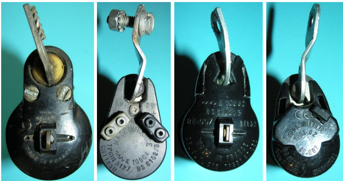
Bild 5.2: Befestigungsvarianten des Bodens am Lagerhalstopf: a) Zwei Schlitzschrauben, b) Eine Kreuzschlitzschraube, c) Aufgeschobener Boden, d) Eingeklinkte Haken
