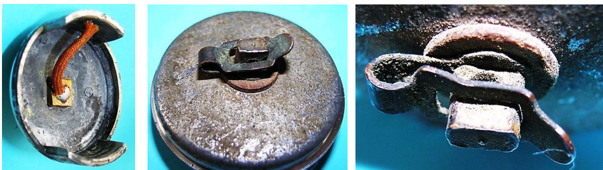
Bild 2.5: Spannung führender Anschluss: a) Lötstelle am Kontaktbolzen, b) Boden mit der Federklemme, c) Bohrung im Kontaktbolzen
