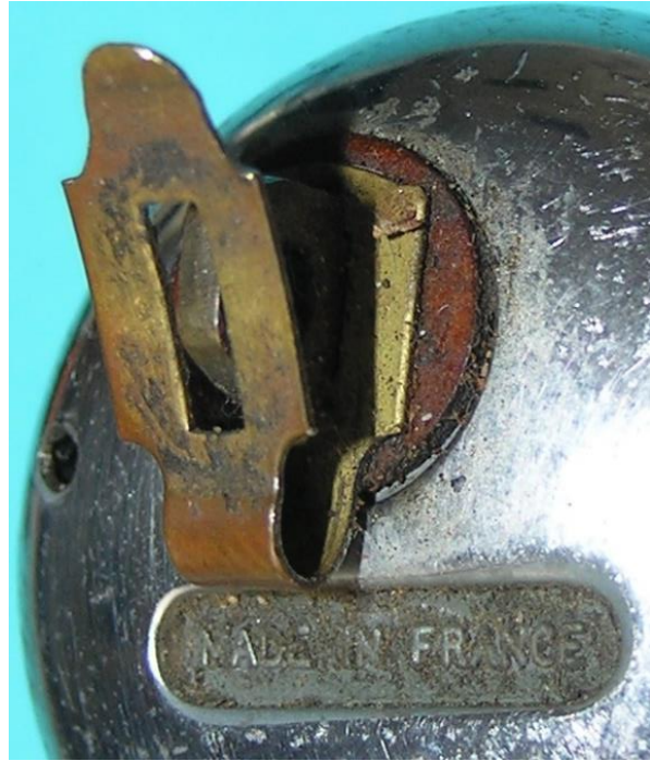
Bild 3.17: Kabelanschlussklemme: a) Kontaktpunkte mit dem Kontaktsteg auf der Bodeninnenseite, b) Federklemme
