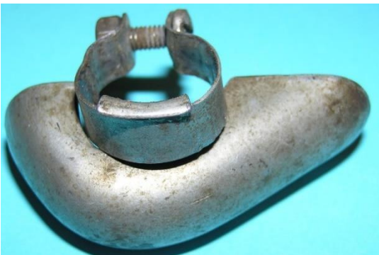
Bild 3.5: Schmutzfänger mit Schelle
