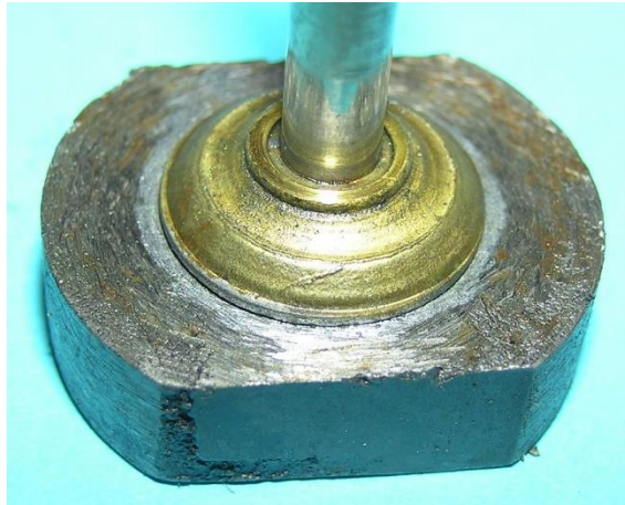
Bild 3.9: Polrad: Zwei-poliger Magnet mit angelöteter 5 mm-Welle a) Axiale Länge: 8 mm b) Poldurchmesser: 29 mm
