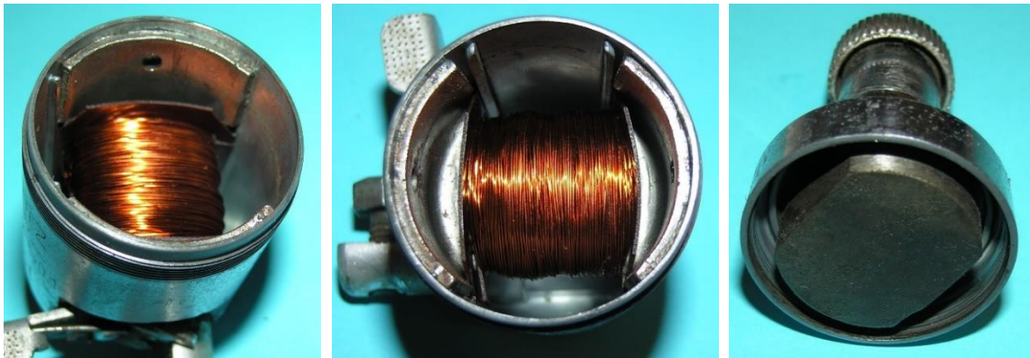
Bild 3.7: Generator: a) und b) Gehäusetopf mit Anker, c) Lagerhals mit Polrad
