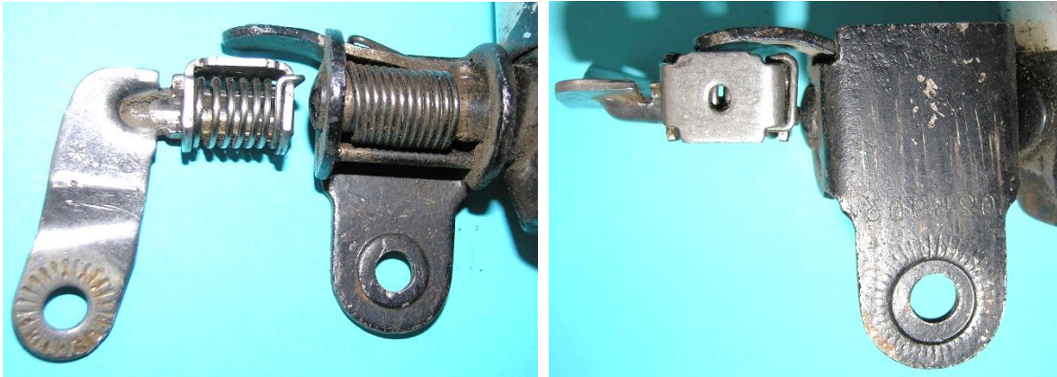
Bild 5.48: Vergleich der Basisbleche von Soubitez-Electra und einem Berko-Hufeisenmagnet-Dynamo
