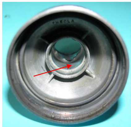
Bild 3.10: Gleitlager-sitze im Lagerhals: a) Oberer Lagersitz, b) Unterer Lagersitz
