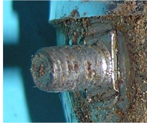
Bild 4.6: Einsatz des Lampenbolzens im Boden, a) Soubitez 8-J4, b) Soubitez 89 c) Lampenbolzen
