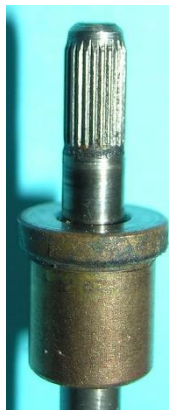
Bild 5.42: Ahtpoliger Walzenmagnet: Durchmesser: 27,8 mm, Axiale Länge: 18 mm
