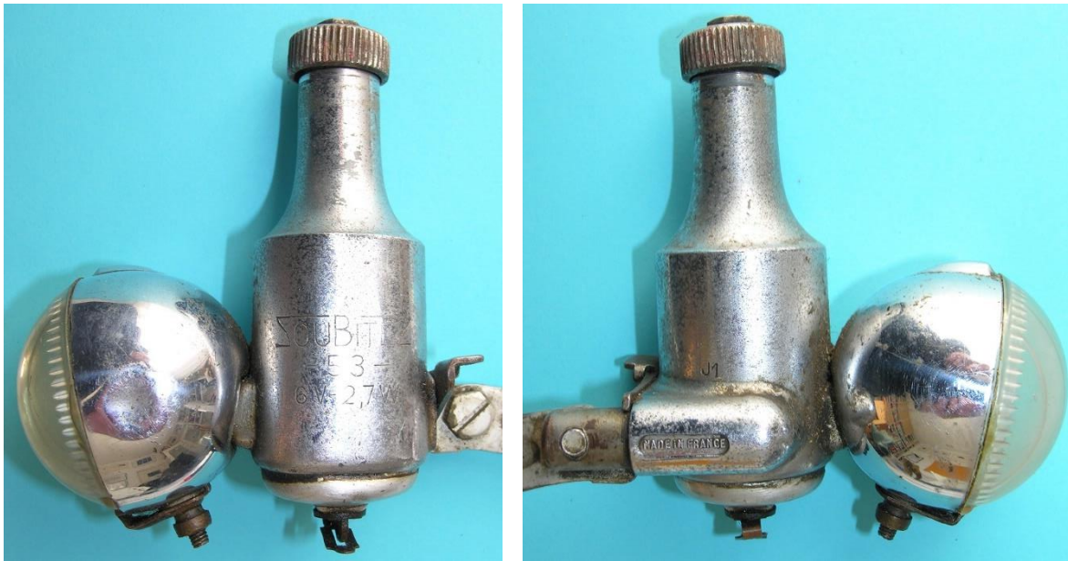
Bild 3.20: Gegenseitige Anpassung der Gehäuse von Lampe und Dynamo
