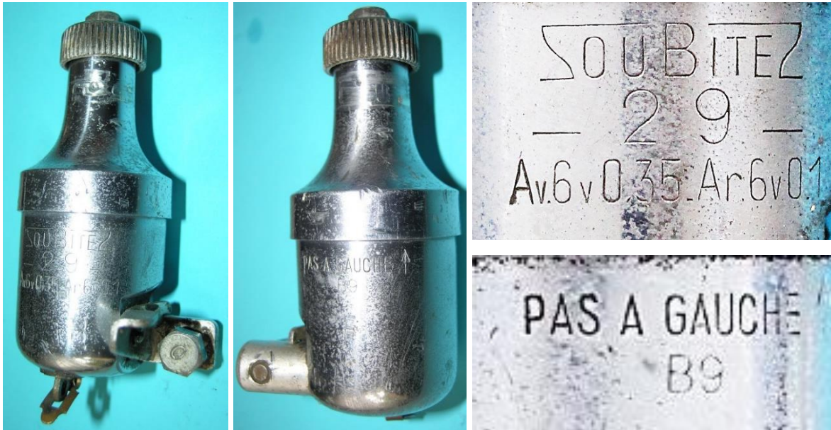
Bild 3.2: Beschriftung des Mantels mit dem Markennamen, der Typennummer, den Nenndaten und dem Hinweis auf ein Linksgewinde der Gehäuseteile
