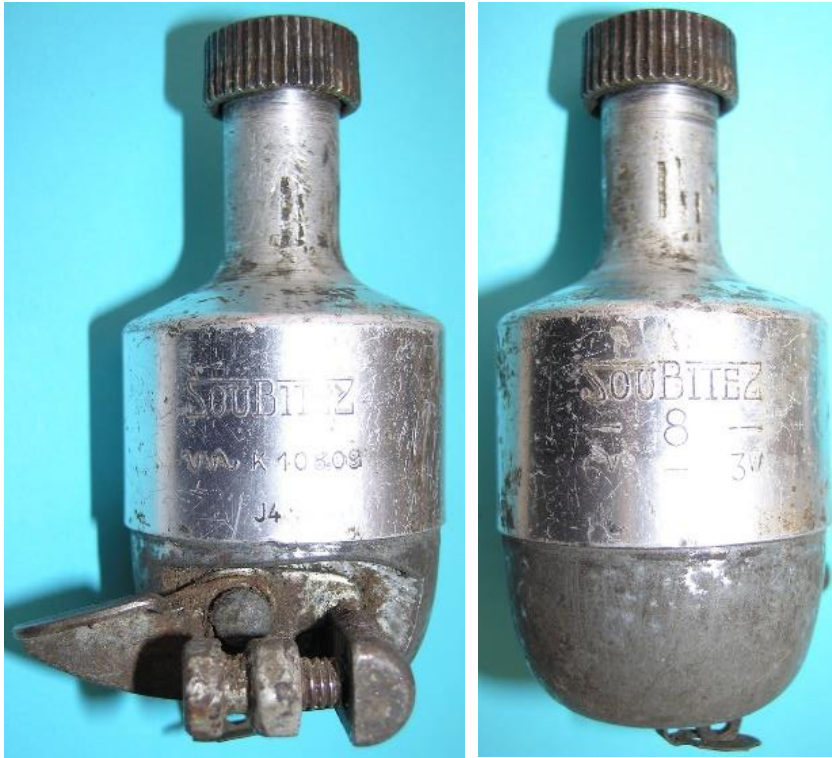
Bild 4.2: Soubitez 8, J4 mit einem Aluminiumlagerhalstopf, Gewicht 256 g K-10809
