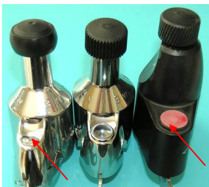
Bild 5.21: Bedienungsflächen: a) Soubitez Alt 32, D, b) Soubitez Alt 42, D c) Soubitez Electra, 1D, K-10904
