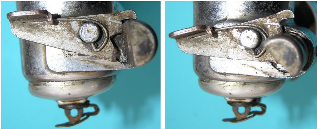
Bild 3.28: Bedienungshebel: a) Ruhestellung, b) Betriebsstellung
