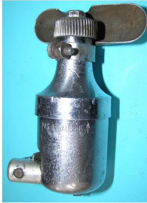
Bild 3.4: Soubitez 29 mit Schmutzfänger, Gewicht: 270 g
