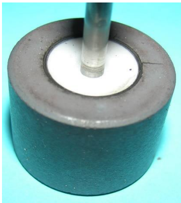
Bild 5.42: Ahtpoliger Walzenmagnet: Durchmesser: 27,8 mm, Axiale Länge: 18 mm
