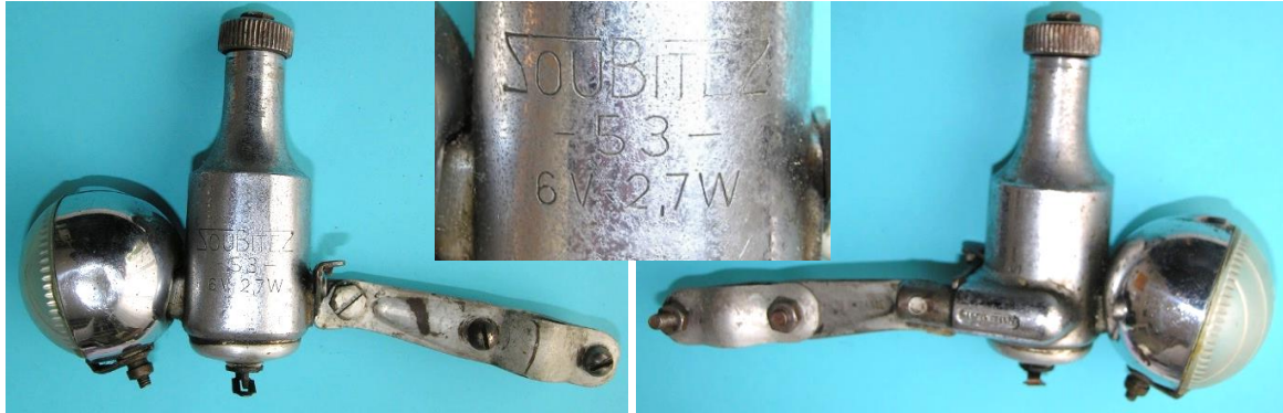
Bild 3.18: Dynamo-Lampen-Kombination Soubitez 53, J1; 2,7 W
