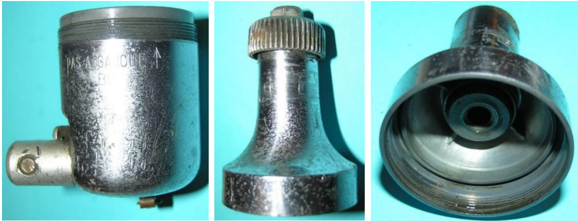
Bild 3.6: Gehäuse mit linksgängigem Feingewinde: a) Gehäusetopf mit Außengewinde, b) Lagerhals, c) Lagerhalsfuß mit Innengewinde
