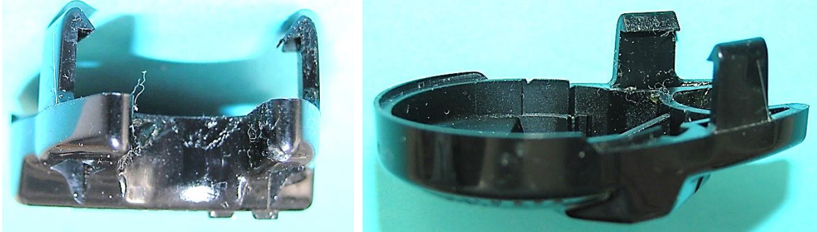
Bild 5.30: Zwei am Boden angespritzte Haken zum Einklinken in Vertiefungen des Gehäusemantels
