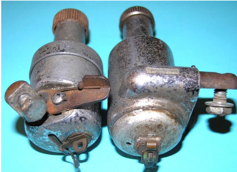
Bild 1.27: Anbauvarianten der Kippvorrichtung a) Soubitez 39 b) Soubitez 28
