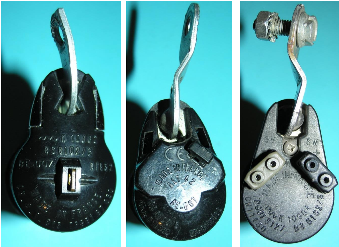
Bild 5.22: Bodenansichten der drei Typen mit der Verschiebebolzen-Kippvorrichtung: a) Soubitez Alt 32, D, K-10882, ab 1987, b) Soubitez Alt 42, D und 1D, K-10882, ab 1987, c) Soubitez Electra K-10904, 1D
