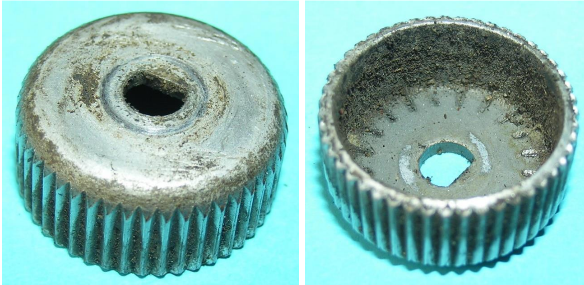
Bild 3.12: Stahlreibrad aus einem 1,5 mm starken Blech ausgeschnitten und verformt
