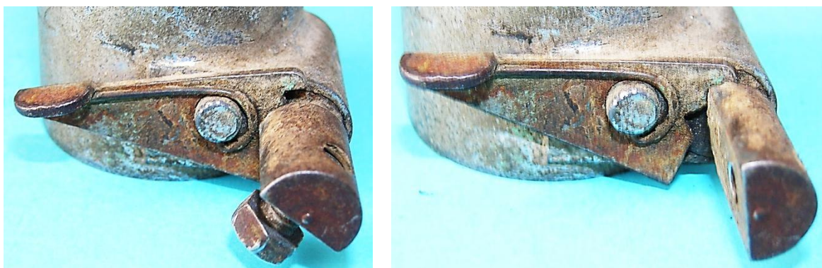
Bild 2.2: Kippvorrichtung: a) Betriebsstellung, b) Ruhestellung
