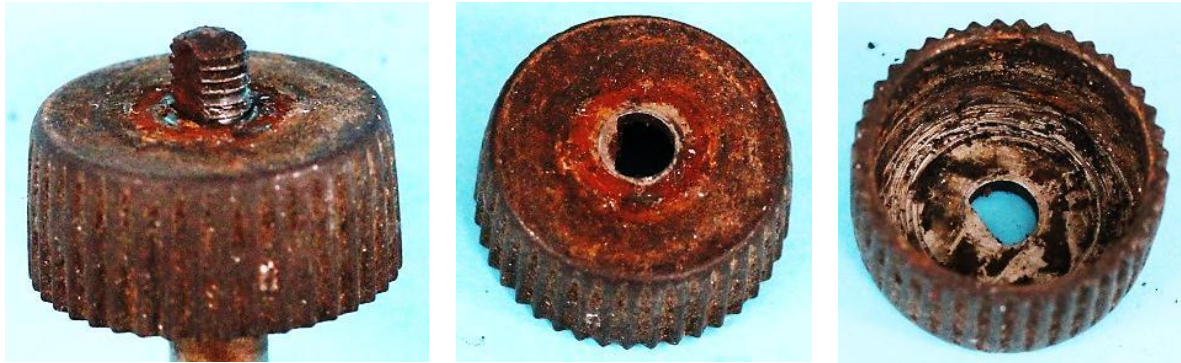
Bild 2.3: Reibrad: a) Aufgestecktes Reibrad, b) Gesehnte Wellendurchführung, c) Innenraum des Reibrades
