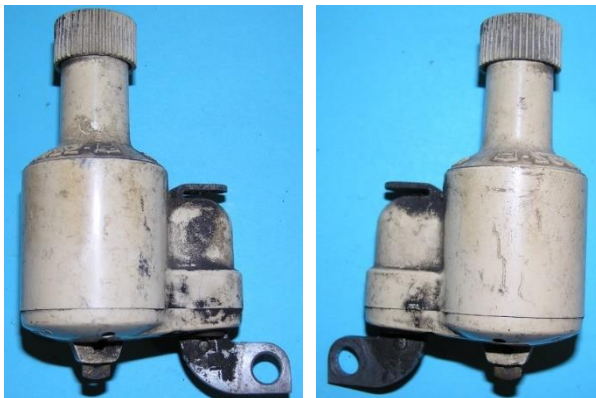
Bild 1.17: Soubitez 12-D; CH. 4.1. 1.013, Gehäusemodifikation nur für die Schweiz
