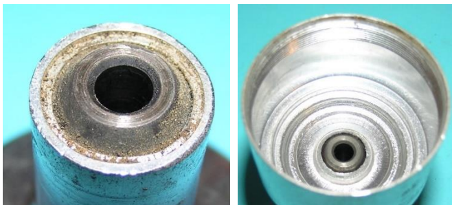
Bild 4.23: Einteiliges, nahtloses Lagerrohr: 35 mm lang, Wandstärke 3 mm
