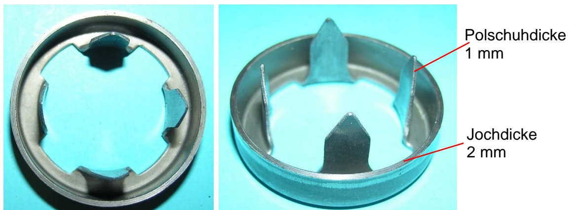
Bild 4.20: Klauenpolring mit unterschiedlichen Blechdicken in den Polschuhen (1 mm) und im Joch (2 mm)
