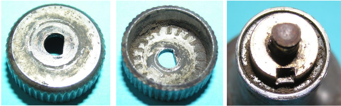
Bild 3.36: Reibrad: a) Flache Oberfläche mit gesehnter Wellenbohrung, b) Glockenförmige Gestaltung des Reibrades, c) Lippe der Kugellagerbahn im Eingriff mit der genuteten Mutter
