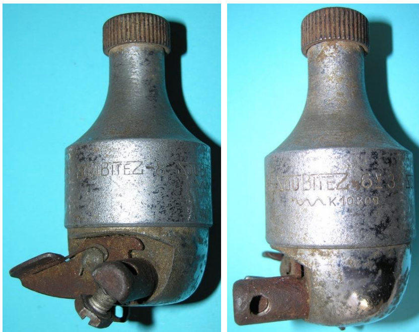
Bild 4.1: Soubitez 8 mit einem Zinkdruckgussgehäuse, Gewicht 293 g, K-10809
