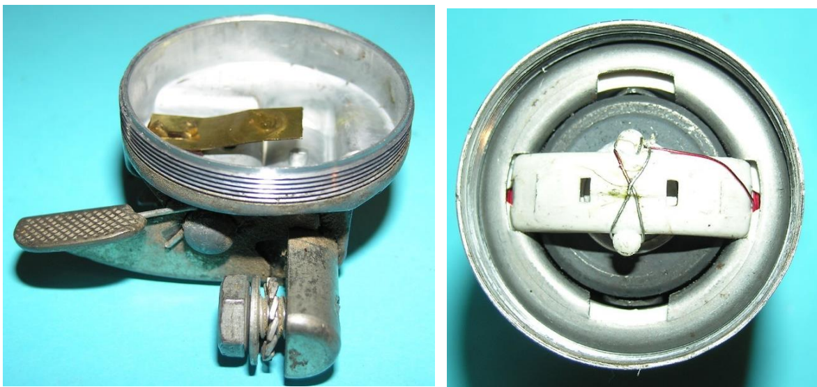
Bild 4.16: Elemente im elektrischen Stromkreis: a) Federndes Kontaktblech, b) Blankes Spulenende am Kontaktsteg festgelegt
