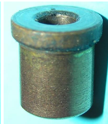
Bild 5.42: Ahtpoliger Walzenmagnet: Durchmesser: 27,8 mm, Axiale Länge: 18 mm
