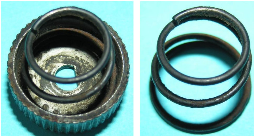
Bild 3.37: Position der Schraubenfeder in der Reibradglocke
