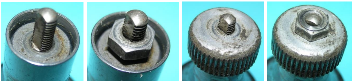
Bild 3.13: Montage des Reibrades
