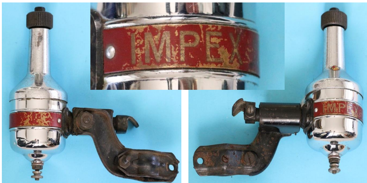
Bild 3.13: Zweipoliger Impex-Dynamo mit Blätterpolanker
