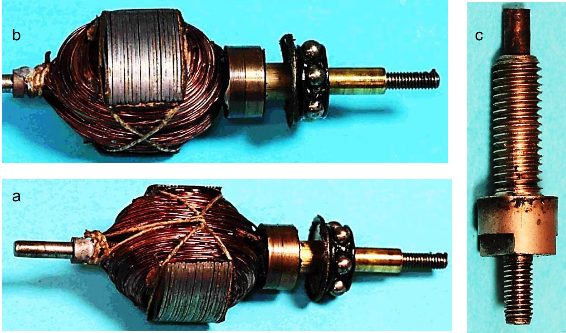
Bild 5.6: Anker: a) Polfläche des Blechpakets, b) Getränkte und abgebundene Wicklung, c) Kombination aus Bürstenhalter und Kabelanschlussbolzen
