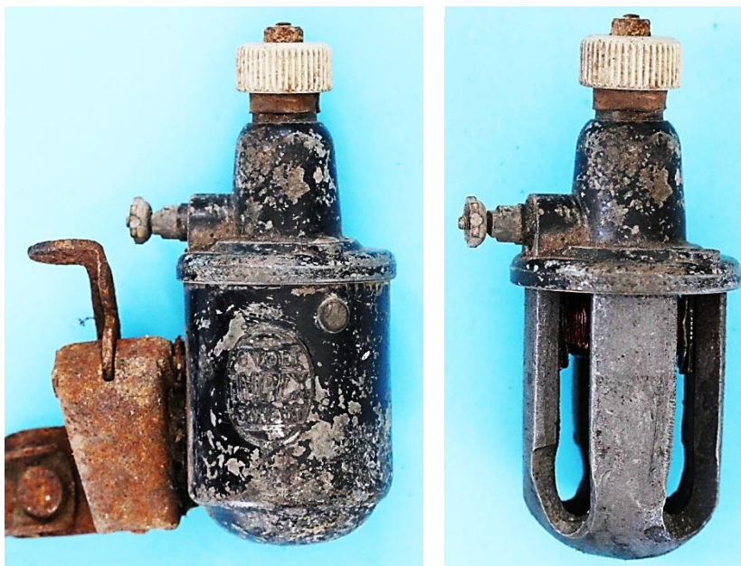
Bild 1.8: Impex-Kippvorrichtung am vierpoligen Dynamo
