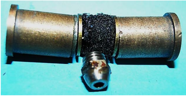
Bild 8.14: Öldepot: a) Öldepot zwischen den Gleitlagern, b) Tragrolle mit Ölfilz
