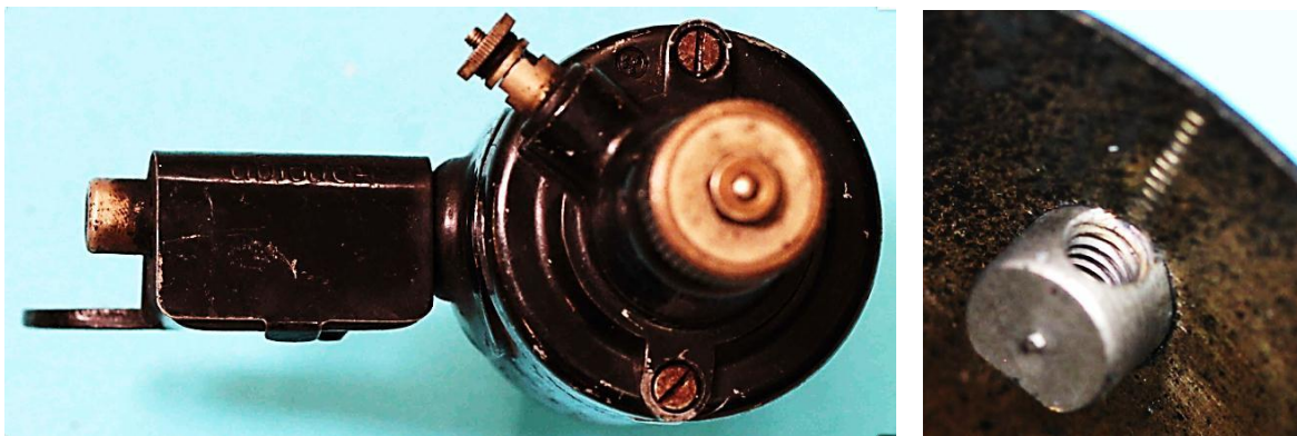
Bild 5.5: Impex LM 32: a) Schraubenköpfe im Lagerhalsfuß, b) Gewindeloch im von außen eingesetzten Zapfen
