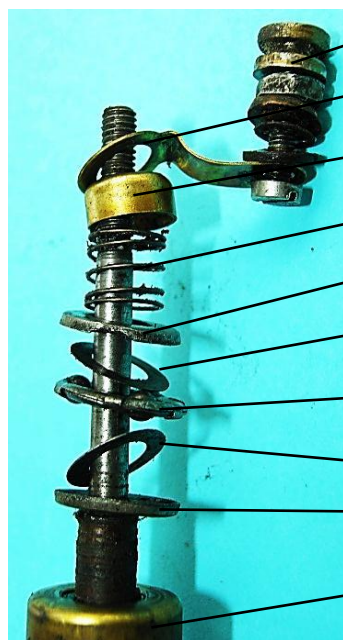
Bild 11.9: Spannung führender Kontakt: a) Anker mit den Spannung führenden Bauteilen auf der Welle, b) Einzelteile des Stromkreises vom Anker bis zum Kabelanschlussbolzen
