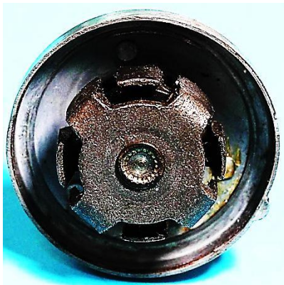
Bild 12.30: Baugruppen: a) Achtpoliges Klauenpolrad mit zweipoligem Magneten. b) Gehäusetopf mit der Kippvorrichtung
