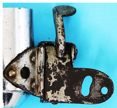
Bild 3.10: Halterarmvarianten zweipoliger Dynamos
