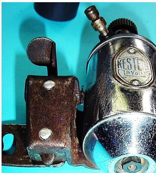
Bild 7.24: Sichtbares Stößelende unter der Kippvorrichtung
