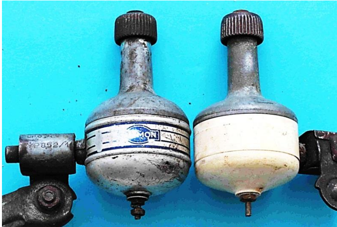
Bild 3.14: Aufnahme der Dynamo- produktion nach dem Krieg a) Typischer Daimler-Benz-Dynamo b) Impex-Kugeldynamo von 1955- 1962
