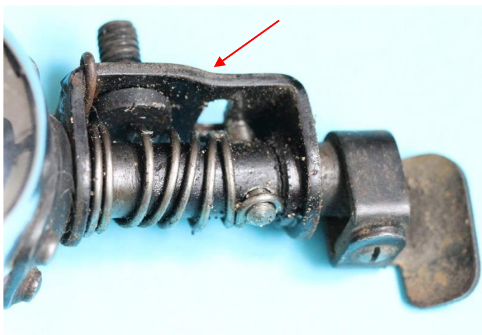
Bild 12.6: Halterbolzen: a) Position des Halterbolzens im Basisblech, b) Verdrehbarer Sitz des Halterbolzens
