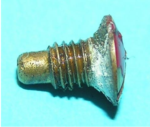
Bild 12.23: Spezialschraube zum Verschluss der Ölbohrung
