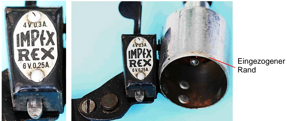
Bild 9.24: Leistungsschild mit den empfohlenen Lampenwiderständen von 13 Ohm und 24 Ohm
