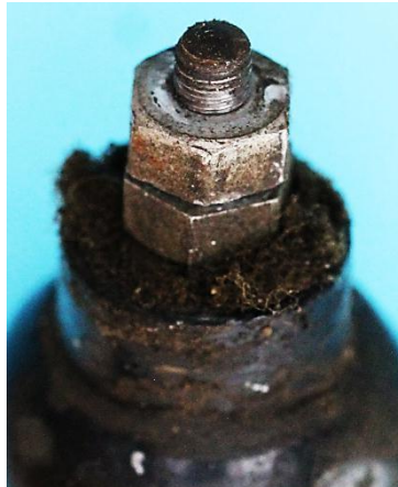
Bild 6.4: Reibrad mit Innensechskant zwischen zwei Muttern befestigt
