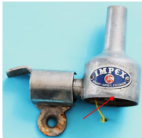
Bild 12.72: La- gerhalstropf mit eingezogenem unterem Rand
