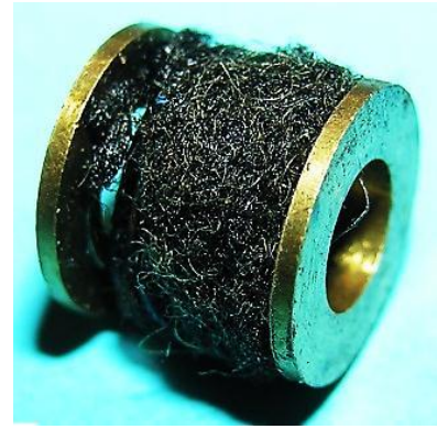
Bild 8.14: Öldepot: a) Öldepot zwischen den Gleitlagern, b) Tragrolle mit Ölfilz
