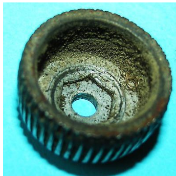
Bild 9.6: Reibrad als Kappe mit einem Innensechskant ausgeführt
