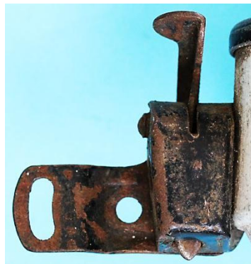
Bild 3.9: Flansch und Halterarm des vierpoligen Dynamos im Bild 3.8c
