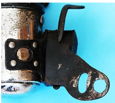
Bild 3.10: Halterarmvarianten zweipoliger Dynamos
