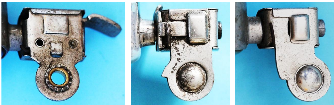
Bild 12.47: Halterarmrückseiten der Impex-Kugeldynamos
