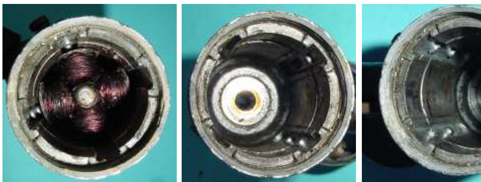
Bild 1.19: Funktionen des Gehäuses: a) Position des Läufers im Gehäuse, b) Gleitlager im unteren Bereich des Lagerhalses, c) Innere Nietköpfe zur Befestigung des Drehbolzenflansches
