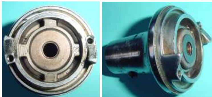
Bild 3.10: Lagerhals mit Gleitlager
