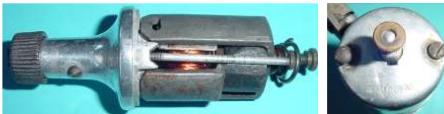
Bild 5.9: Befestigung der beiden Gehäuseteile mit zwei am Boden zugänglichen Gewindebolzen
