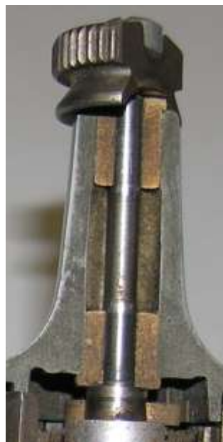
Bild 2.7: Freifliegende Lagerung des Ankers mit zwei Gleitlagern
