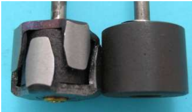
Bild 7.1: Achtpolige Polräder der Ausführungen RL/WR1/1 und RL/WR1/Bxx
