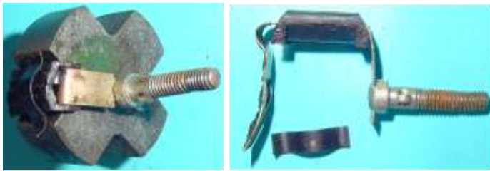
Bild 1.15: Blattfeder vom Schleifkontakt zum Kontaktbolzen
