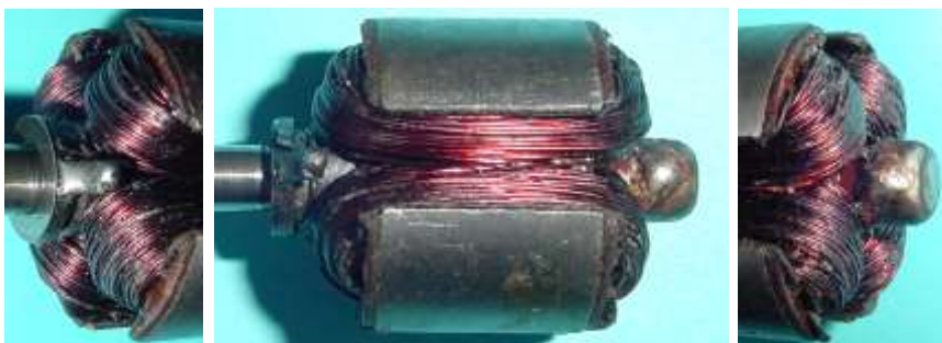
Bild 1.17: Kontaktierung der Spulenden an der Welle und an der isoliert angebrachten Kappe
