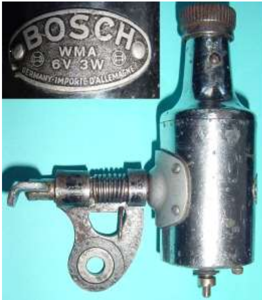
Bild 3.1: Ausführung WMA mit Kippvorrichtung
