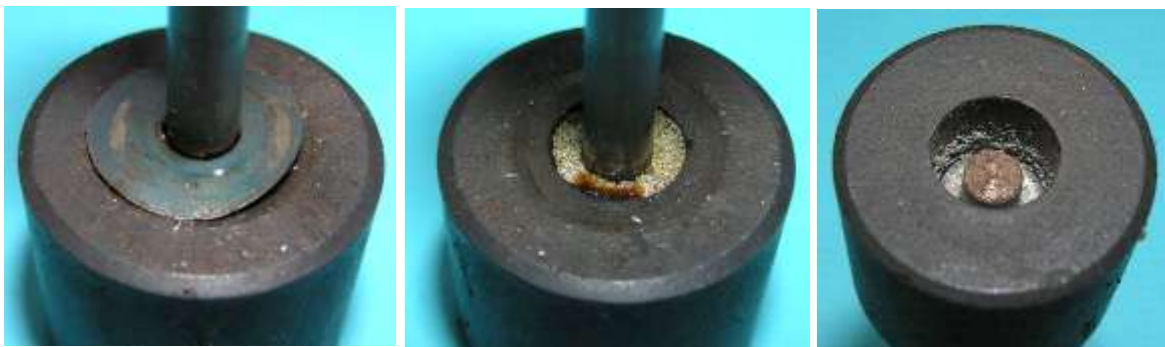
Bild 7.2: Befestigung der Welle in der zentralen Bohrung des Magnetkörpers
