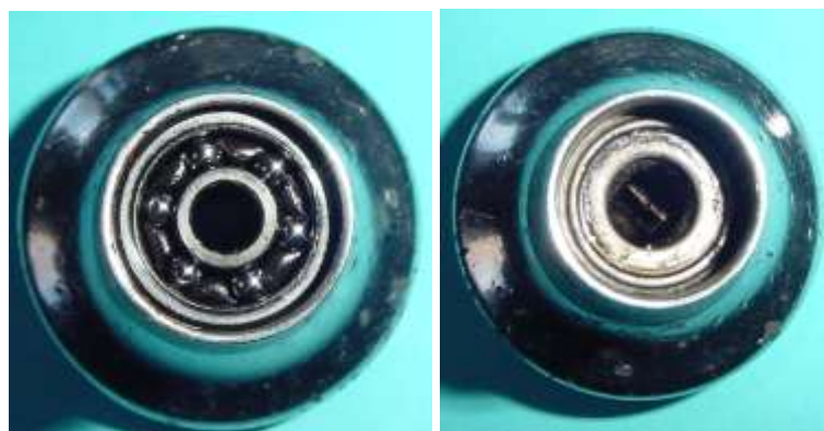
Bild 3.11: Kugellager, Kugellagersitz und Massekontakt
