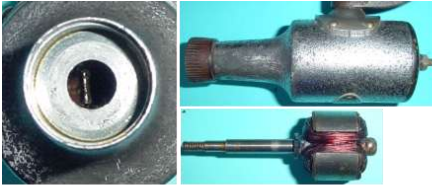
Bild 1.18: Blattfeder im Lagerhals zur elektrischen Überbrückung der Lager
