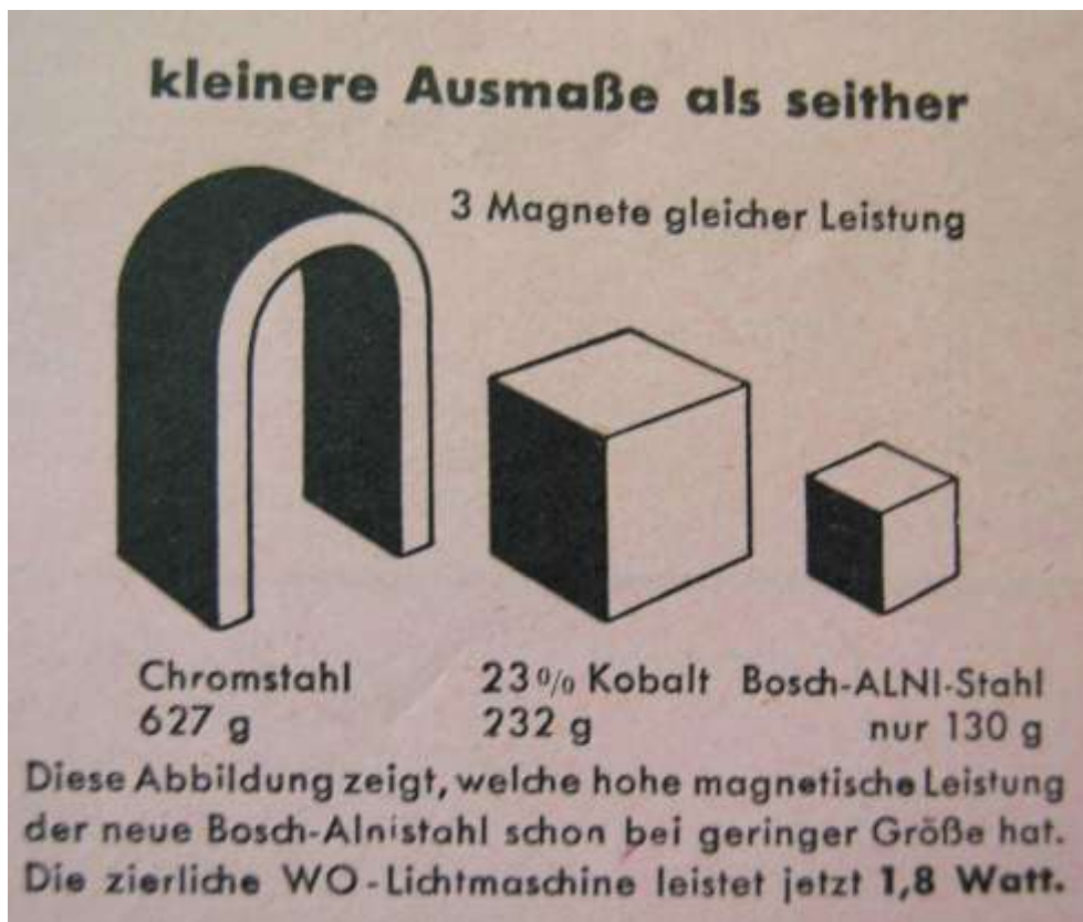
Bild 1.3: Verringerung der Magnetabmessungen durch Zusätze von Kobalt oder Nickel
