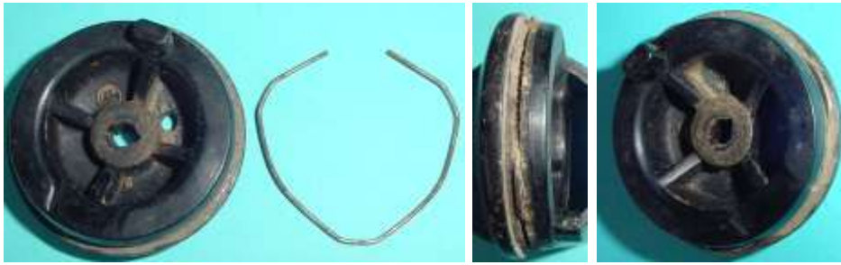
Bild 1.12: Drahtfeder zum Einklinken des Bodens in den Gehäusemantel
