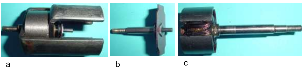
Bild 3.7: Erregersystem mit Kontaktbolzen und Anker
