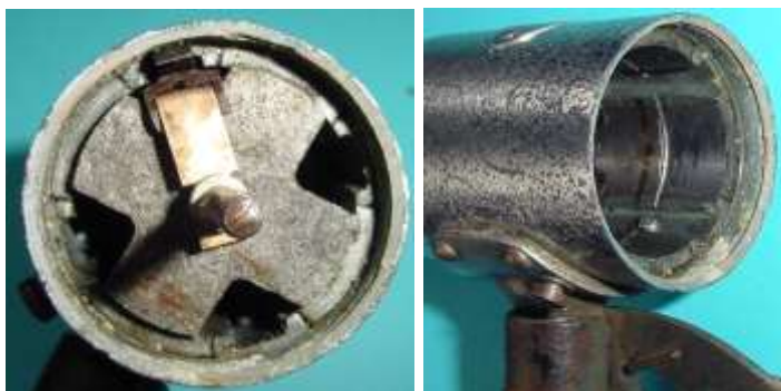
Bild 1.13: Entfernung des Bodens und des Sternmagneten
