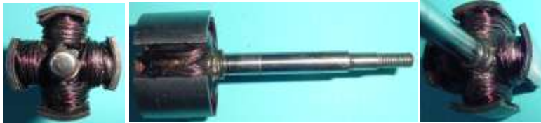
Bild 3.8: Stirnseiten des Ankers und Anker mit Welle
