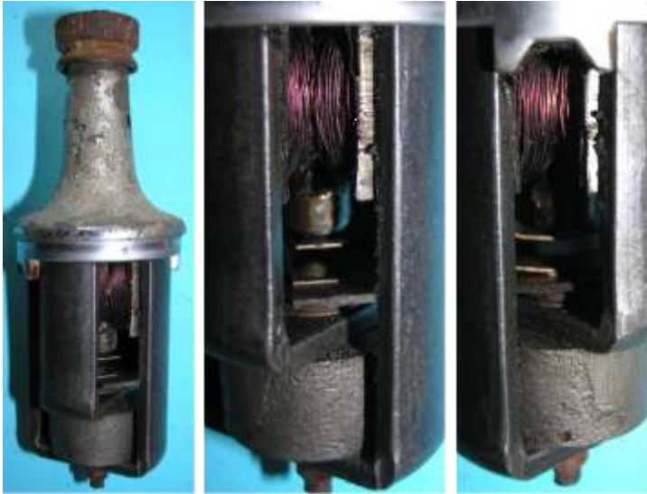
Bild 2.3: Blick durch die Pollücken auf den Anker und die Kontaktfeder
