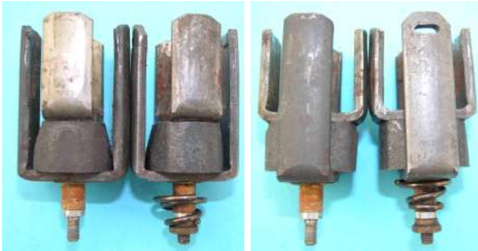
Bild 4.6: Ausführungsbeispiele mit flussoptimierter Magnetkontur
