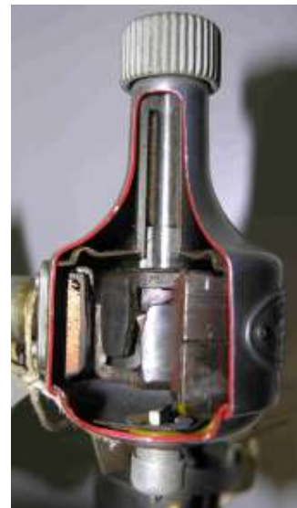
Bild 6.3: Dynamo mit Klauenpolrad: a) Schnittzeichnung (aus der Bosch-Werbung), b) Schnittmodell (Bosch-Archiv)
