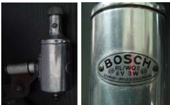
Bild 5.4: RL/WQ2 mit blankem Gehäusetopf, (RL/WQ1 hat einen schwarzen Gehäusetopf)
