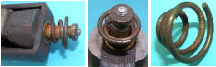
Bild 5.11: Druckfeder zwischen Gehäuse und Magnetsystem
