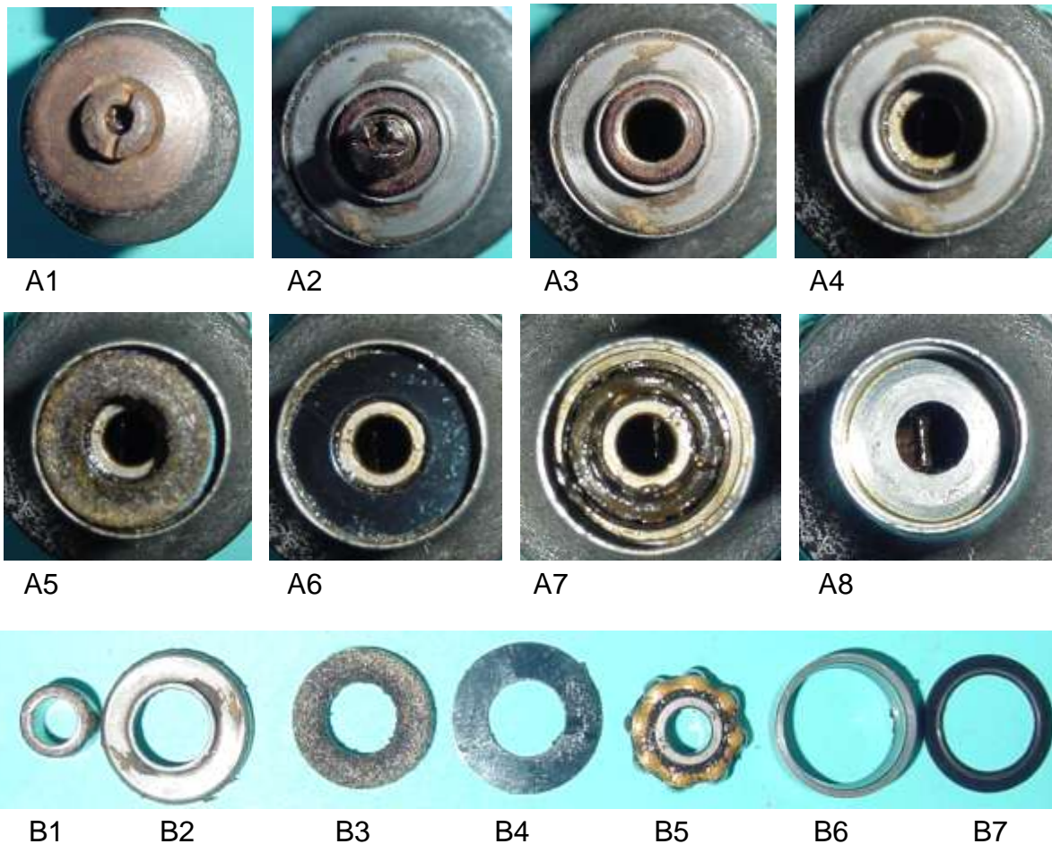
Bild 1.20: Einzelteile des Kugellagers im oberen Teil des Lagerhalses
