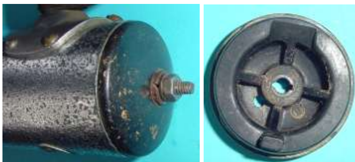
Bild 1.11: Gehäuseboden aus Kunststoff
