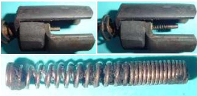
Bild 5.13: Erregersystem, Kontaktbolzen, Kontaktfeder und Druckfeder
