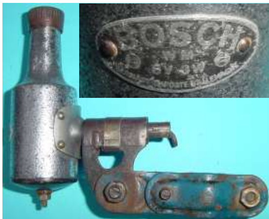
Bild 1.10: Bosch WM mit Kippvorrichtung und Halter
