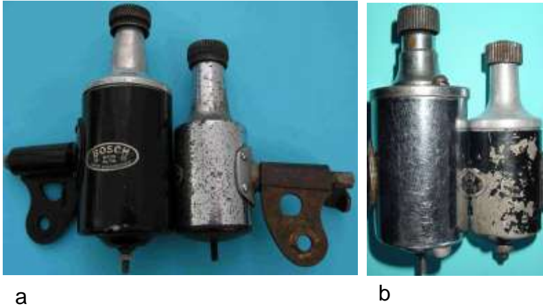
Bild 1.6: Gegenüberstellung der Stabmagnet- mit den Weicheisenstabmagnet-Dynamos: a) WGDC und WM, b) WH und WQ
