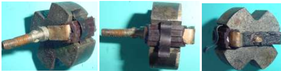
Bild 1.16: Magnet mit Kontaktfeder, Kontaktbolzen und Feststellfeder (Feststellfeder ist um 90° gedreht)
