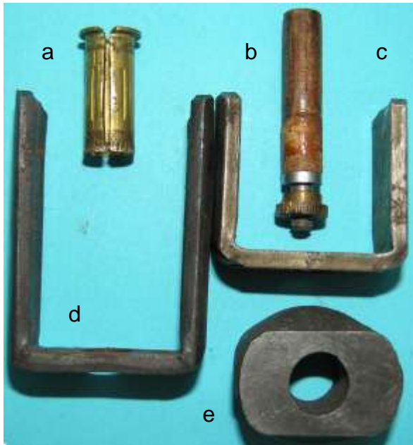
Bild 1.8: Bauteile des Erregersystems der Stimmgabel-Dynamos
