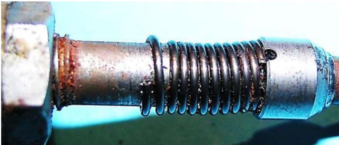
Bild 10: Welle mit unvollständiger Axialspielausgleichsfeder
