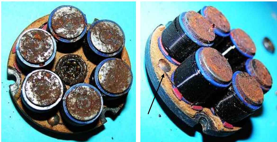
Bild 6: Sechspoliger Anker: a) Kreisförmige Anordnung der Spulen mit einem Schulterkugellager im Zentrum, b) Masseanschluss
