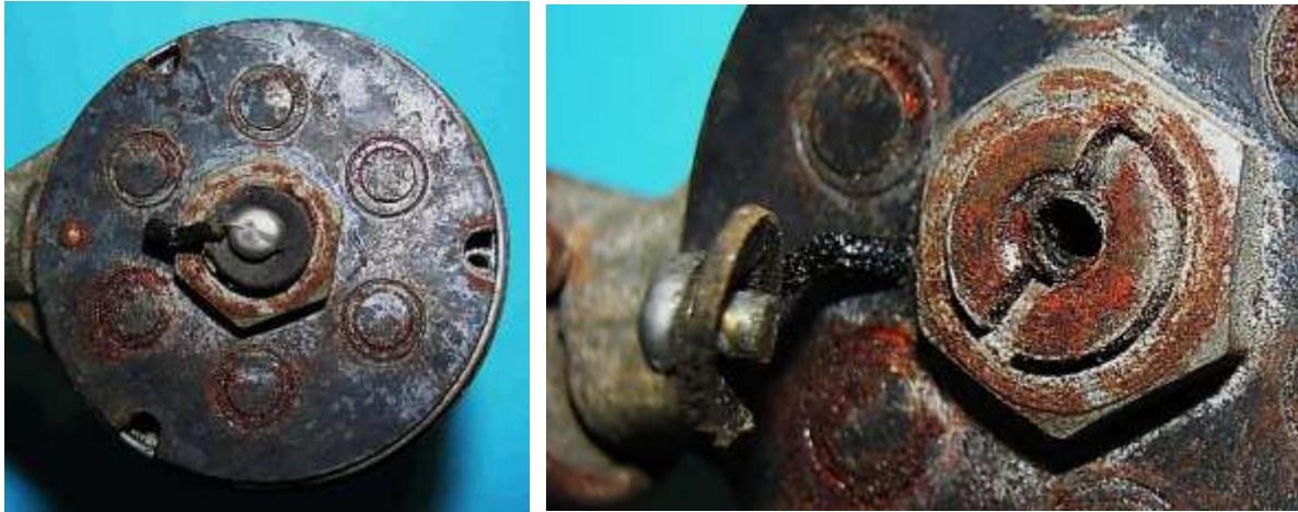
Bild 5: Grundplatte des Ankereisens: a) Sechs Eisenkerneinsätze und Kontaktpunkt, b) Anschluss des Spulenendes am Kontaktpunkt
