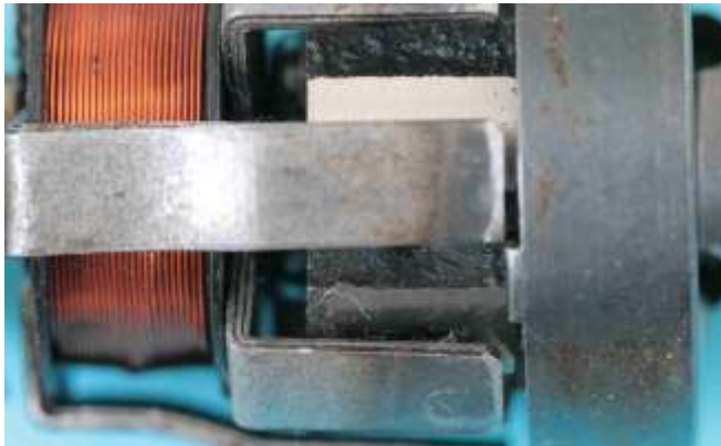
Bild 1.13: Arretierung des Konusrings an den Klauenpolen
