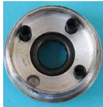
Bild 1.7: Lagerschild: a) Lagerschild mit Druckring, b) Druckring mit zwei Positionierungsstiften, c) Innenseite des Lagerschilds mit vier Grundlöchern für Schraubenfedern
