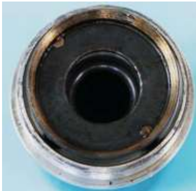
Bild 1.7: Lagerschild: a) Lagerschild mit Druckring, b) Druckring mit zwei Positionierungsstiften, c) Innenseite des Lagerschilds mit vier Grundlöchern für Schraubenfedern
