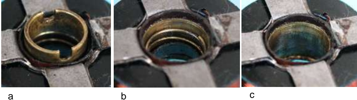
Bild 1.19: Schleifkontakt: a) Ring mit Ausnehmungen für den Kontaktstift in der Achse, b) Bürste (Schleiffeder) im Schleifring, c) Schleifring in der Isolierhülse
