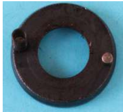
Bild 1.7: Lagerschild: a) Lagerschild mit Druckring, b) Druckring mit zwei Positionierungsstiften, c) Innenseite des Lagerschilds mit vier Grundlöchern für Schraubenfedern
