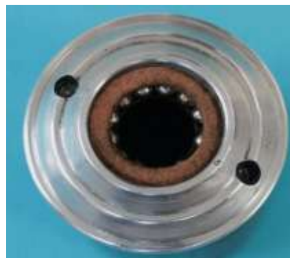
Bild 1.5: Lagerschilde mit Grundlöchern für einen Stirnlochschlüssel: a) Entfernter Konus auf der Achse, b) Achse entfernt
