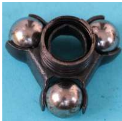
Bild 1.8: Getriebestufen: a) Zwei Ebenen der Planetenkugeln, b) Planetenkugeln und Planetenträger der ersten Stufe
