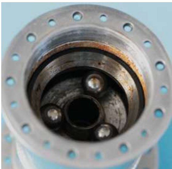
Bild 1.10: Doppelkonus mit den Planeten der zweiten Getriebestufe
