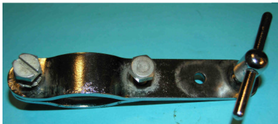
Bild 1.4: Halter mit Flügelschraube und zwei Bolzen zur Befestigung der kurzen Klemmschelle: a) Lange Klemmschelle b) Seitenansicht des Halters
