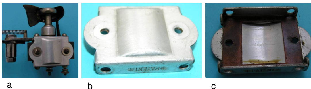
Bild 1.19: Unteres Buckelblech: a) Angeschraubtes Buckelblech, b) Ansicht von unten, c) Innenseite mit Dichtungsmaske
