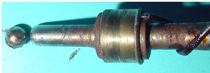
Bild 4.35: Kugel des Spurlagers mit dem Wellenende
