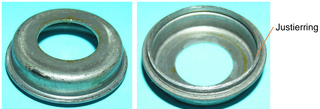
Bild 7.36: Justierringeinsatz mit einem Bohrungsdurchmesser größer als das Außenmaß des Kugellagers
