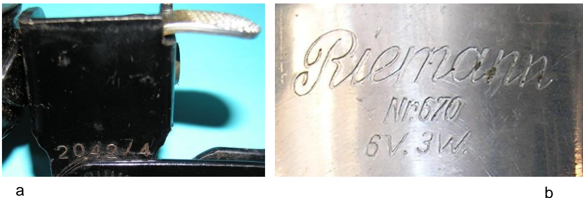
Bild 7.25: Beschriftung: a) Fertigungsnummer auf der Rückseite der Kippvorrichtung b) Firmen- und Typenschild auf dem Gehäusemantel
