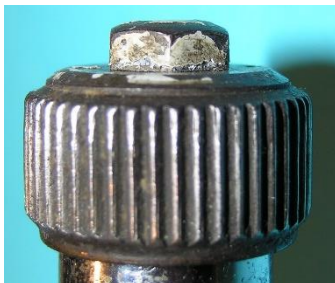
Bild 5.34: Anpassung des Reibrades an den Lagerhals: a) Reibrad mit aufgesetzter Kontermutter, b) Lagerhals mit Gleitlager und
