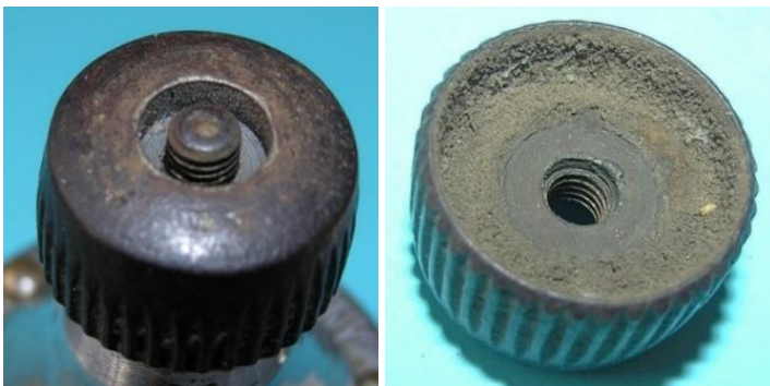
Bild 4.20: Reibrad mit Ausnehmungen für eine Schlitzmutter und für den Staubschutz
