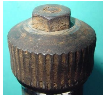
Bild 5.12: Spannung führende Bürste mit dem Kabelanschluss und der Bakelitgewindekappe
