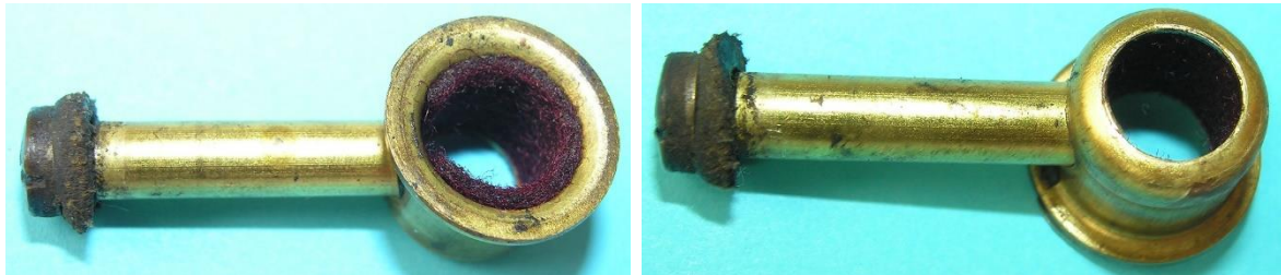
Bild 4.39: Verschließbarer Ölkanal mit Öldepot
