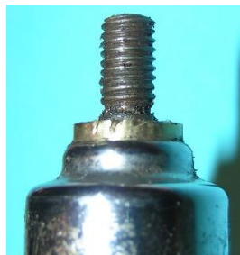
Bild 5.34: Anpassung des Reibrades an den Lagerhals: a) Reibrad mit aufgesetzter Kontermutter, b) Lagerhals mit Gleitlager und
