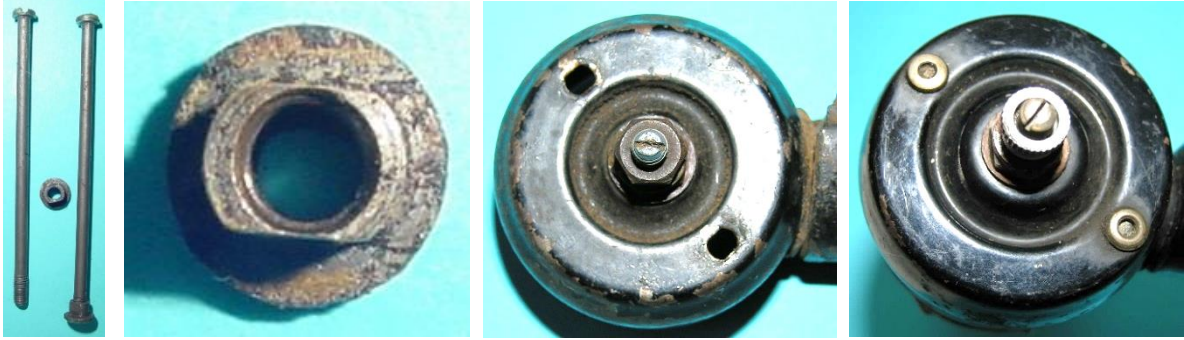
Bild 6.57: Spannbolzen mit verdrehsicheren Muttern
