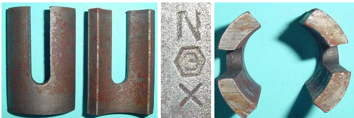
Bild 6.56: Polpaarsegmente, 7 mm dick und 60 mm lang, mit den Initialen der Firmenvereinigung „Deutsche Stahlwerke“
