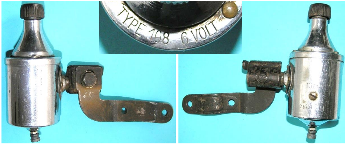
Bild 4.10: Riemann Type 108, 6 V, keine Leistungsangabe
