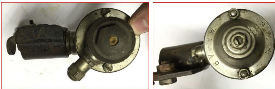
Bild 3.5: Ansichten: a) Reibrad und Lagerhalsfuß. b) Beschriftung des Bodens mit den Nenndaten 8 V und 4 W sowie mit der Typenbezeichnung Nr. 107 R
