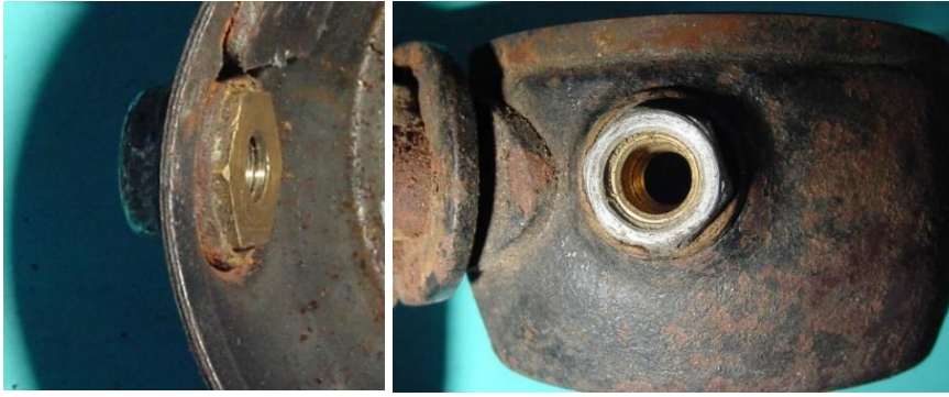
Bild 6.42: Gegen den Bodenrand isolierte Gewindebuchse
