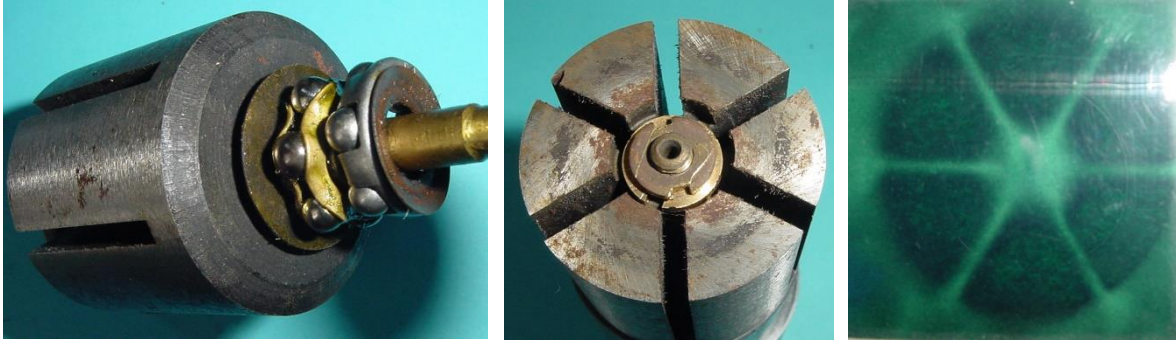
Bild 2.25: Einteiliges Magnetsystem mit sechs Polen, Komponenten des Materials: Fe = 93.27 %, W = 6.31 %, Cr = 0.42 %
