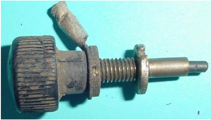
Bild 5.12: Spannung führende Bürste mit dem Kabelanschluss und der Bakelitgewindekappe
