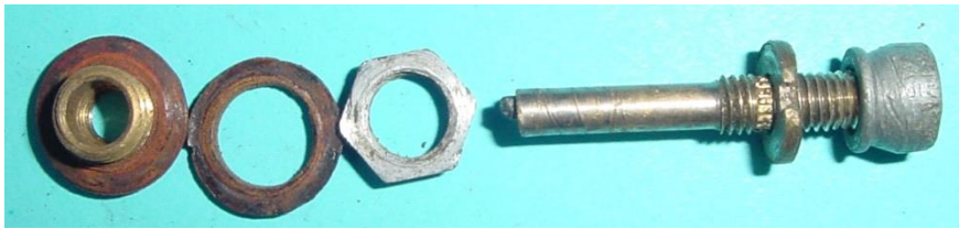
Bild 6.43: Isolierte Gewindebuchse und Bürstenhalter mit Kabelanschluss
