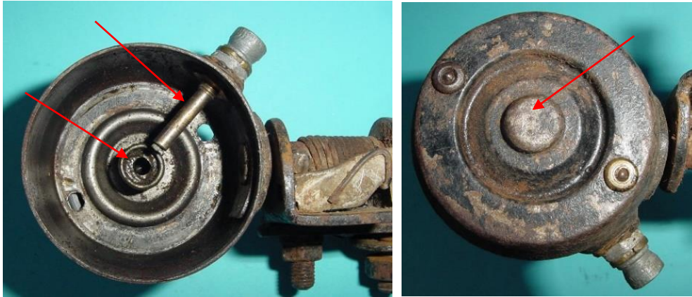
Bild 6.40: Boden: a) Topfboden mit Spurlager und mit Spannung führender Bürste, b) Ausbuchtung für das Spurlager
