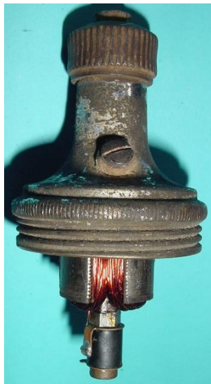
Bild 5.12: Spannung führende Bürste mit dem Kabelanschluss und der Bakelitgewindekappe
