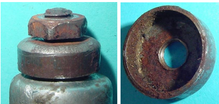
Bild 6.37: Gewindekappe zum Schutz des Lagers
