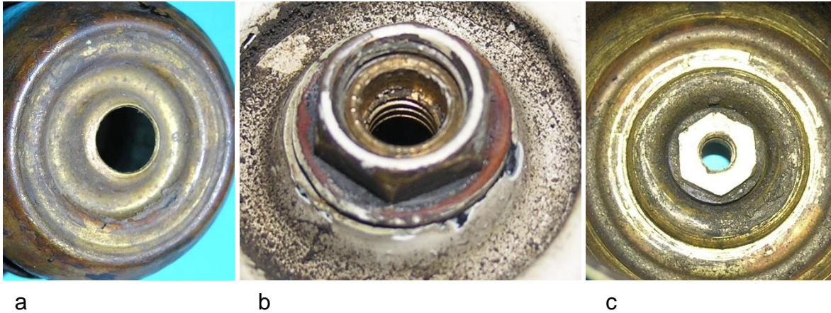
Bild 5.28: Gewindeeinsatz für den Kabelanschlussbolzen: a) Bohrung im Gehäusetopf, b) Mutter außerhalb des Gehäuses, c) Sechskant innerhalb des Gehäuses
