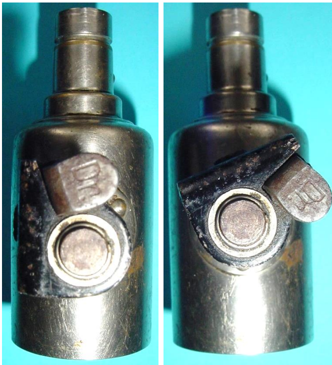
Bild 2.22: Ruhe- und Betriebsstellung der Kippvorrichtung
