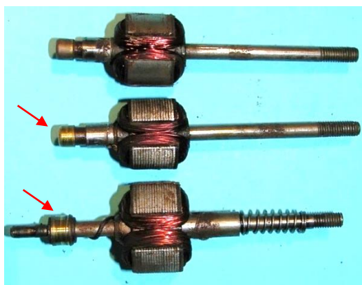
Bild 6.3: Einfluss der ein und zweiseitige Läuferlagerung auf die Schleifkontakte
