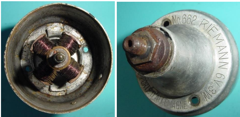
Bild 6.41: Positionen der Lager: a) Kugel in der Stirnseite der Welle für das Spurlager, b) Kugellager unter dem Reibrad
