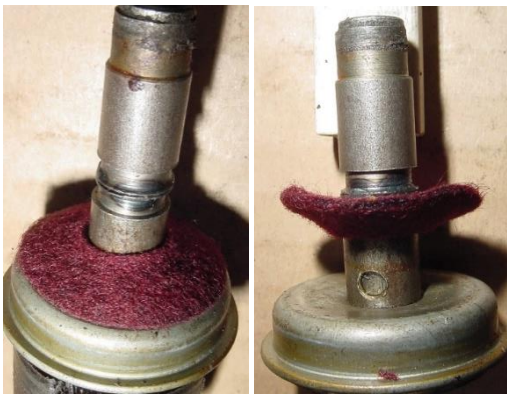
Bild 7.23: Gleitlager mit Öldepot
