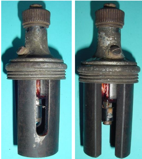
Bild 5.10: Unterschiede der Pollücken im Magnetsystem
