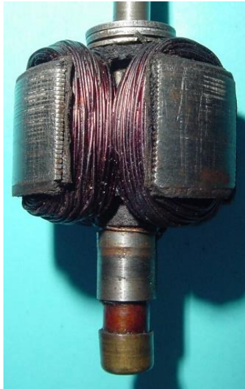
Bild 6.54: Schleifkontakte und ihre Wicklungsanschlüsse
