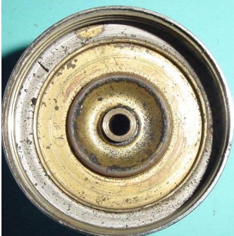
Bild 5.17: Unteres Lagerschild im Lagerhals
