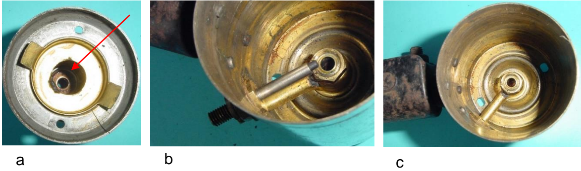
Bild 4.36: Innenräume des Gehäuses: a) Lagerhalsfuß mit der Positioniernut für die zwei Polpaarsegmente, b) Bodentopf mit Bürstenhalter und Ölrohr, c) Ölrohr für das Gleitlager bei entferntem Bürstenhalter
