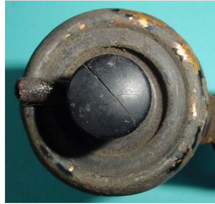
Bild 5.12: Spannung führende Bürste mit dem Kabelanschluss und der Bakelitgewindekappe
