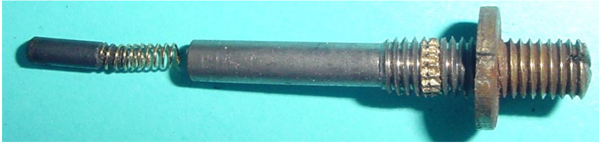
Bild 4.41: Bürstenhalter, Kohlebürste und Bürstenfeder
