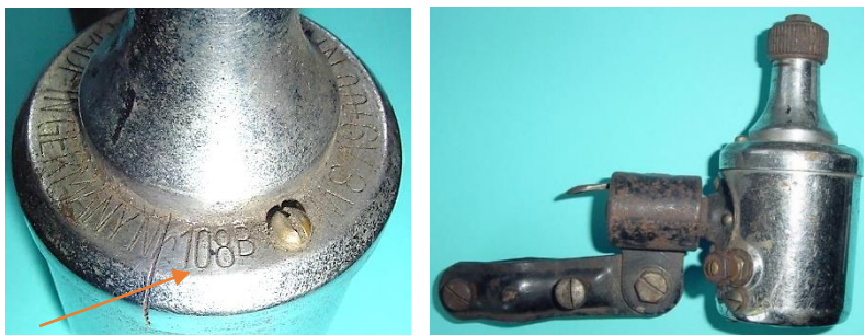
Bild 4.12: Riemann Typ 108 B, Beschriftung mit der Typenbezeichnung und den Nenndaten
