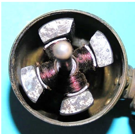
Bild 4.7: 3 mm Luftspalt zwischen dem Gehäusemantel und den Polpaarsegmenten
