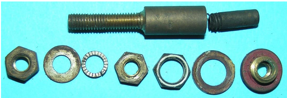
Bild 5.30: Bestückung des Kabelanschlussbolzens mit Scheiben und Muttern
