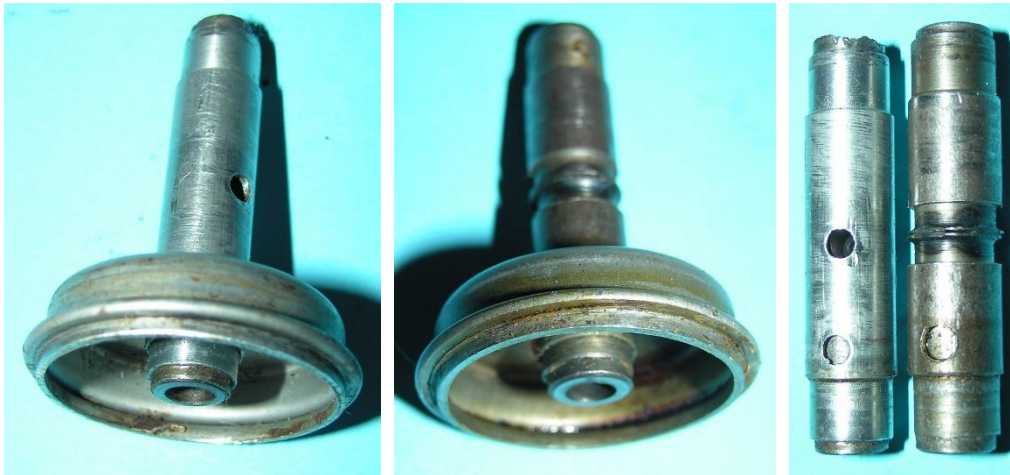
Bild 7.20: Gleitlagervarianten mit Lagerschale: a) Einteiliges Gleitlager, b) Zweiteiliges Gleitlager, c) Zwei Gleitlagerausführungen
