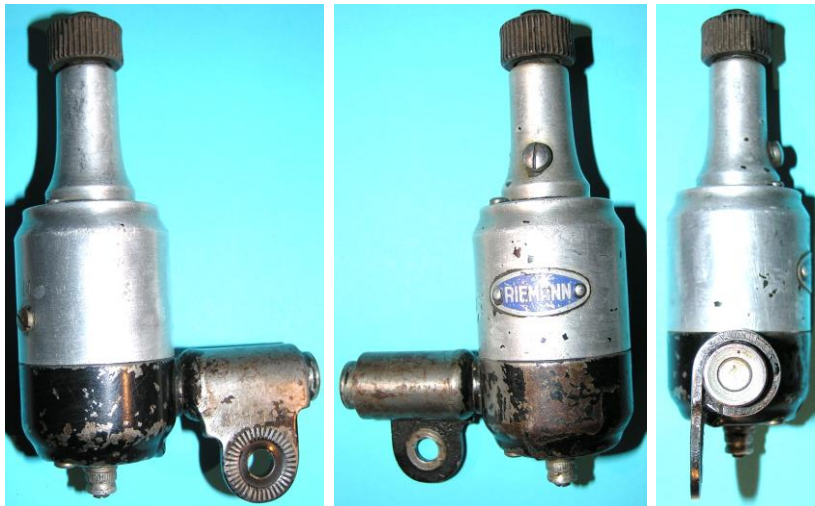
Bild 6.10: Riemann 650: Durchmesser 43,5 mm, Länge 122 mm
