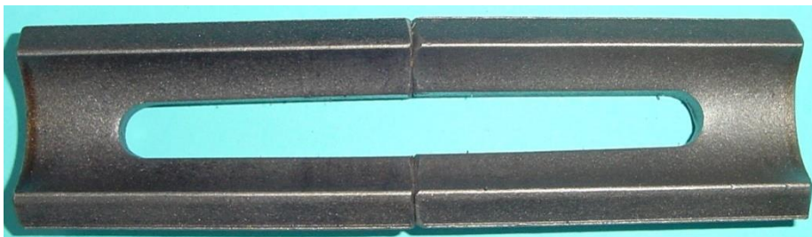
Bild 6.31: Demonstration eines Arbeitsschritts bei der Herstellung der Polpaarsegmente
