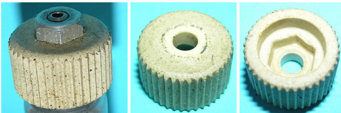
Bild 7.38: Zwischen zwei Muttern fixiertes Specksteinreibrad
