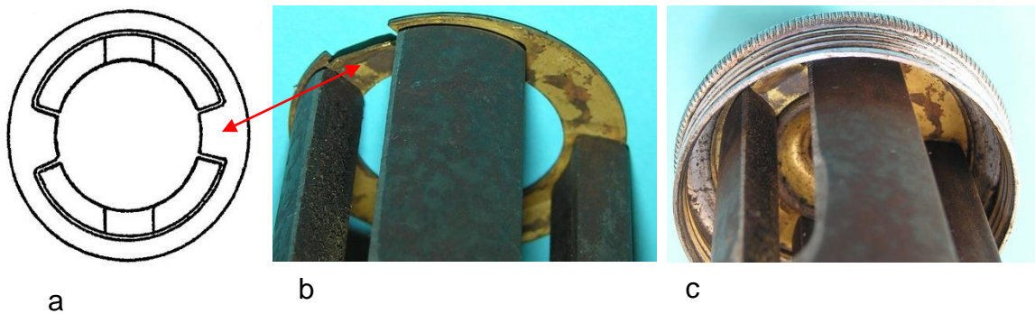
Bild 5.6: Positionen des Magneten und des Distanzrings im Lagerhalsfuß: a) Zeichnung im Patent / 12/, b) Ausgeklinte Blechzunge zwischen den Schenkeln eines Polpaars, c) Lage des Magneten im Lagerhalsfuß
