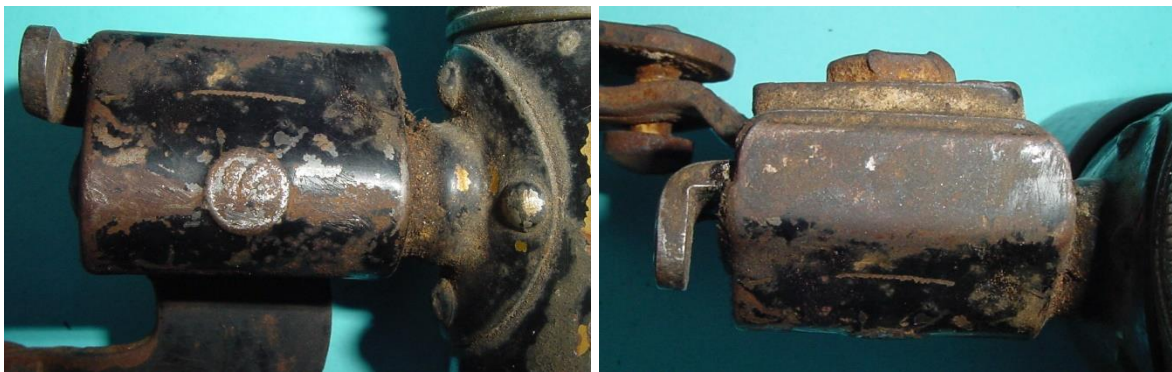
Bild 5.8: Zwei Ansichten der Kippvorrichtung
