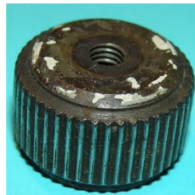
Bild 5.34: Anpassung des Reibrades an den Lagerhals: a) Reibrad mit aufgesetzter Kontermutter, b) Lagerhals mit Gleitlager und
