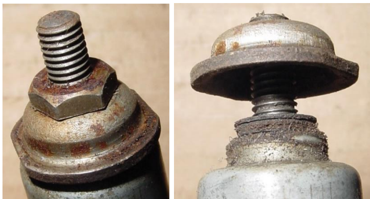
Bild 7.21: Gewindeteller zur Abdeckung des Lagers mit Kontermutter
