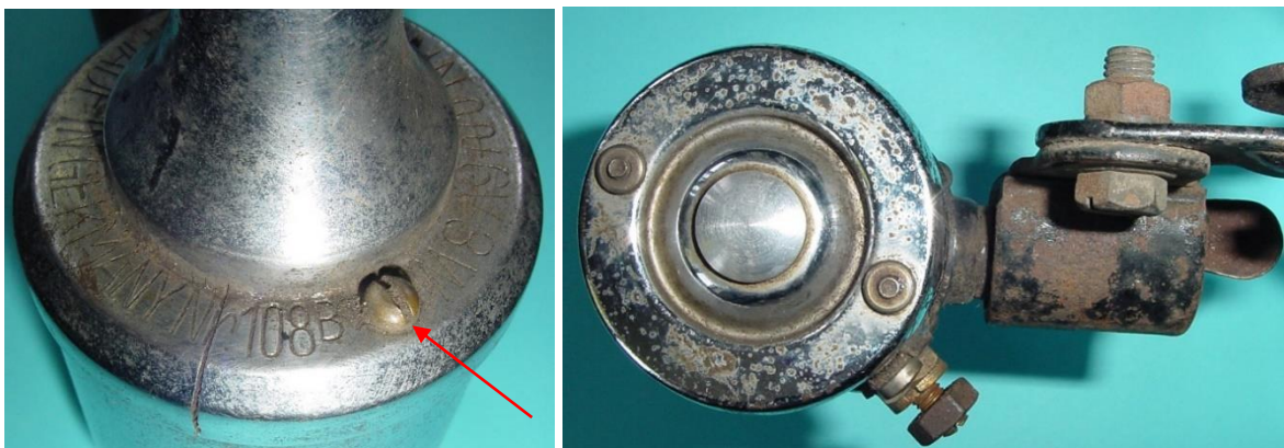
Bild 4.31: Zwei Spannbolzen verbinden den Lagerhalsfuß mit dem Boden
