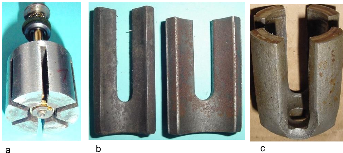
Bild 7.1: Magnetsysteme in den Riemann-Dynamos: a) Rotierendes Polrad, b) Polpaarsegmente unterschiedlicher Längen und Krümmungen, c) Vierpoliger Tulpenmagnet
