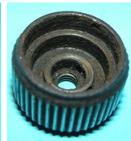
Bild 5.34: Anpassung des Reibrades an den Lagerhals: a) Reibrad mit aufgesetzter Kontermutter, b) Lagerhals mit Gleitlager und
