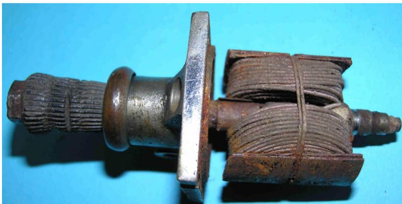
Bild 1.24: Läufer mit Lagerhals
