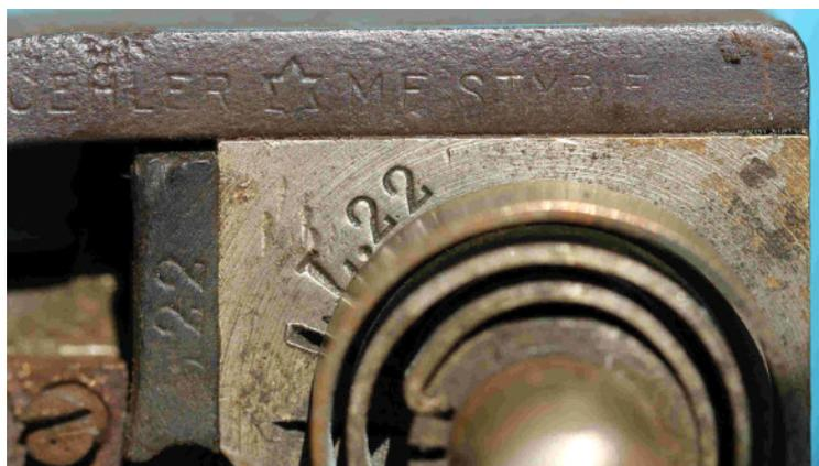
Bild 2.4: Nuten zur Verstellung der Federkraft,
