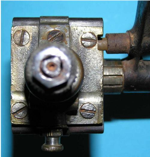
Bild 1.18: Befestigung des Lagerhalses an den Polschuhen mit vier Schrauben
