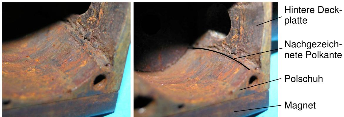
Bild 1.23: Gekrümmte Polschuhkanten
