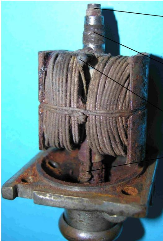
Spannung führender Schleifkontakt
