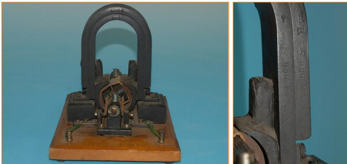
Bild 1.8: Tischgenerator mit Böhler-Magneten
