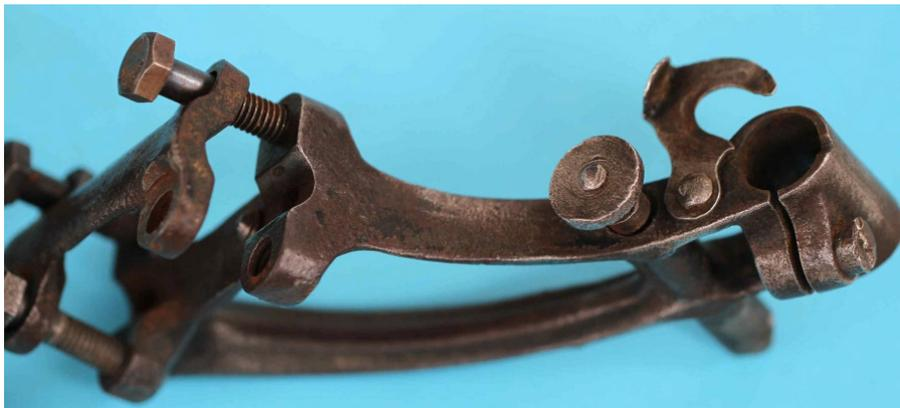
Bild 2.6: Halter mit Sperrstift und Sicherungsschuh
