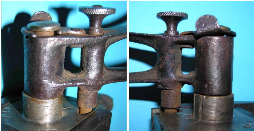
Bild 1.32: Sperrstift, Drehbolzen und Sicherungsschuh
