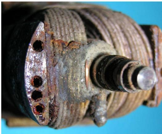
Bild 1.26: Ausgewuchteter Anker V98
