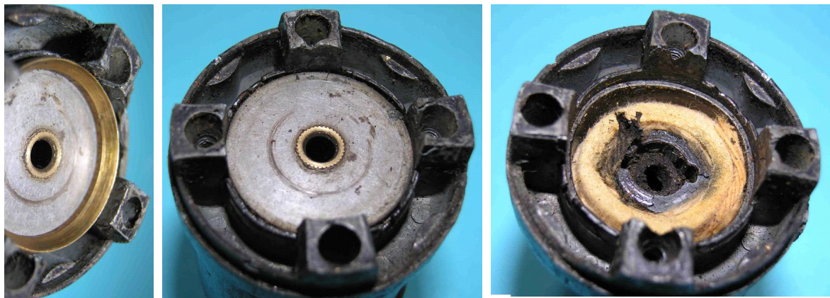
Bild 1.11: Lagerschild: a) Messingring zur Befestigung des Lagerschilds, b) Position des Lagerschilds im Lagerhalsfuß, c) Öldepot oberhalb des Lagerschilds
