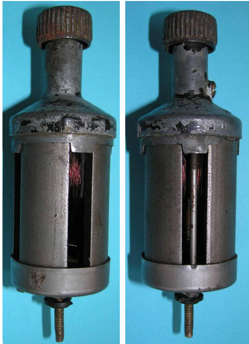
Bild 1.2: Magnetsystem und Lagerhals a) Pollücke ohne Gewindebolzen, b) Pollücke mit Gewindebolzen
