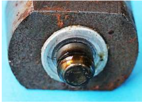
Bild 2.15: Mit Kunststoff eingegossenen Welle: a) Obere Ansicht, b) Untere Ansicht; Abmessungen des Magneten: 29 mm x 22 mm x 16 mm
