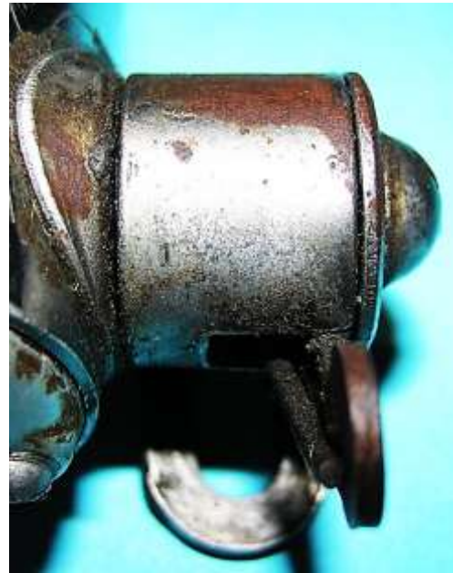
Bild 1.15: Seitenansichten der Kippvorrichtungen der Dynamos von Bild 1.1a und Bild 1.1b
