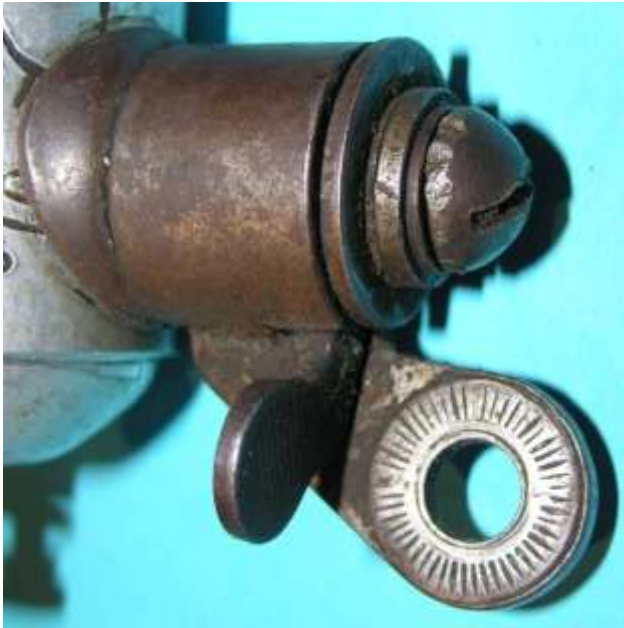
Bild 1.15: Seitenansichten der Kippvorrichtungen der Dynamos von Bild 1.1a und Bild 1.1b
