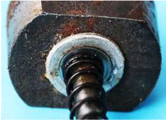
Bild 2.15: Mit Kunststoff eingegossenen Welle: a) Obere Ansicht, b) Untere Ansicht; Abmessungen des Magneten: 29 mm x 22 mm x 16 mm
