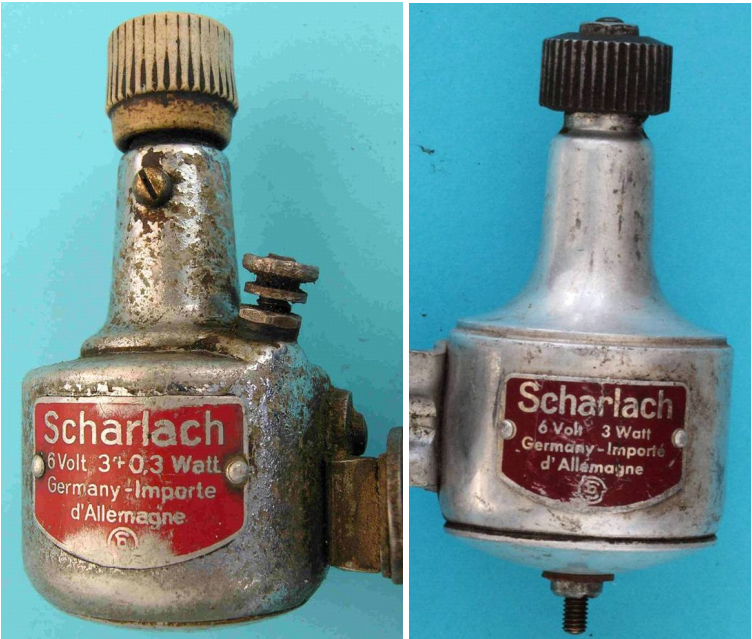
Bild 2.11 Zwei aufeinander folgende Dynamoausführungen: a) Fertigungsnummer 967008 b) Fertigungsperiode 91/3
