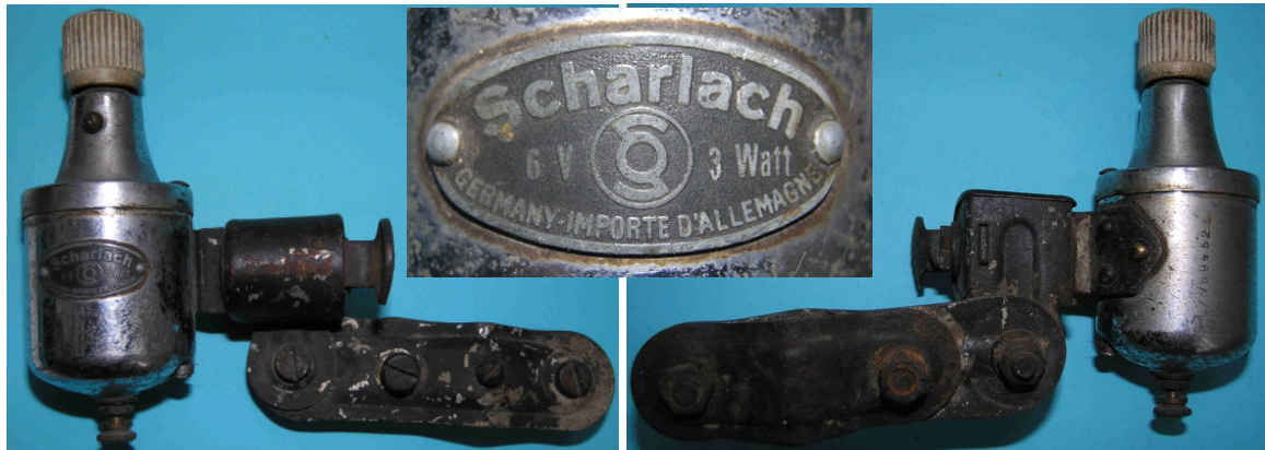
Bild 1.1: Vierpoliger Dynamo mit zweipoligem Dauermagneten der Firma „Otto Scharlach“ aus Nürnberg, Nr 769452
