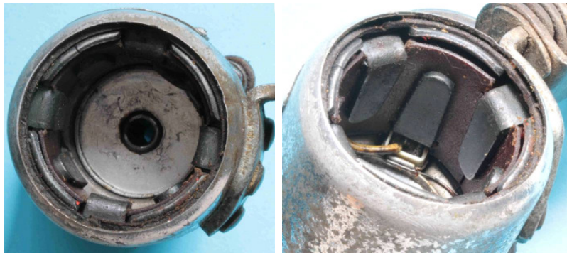
Bild 2.6: Klauenpolanker: a) Vollständiges Polsystem, b) Wechselseitig umgebogene Pole
