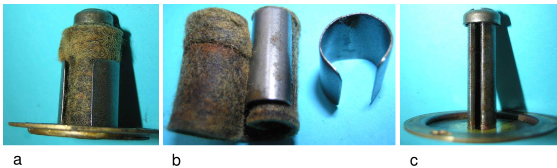
Bild 1.16: Gleitlager: a) Grundplatte mit Öldepot, b) Ölfilz mit zwei Blechmanschetten, c) An beiden Enden stabilisierte geschlitzte Lagerhülse
