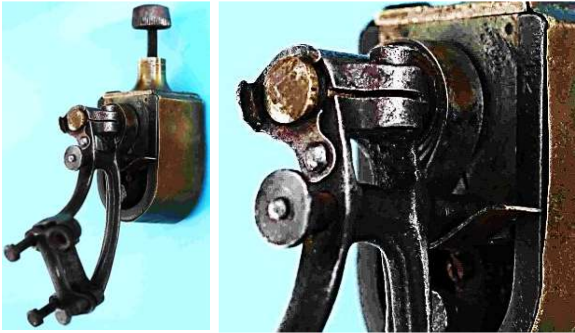
Bild 9.13: Eolo-Dynamo mit Zugstift und Spiralfeder
