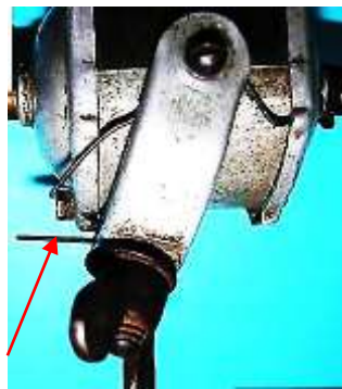
Bild 9.10: Sperrblechfeder am Voltalitedynamo: a) Befestigung des Sperrblechfeder an der Gabel, b) Betriebsstellung, c) Ruhestellung
