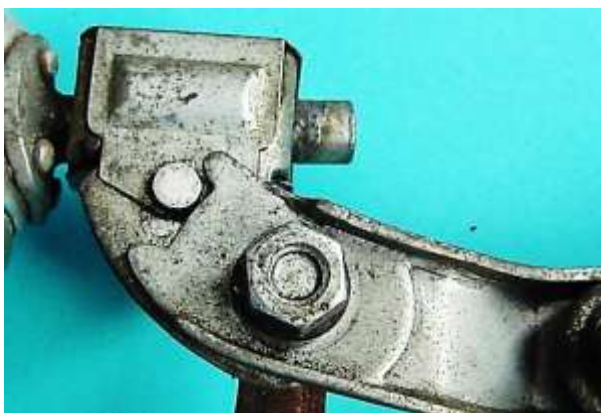
Bild 8.2: Ausbildung des Halterendes zu einer Gabel, um bei lockerer Schraubverbindung die Verdrehung des Dynamokörpers zu begrenzen
