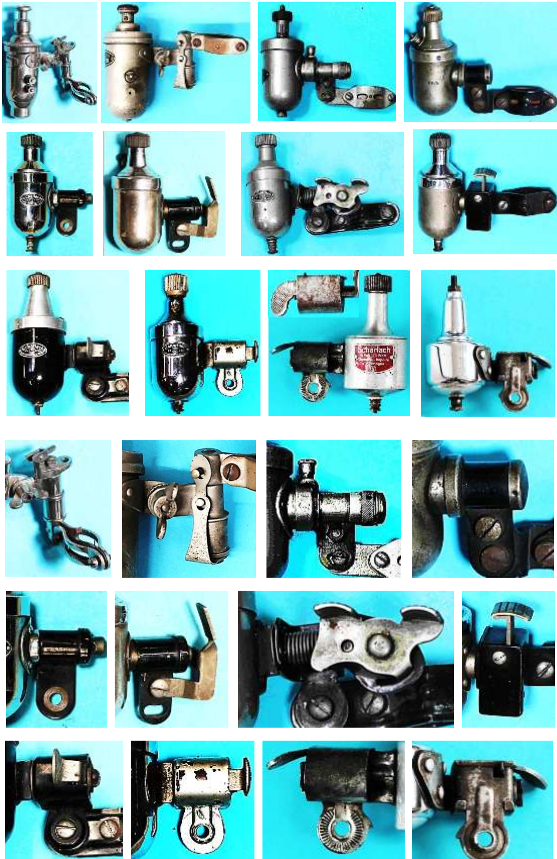
Bild 4.14: Kippvorrichtungen der Scharlach-Dynamos
