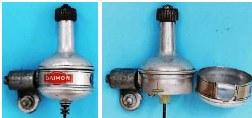
Bild 3.6: Zweiteiliges Gehäuse aus Lagerhalstopf und Gehäusetopf entsprechend der Skizze im Bild 3.5d
