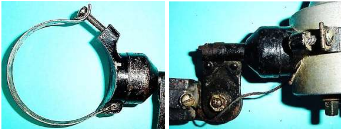
Bild 7.8: Spannbandbefestigung des Drehbolzens
