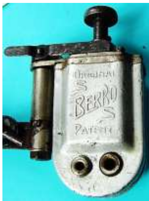
Bild 9.11: Blattfedersperre eines Dynamos mit einem Drehbolzen parallel zur Läuferdrehachse
