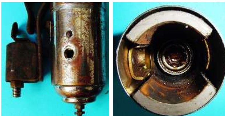
Bild 7.7: In der Pollücke hinterlegtes Blech mit Gewindebohrung
