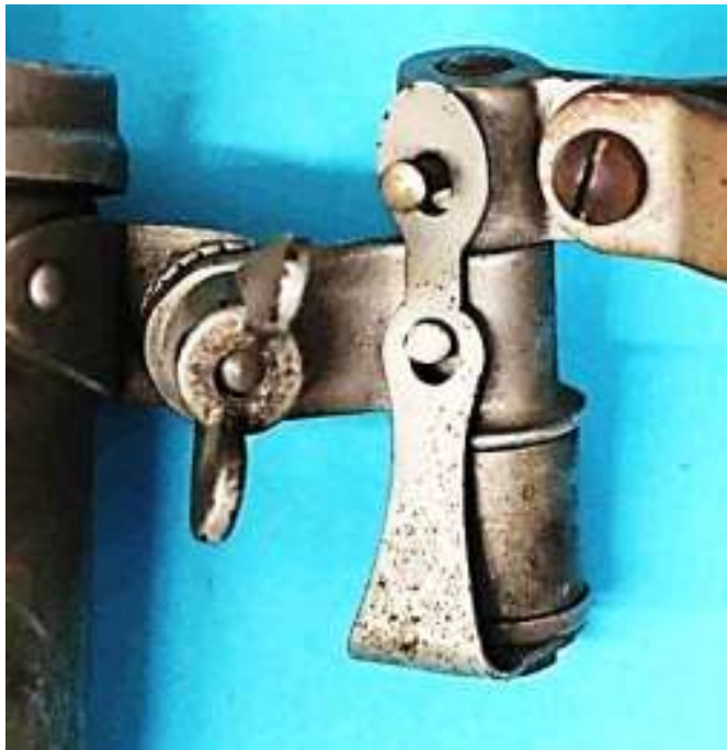
Bild 9.9: Dynamo mit Drehbewegung und Blattfederarretierung (Scharlach)
