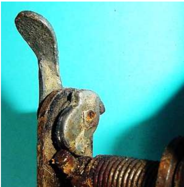
Bild 9.7: Sperrstift und Exzenter: a) Ruhestellung, b) Betriebsstellung
