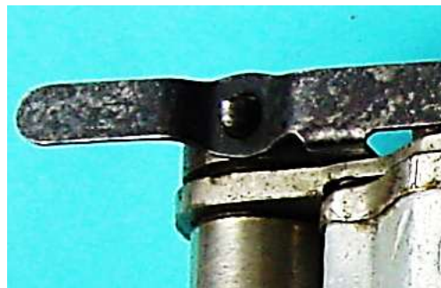
Bild 9.11: Blattfedersperre eines Dynamos mit einem Drehbolzen parallel zur Läuferdrehachse
