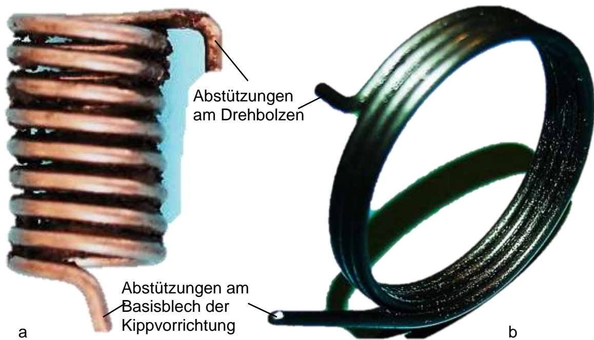
Bild 6.1: Typische Torsionsfedern: a) Schraubenfeder für axiale und tangentielle Kräfteausübung, b) Torsionsfeder
