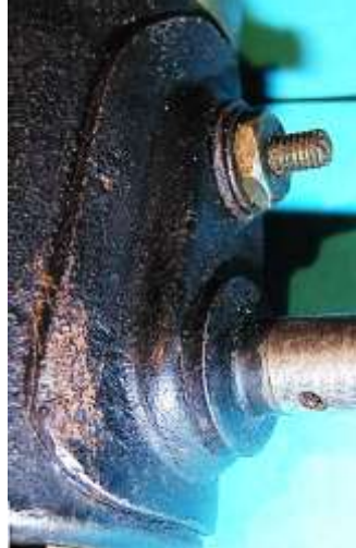
Bild 7.10: Drehbolzen mit einem Flansch am Gehäusemantel befestigt
