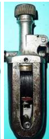
Bild 3.2: Magnet als Teil der Dynamokörperoberfläche
