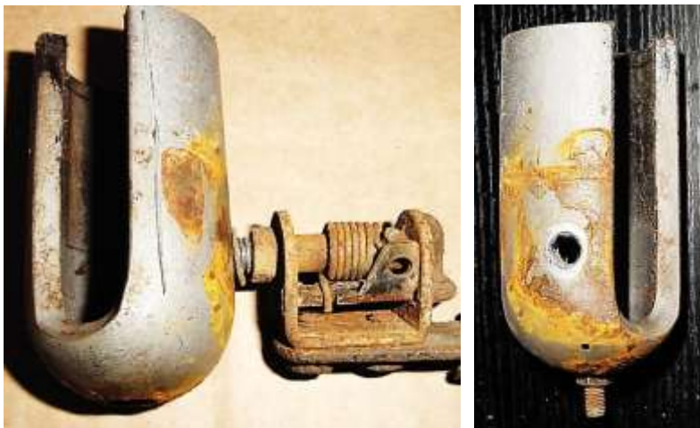
Bild 7.6: Gewindebohrung im Magnetschenkel
