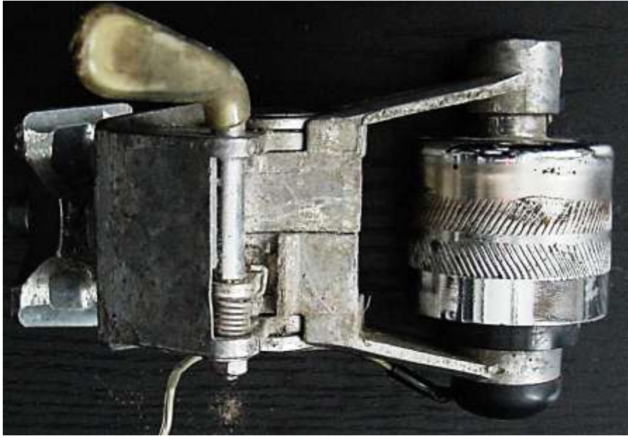
Bild 1.4: Walzendynamo mit der Kontaktfläche auf der Oberfläche des Polrades
