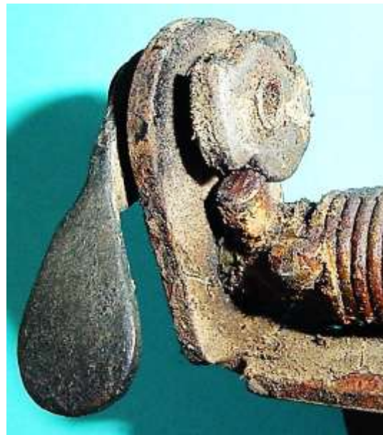
Bild 9.7: Sperrstift und Exzenter: a) Ruhestellung, b) Betriebsstellung
