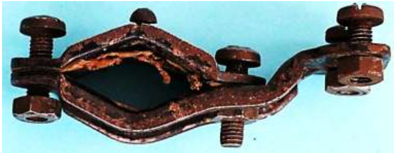
Bild 4.1: Unterlage zum Schutz des Lacks an der Vorderradgabel
