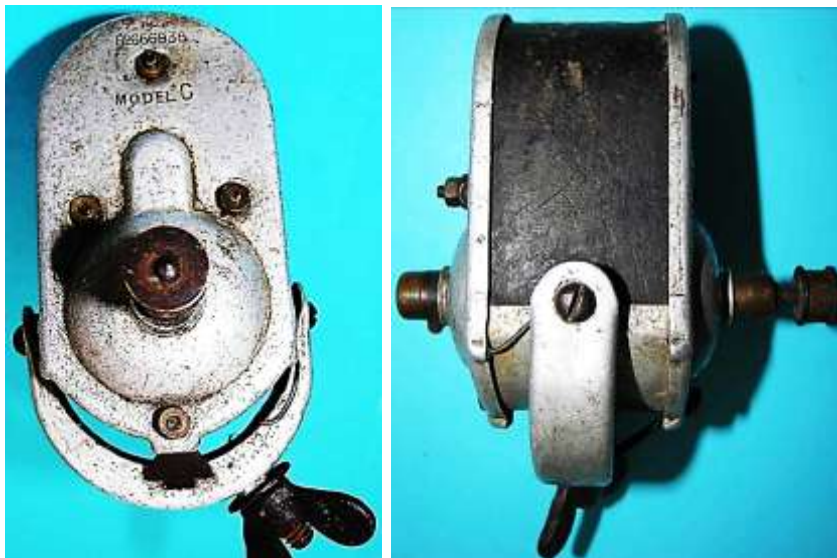
Bild 7.4: Geteilter Drehbolzen am Dynamokörper und eine Gabel am Halterende
