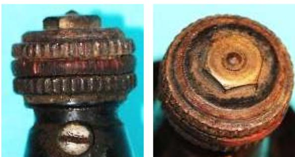
Bild 4.26: Reibrad mit Gummiring und aufgesetzter Kontermutter
