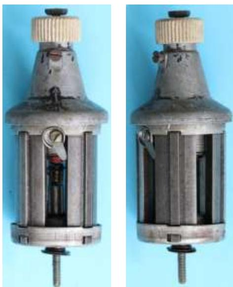
Bild 4.31: Magnetsystem der Sportvariante im Dynamo mit der Fertigungsnummer 1.533.977
