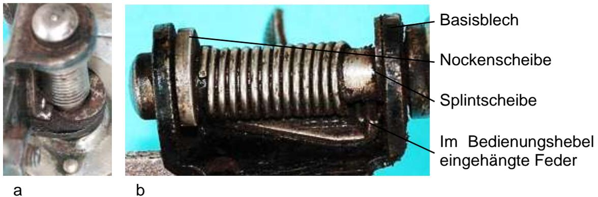
Bild 3.3: Kippvorrichtung mit Nockenscheibe
