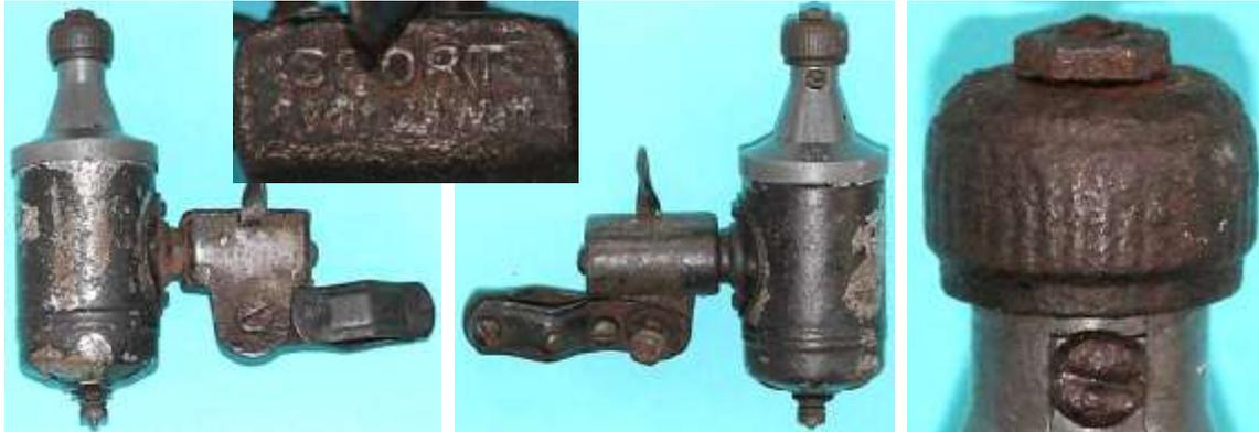
Bild 4.14: Häckel 334 296, SPORT, 2,1 W, Durchmesser des Reibrades 21 mm
