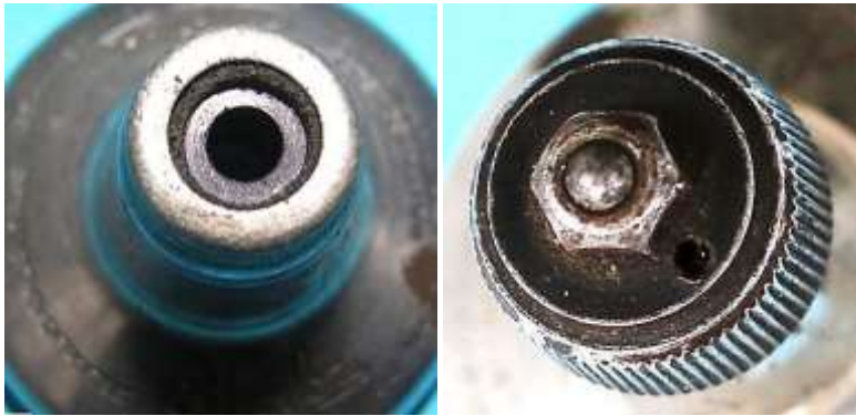
Bild 3.9: Schmiermittelversorgung des oberen Gleitlagers: a) Oberes Gleitlager, b) Ölbohrung im Reibrad
