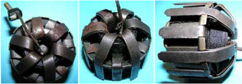
Bild 5.14: Klauenpolanker: a) Ansicht der Jochbereiche und der von der Ringspule aufgespannte Fläche, b) Verkettung der Polpaare mit der Ringspule, c) Gestaltung benachbarter Pole
