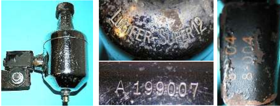
Bild 5.2: Beschriftungen auf dem Lagerhalsfuß, dem Gehäusemantel und der Abdeckung der Druckfeder
