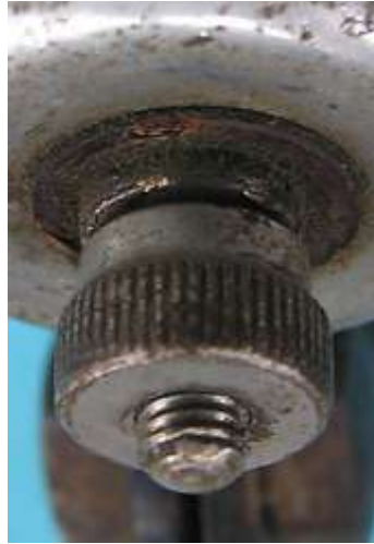
Bild 3.14: Kabelanschluss: a) Bohrung im Kabelbolzen, b) Festgeschraubte Über- wurfmutter
