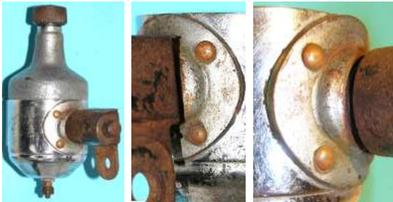
Bild 4.3: Runder Flansch mit vier Nieten am Gehäusemantel befestigt
