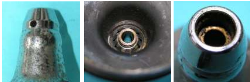
Bild 5.12: Einbau des oberen Kalottenlagers: a) Ölbohrung b) Kalottenbrille c) Kalotte unterhalb des Reibrades
