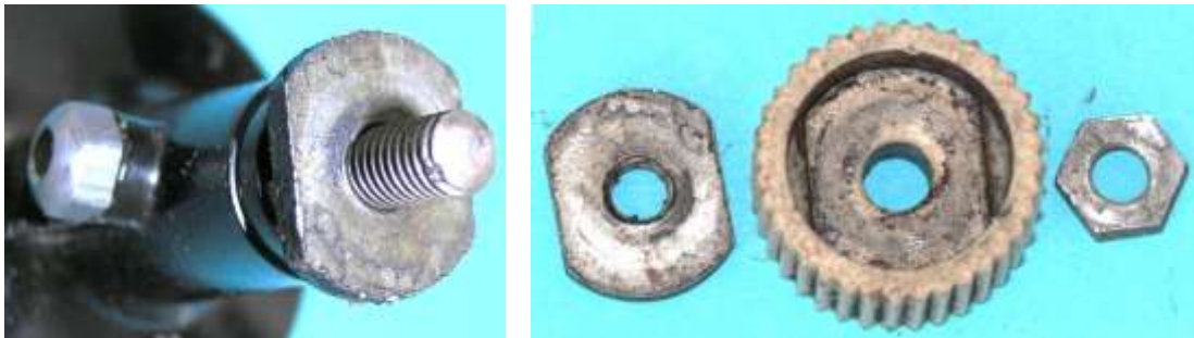
Bild 2.4: Reibradbefestigung: a) Wellenende mit unterer Kontermutter, b) Mutter mit zwei Schlüsselflächen, c) Unterseite des Reibrades mit Passflächen, d) Obere Kontermutter
