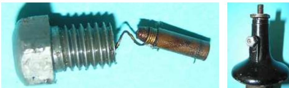
Bild 2.5: Ölbohrung mit Massebürste: a) Bürstenhalter und Kupferbürste, c) Lagerhals mit Bürstenhalter bzw. mit Verschluss der Ölbohrung
