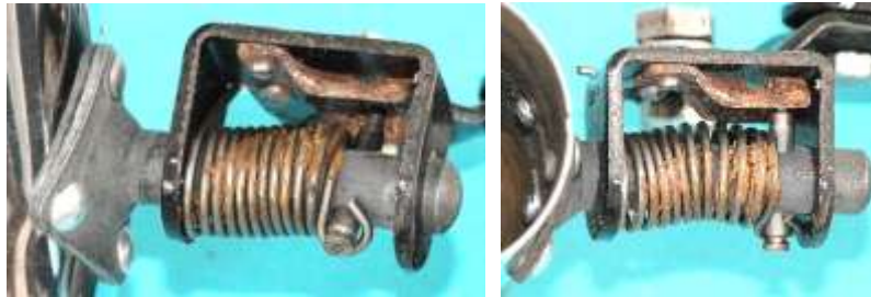
Bild 2.3: Kippvorrichtung: a) Betriebsstellung, b) Ruhestellung
