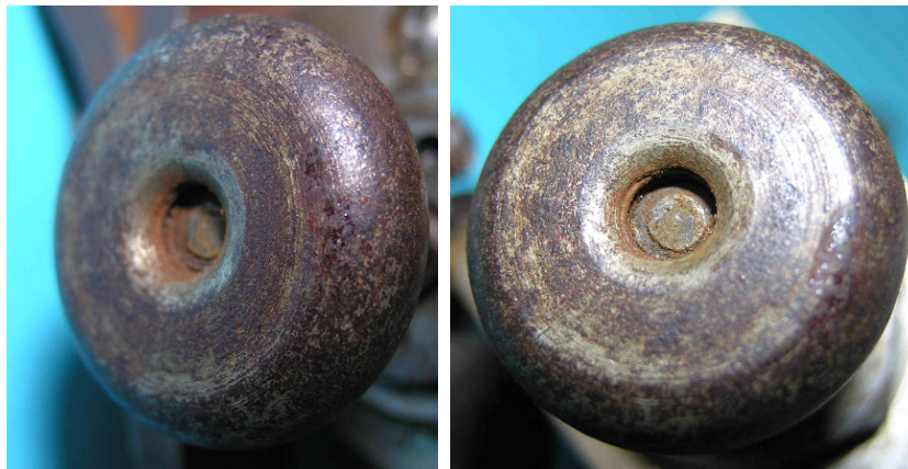
Bild 1.10: Reibrad des Geisslinger-Dynamos
