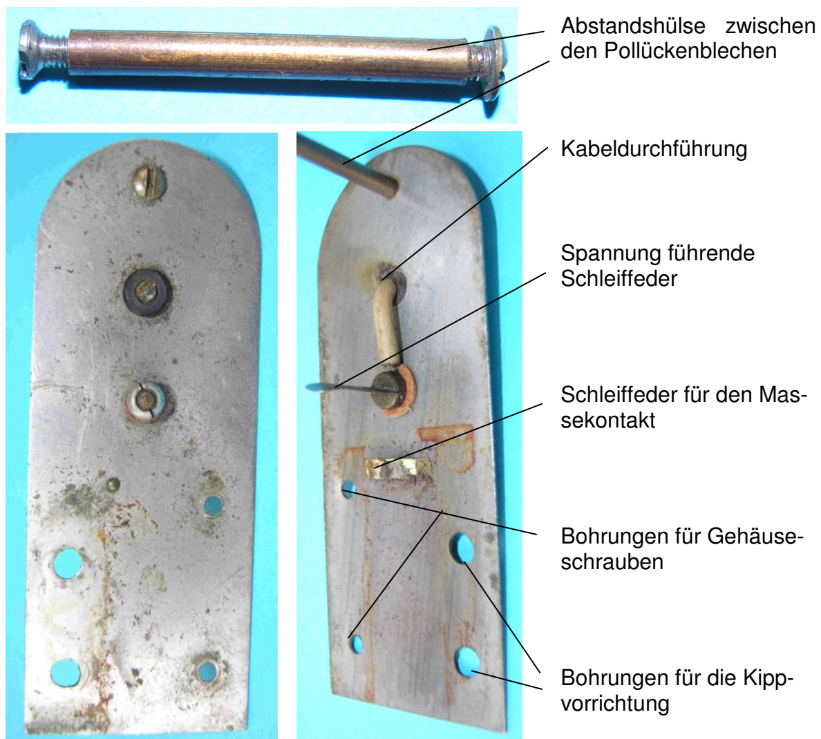
Bild 1.4: Abdeckung der hinteren Pollücke mit Funktionselementen
