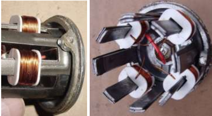
Bild 3.14: Ankerspulen auf jedem zweiten verlängerten Polschuh
