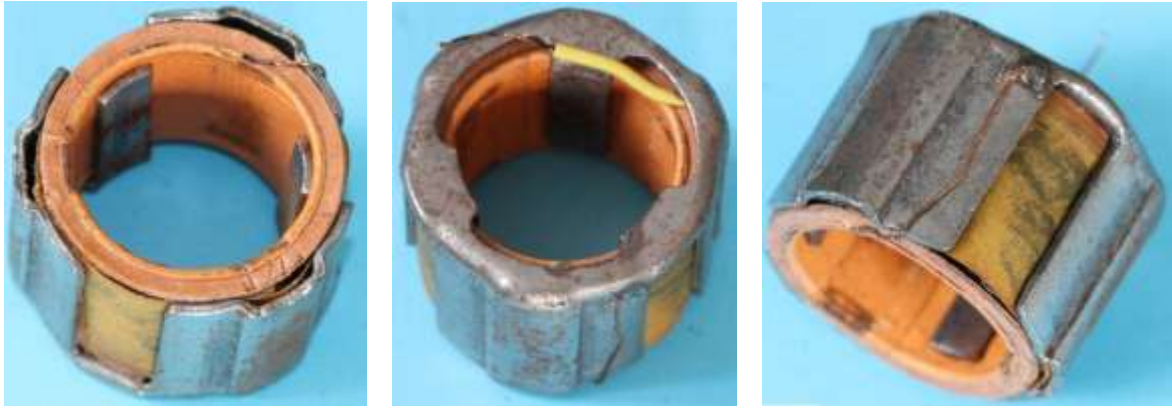
Bild 6.51: Ankerspule und Klauenpolkranz mit geprägtem Joch
