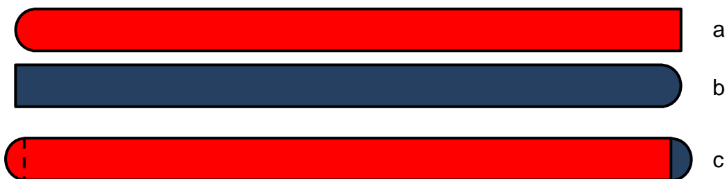
Bild 7.7: Ankerbleche (0,5 mm dick, 7 mm breit und 110 mm lang): a) Blech mit einer runden und einer geraden Schmalseite, b) Gedrehtes Ankerblech von a), c) Übereinander gelegte Bleche
