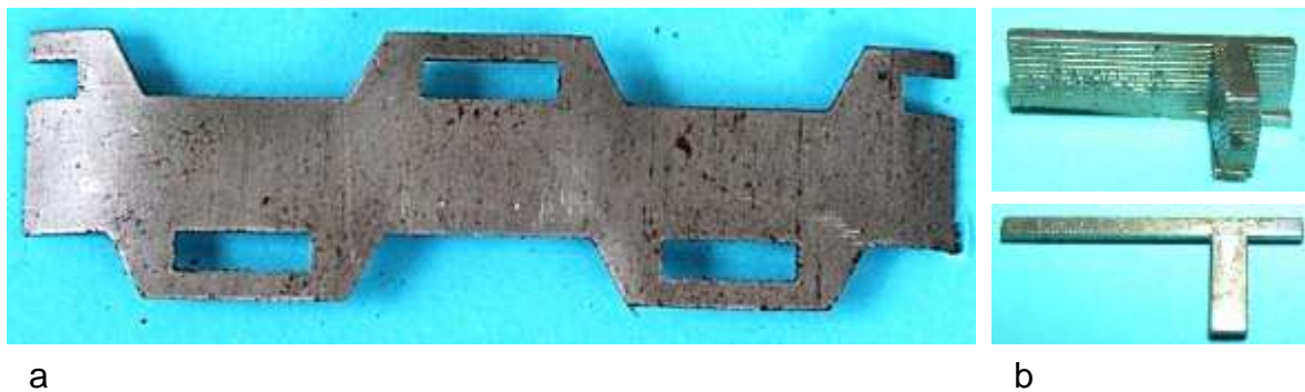
Bild 6.55: Ankereisen: a) Jochblech, b) Bleche eines Polschuhs
