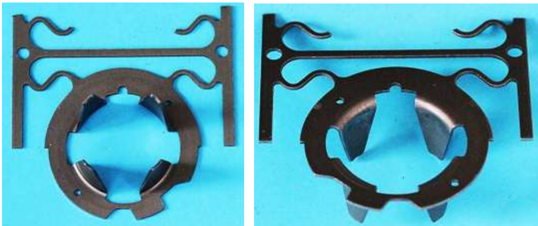
Bild 6.34: Klauenpolring im Blechstreifengitter
