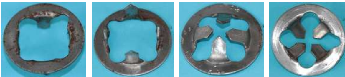
Bild 6.30: Dem Patent Nr. 687842 entsprechender Klauenpolkranz
