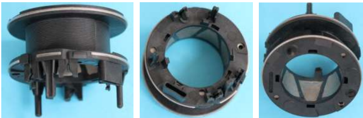
Bild 6.35: Zwei Klauenpolringe mit Thermoplast vergossen
