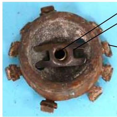
Bild 7.18: Unteres Gleitlager: a) Montagekorb mit eingelegter Kalotte, b) Kalottenlagerbrille
