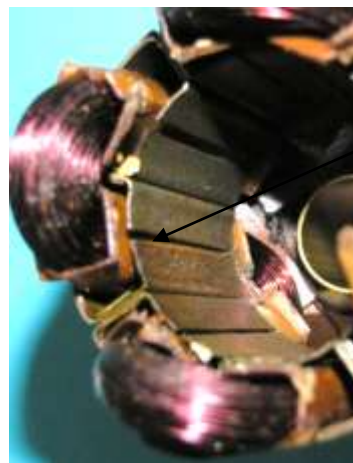
Bild 3.24: Anker: a) Eine Spulenseite ohne Ummantelung b) Luftspaltfläche mit kleiner Pollückenbreite
