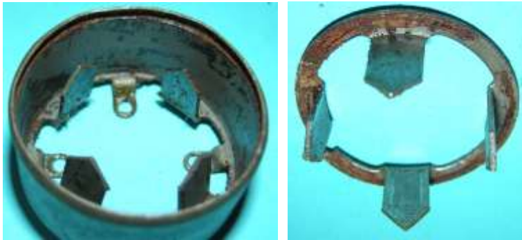
Bild 2.6: Ferromagnetische Verbindung der Pole gleicher Polarität
