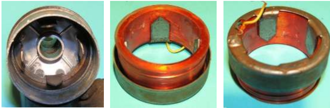
a b c Bild 6.40: Klauenpolanordnung ohne aufgeweitete Topfränder: a) Klauenpolkranz im Gehäuse, b) und c) Ankerspule mit einem Klauenpolkranz
