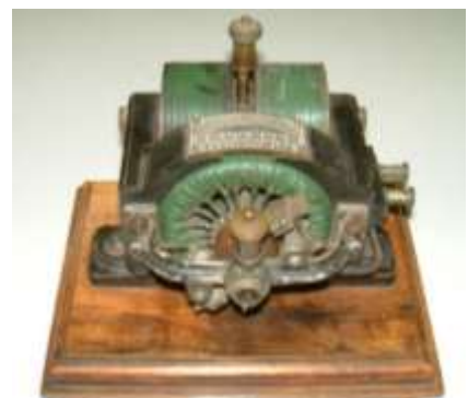
Bild 3.9: Bewicklung der Joche in Kombination mit einem Grammeschen Ringanker
