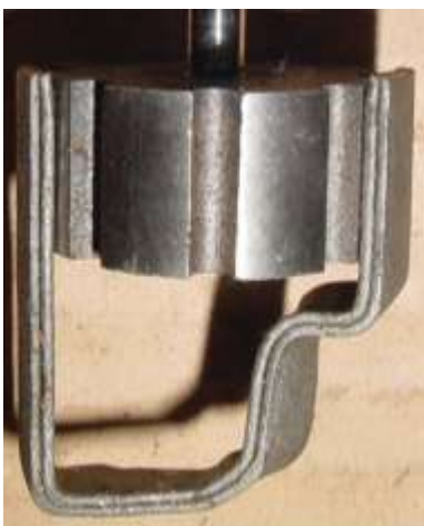
Bild 2.5: Ferromagnetische Verbindung zweier Pole, die um drei Polteilungen voneinander entfernt sind
