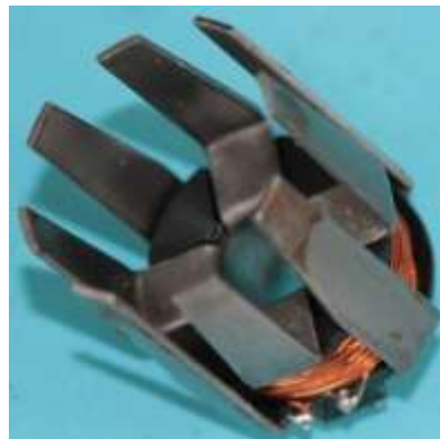
Bild 4.3: Lage der Ankerspule in axialer Richtung unter der Polradbohrung
