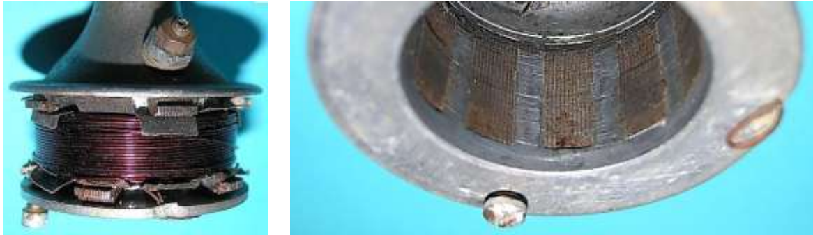
Bild 6.57: Polflächen: a) Übergangflächen zum Joch, b) Polflächen am Luftspalt
