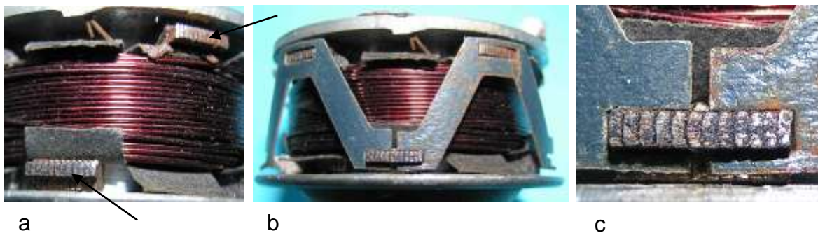
Bild 6.56: Eingegossene Polschuhblechpakete: a) Stirnseiten der Polschuhe, b) Mäanderförmige Gestaltung des Jochs, c) Stoßstelle zwischen einem Polschuhblechpaket und den Jochblechen
