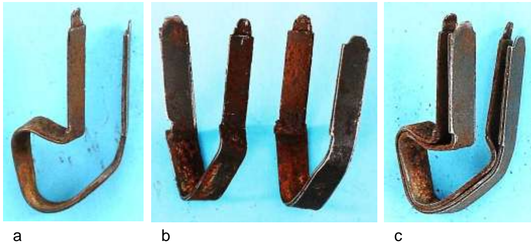
Bild 7.8: Elemente eines Ankerpolpaares: a) Geformtes Doppelblech, b) Zwei parallele Polpaare, c) Zwei parallele Polpaare zu einem Doppelpol vereinigt
