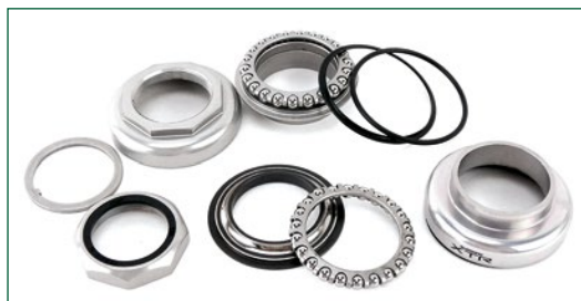
Bild 2: Bauteile des geschraubten Lenkungsagers
