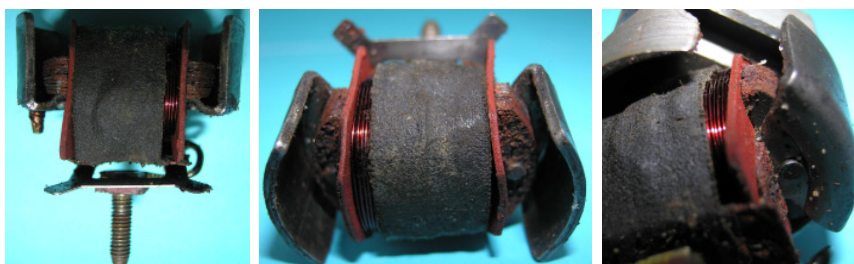
Bild 1.8: Positionierung der Polschuhe des Polrades zwischen den Ankerpolflächen
