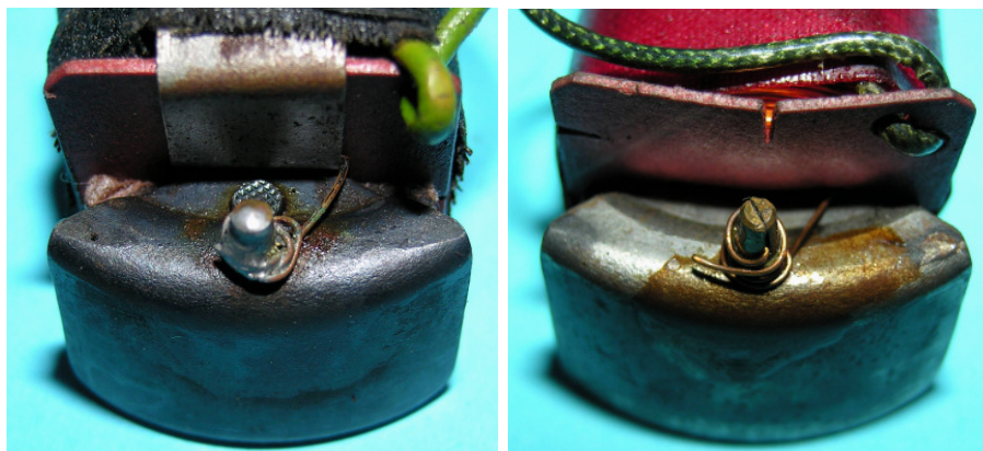
Bild 2.7: Masseanschluss: a) Lucifer 800 D b) Lucifer 800a S
