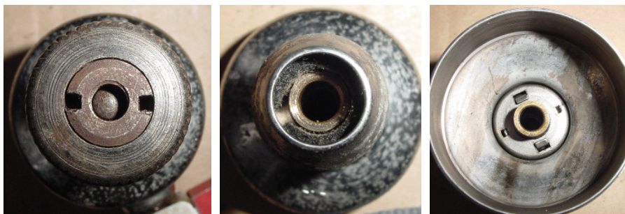
Bild 2.2: Reibrad und Lagerhals: a) Befestigung des Reibrades mit einer versenkten Schlitzmutter
