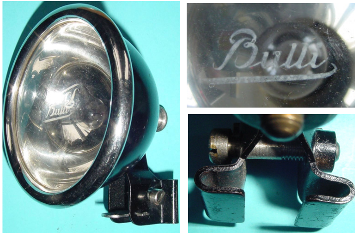
Bild 1.65: Bulli-Lampe mit beschriftetem Scheinwerferglas und Klemmschelle zur Befestigung am Laternenhalter
