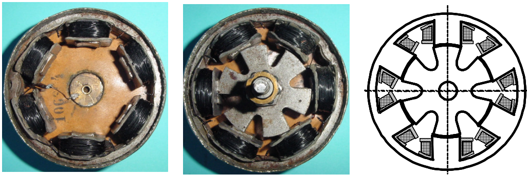
Bild 1.24: Ständer ohne und mit Läufer
