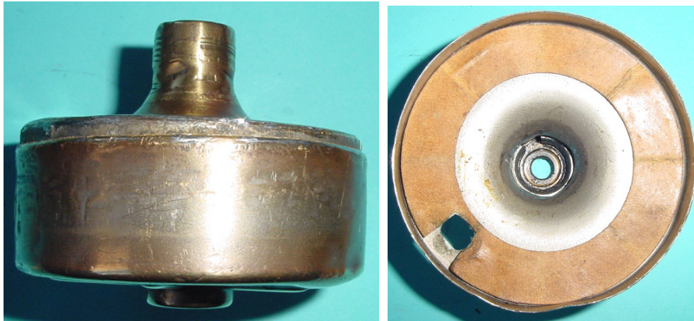
Bild 1.29: Seitenansicht des Dynamos Typ F mit der Innenansicht des Lagerhalses
