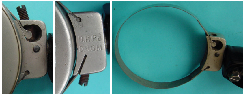
Bild 1.19: Spannband zur Befestigung des Dynamos am Rahmen
