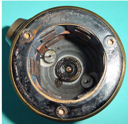
Bild 1.58: Anschluss von jeweils zwei Wicklungsenden an die Kabelanschlussklemmen im Gehäuseboden
