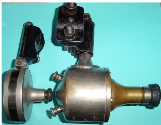
Bild 1.51: Gegenüberstellung des Fahrraddynamos Typ F und des Motorraddynamos Typ R
