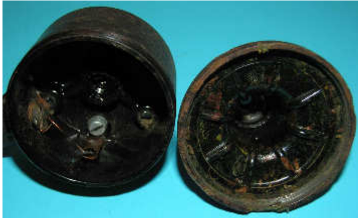
Bild 1.2: Gehäusekopf und Lagerhals aus gefülltem Duroplast
