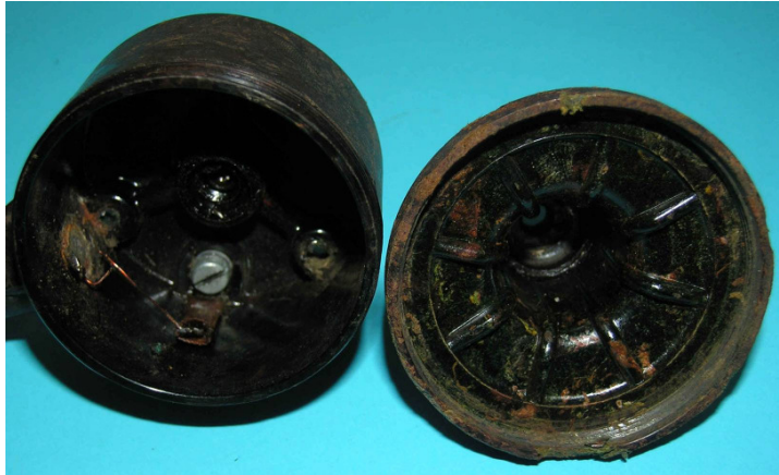
Bild 1.2: Gehäusekopf und Lagerhals aus gefülltem Duroplast
