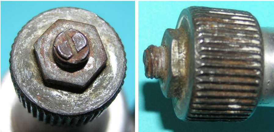
Bild 13: Sicherung der Kontermutter durch Spreizung des Wellenendes
