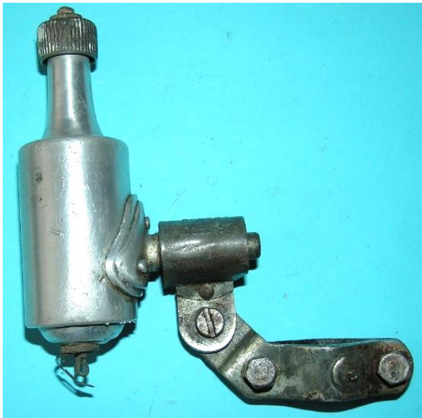
Bild 2: In der UdSSR produzierter Dynamo „OSATS“ mit vielen Merkmalen der Philips-Dynamos, Gewicht 325 g ohne Halter
