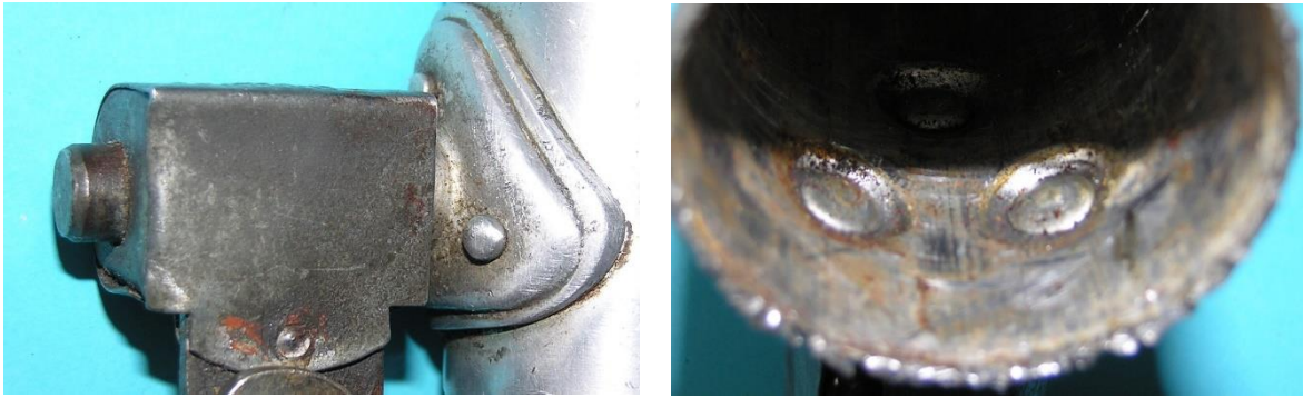
Bild 8: Befestigung des Aluminiumflansches mit drei Nieten am Gehäusemantel
