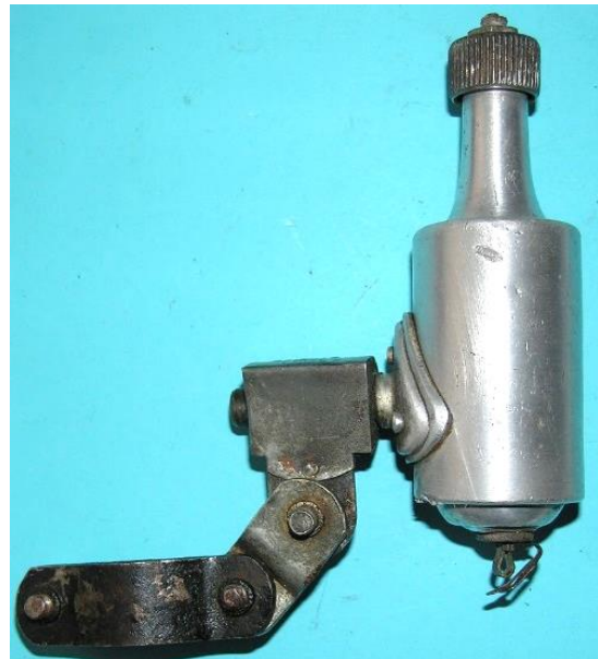
Bild 2: In der UdSSR produzierter Dynamo „OSATS“ mit vielen Merkmalen der Philips-Dynamos, Gewicht 325 g ohne Halter
