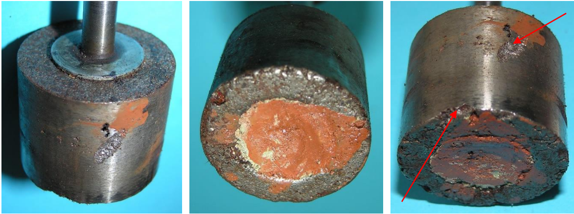
Bild 12: Polrad: a) Obere Stirnseite des Polrades mit Welle und Anschlagscheibe, b) Magnet und Vergussmasse an der unteren Stirnseite des Polrades, c) Lunker im Magnetkörper
