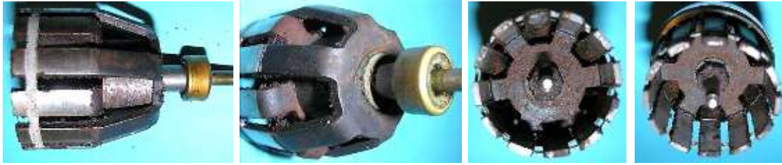
Bild 5.8: Klauenpolsystem des Läufers mit zweipoligem Dauermagneten
