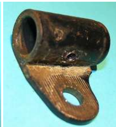
Bild 3.3: Kippeinrichtung: a) Befestigung mit ovalem Flansch, b) Abdeckung und Befestigungsflasche als gemeinsames Bauteil
