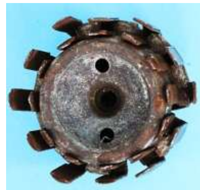
Bild 2.14: Montagekorb mit Ankerpolpaaren: a) Montagekorb mit Abstandsring, b) Abstandsring, c) Montagekorb mit den 6 Doppelpolpaaren
