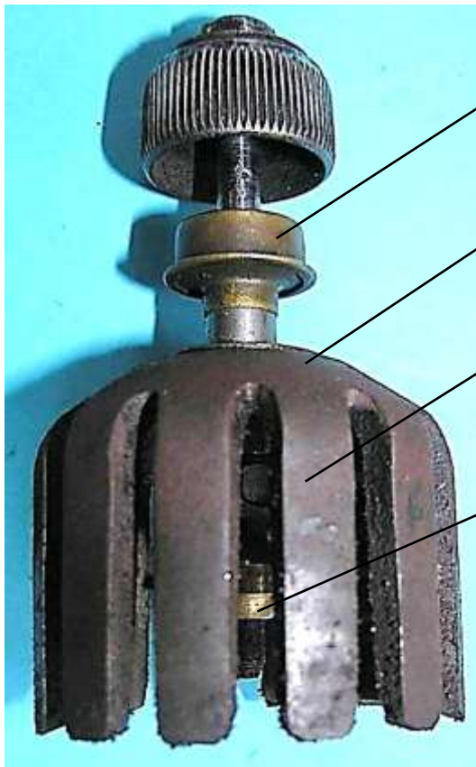
Bild 3.10: Lagerung des Polrades
