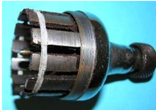
Bild 5.4: Zweiteiliges Gehäuse a) Gehäusekopf mit Anker b) Lagerhals mit Läufer
