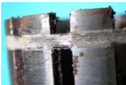
Bild 5.5: Verzinnte Kupferdrahtbandage: a) In Nuten eingelegte Drahtbandage, b) Verzinnte Windungen, c) Ansicht der Bandage von innen
