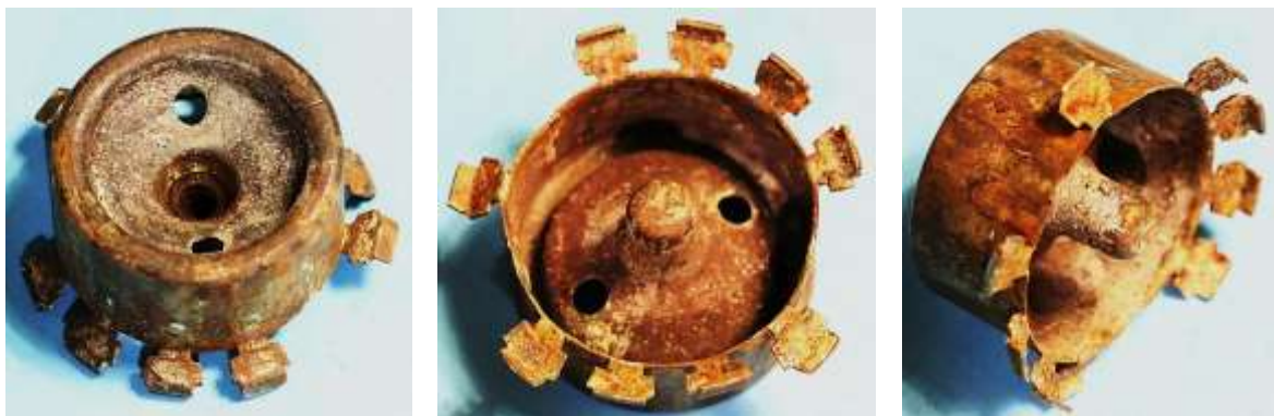
Bild 2.9: Montagezylinder: a) Kalottenlagerseite, b) und c) Unterseite mit Lagerdom
