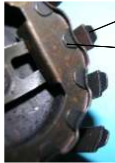
Bild 2.13: Ankerpole a) Polspitzen, b) Jochbereich
