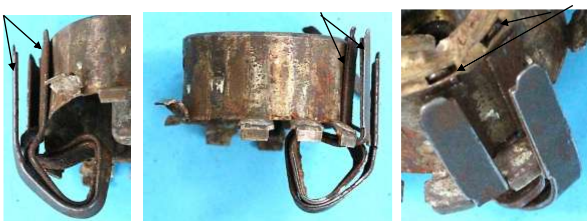
Bild 2.10: Montagekorb mit einem Doppelpolpaar: a) Lange Pole im Vordergrund, b) Kurze Pole im Vordergrund, c) Innere Pole im Abstandsring eingefügt
