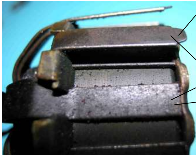
Bild 2.11: Abstandslaschen mit inneren und äußeren Polschuhen
