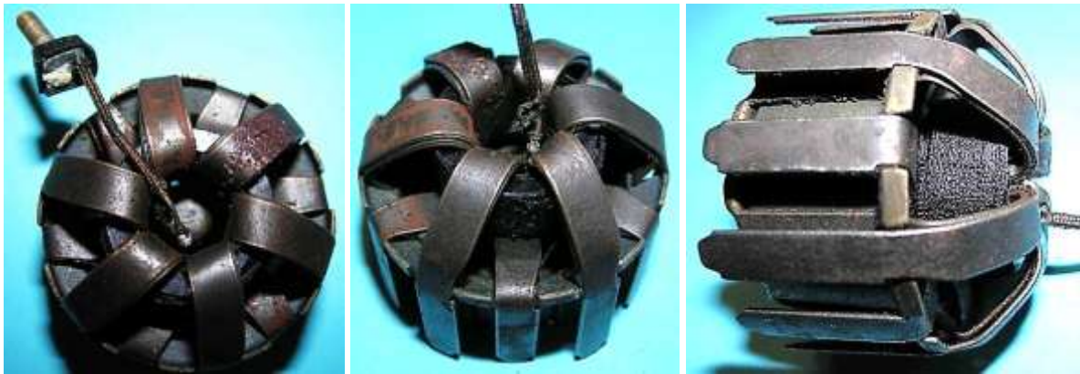
Bild 1.2: Ansichten des 12-poligen Ankers mit sechs Doppelpolpaaren
