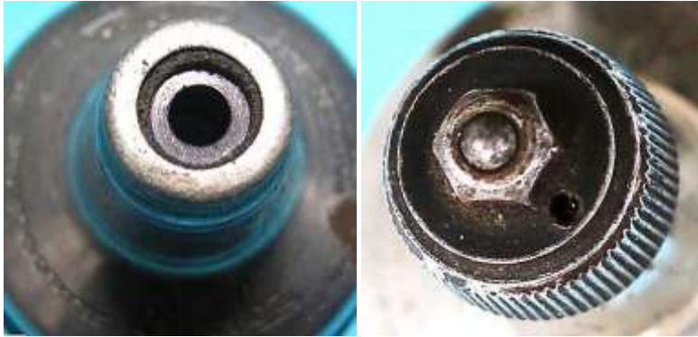
Bild 3.9: Schmiermittelversorgung des oberen Gleitlagers: a) Oberes Gleitlager, b) Ölbohrung im Reibrad
