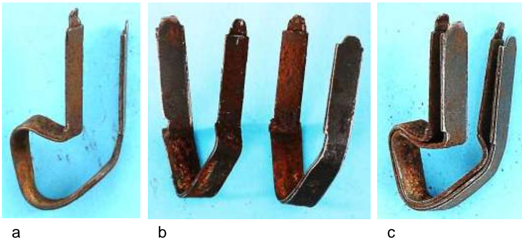
Bild 2.6: Elemente eines Ankerpolpaars: a) Geformtes Doppelblech, b) Zwei parallele Polpaare, c) Zwei parallele Polpaare zu einem Doppelpol vereinigt
