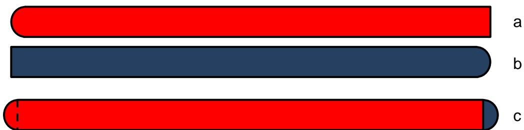
Bild 2.5: Ankerbleche (0,5 mm dick, 7 mm breit und 110 mm lang): a) Blech mit einer runden und einer geraden Schmalseite, b) Gedrehtes Ankerblech von a), c) Übereinander gelegte Bleche
