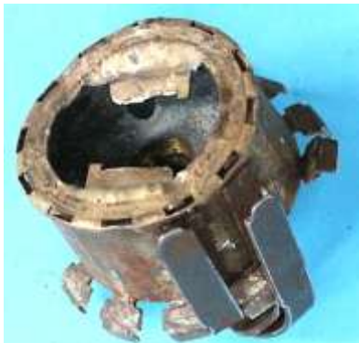
Bild 2.14: Montagekorb mit Ankerpolpaaren: a) Montagekorb mit Abstandsring, b) Abstandsring, c) Montagekorb mit den 6 Doppelpolpaaren
