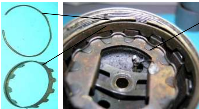
Bild 5.17: Zahnring und offener Federring zur axialen Sicherung des Ankers
