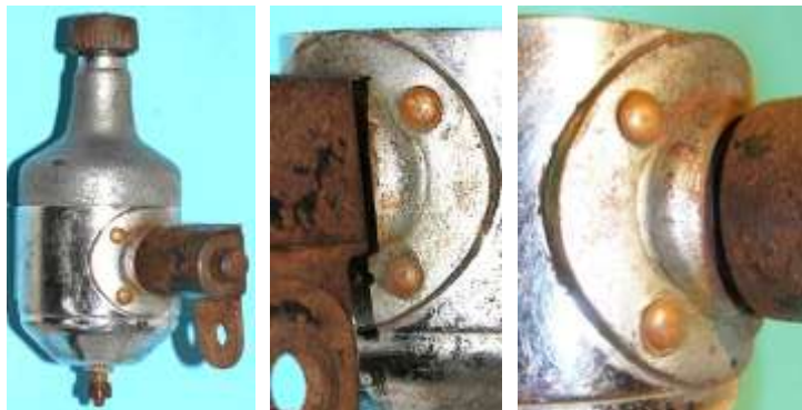
Bild 4.4: Runder Flansch mit vier Nieten am Gehäusemantel befestigt
