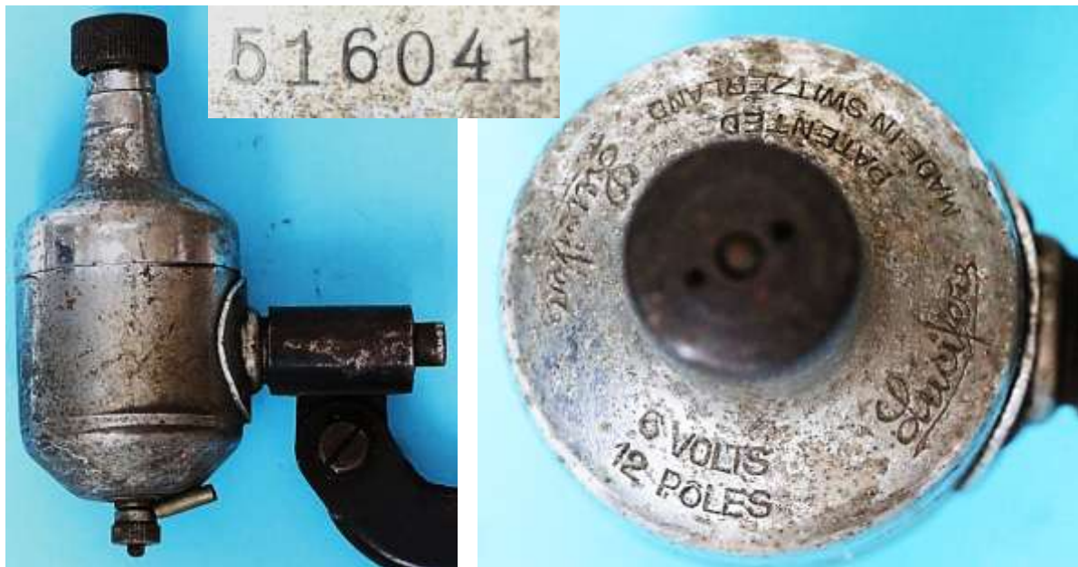
Bild 4.3: Lucifer-Dynamo mit 12 Einzelmagneten mit der Fertigungsnummer 516041
