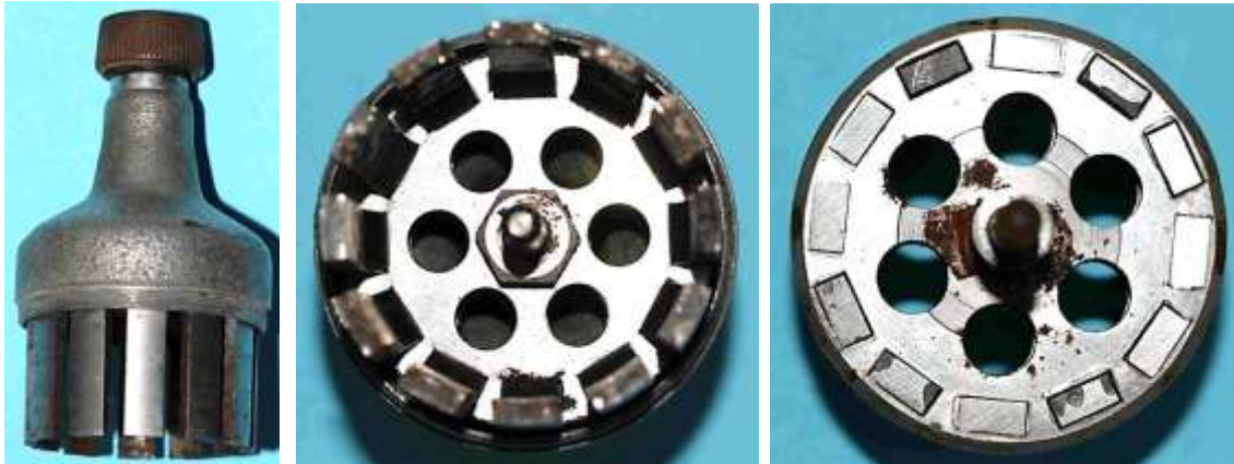
Bild 4.10: Polrad: a) Polrad mit Lagerhals, b) Stirnseiten der Magnetpole, c) Einpassung der rechteckigen Stabmagnete in die obere Jochplatte
