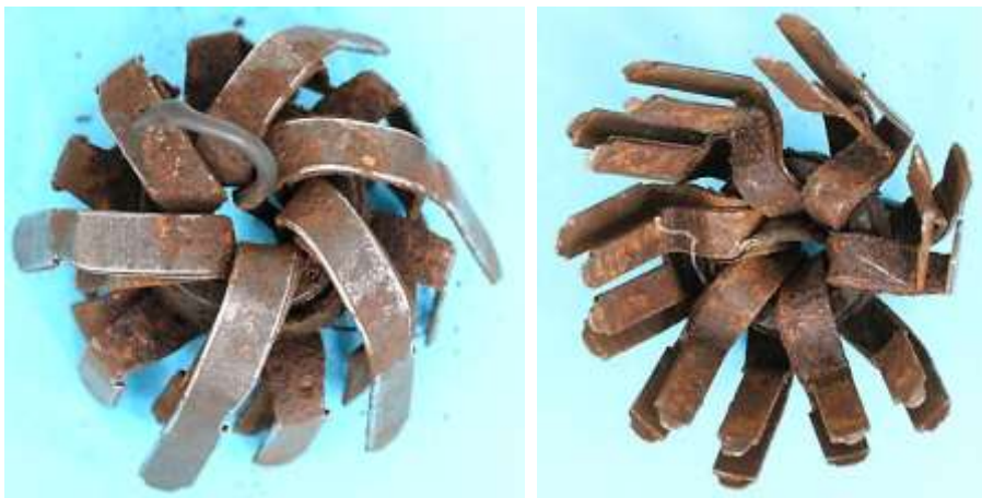
Bild 2.8: Anker mit den separaten Klauenpolpaaren a) Ansicht der Joch, b) Ansicht des Montage-raums
