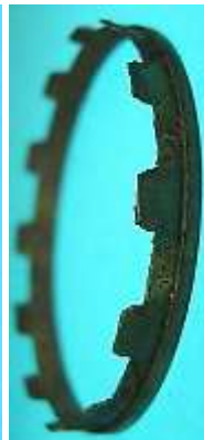
Bild 2.15: Zahnring zur Fixierung der Pollücken
