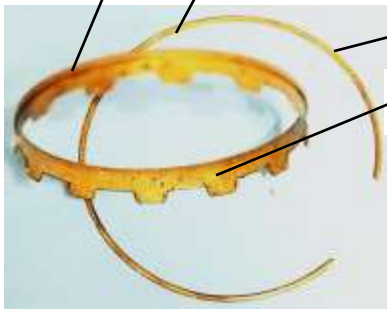
Bild 4.6: Stabilisierung der Polbleche an der Gehäusewand
