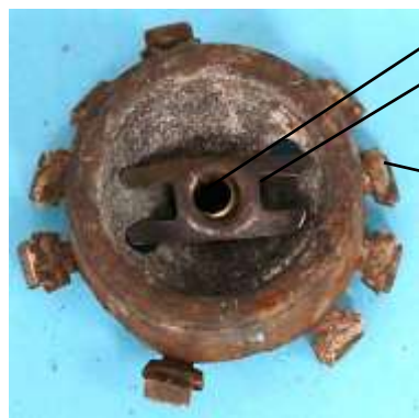
Bild 2.16: Unteres Gleitlager: a) Montagekorb mit eingelegerter Kalotte, b) Kalottenlagerbrille
