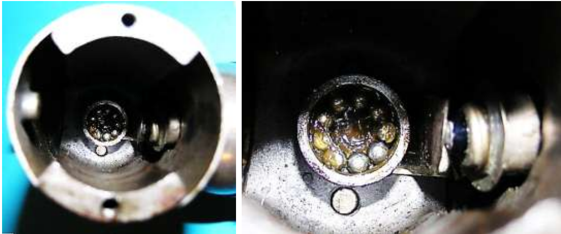
Bild 2.12: Spannung führendes Lager
