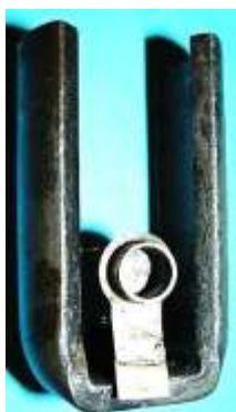
Bild 2.4: Kippvorrichtung: a) Bodenlöcher mit den Gewindebohrungen im Magneten im Hintergrund, b) Feder, Drehbolzen und Halteblech
