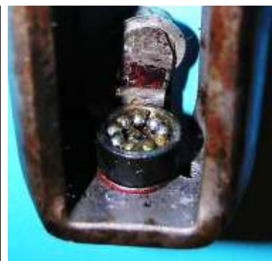
Bild 2.4: Kippvorrichtung: a) Bodenlöcher mit den Gewindebohrungen im Magneten im Hintergrund, b) Feder, Drehbolzen und Halteblech
