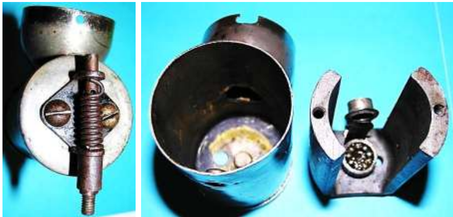
Bild 2.3: Bauteile: a) Kippvorrichtung, b) Gehäusetopf, c) Magnet mit Lager und Lampenfassung
