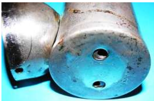
Bild 2.4: Kippvorrichtung: a) Bodenlöcher mit den Gewindebohrungen im Magneten im Hintergrund, b) Feder, Drehbolzen und Halteblech
