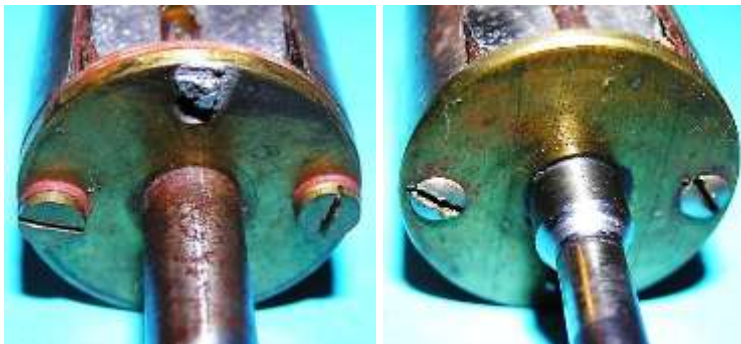
Bild 2.9: Wellenstümpfe mit Messingplatten a) Isolierte Platte mit Lötstelle für den Spannung führenden Spulenanschluss, b) Kugellagersitz auf der Reibradseite
