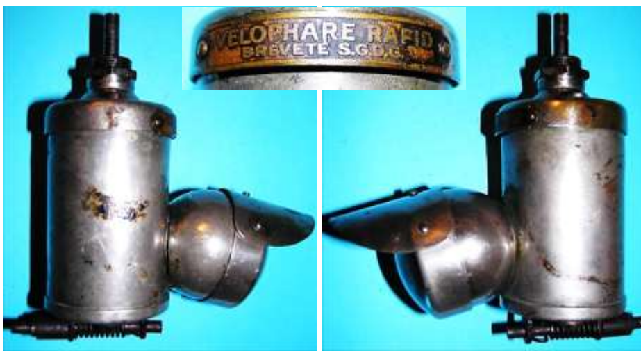
Bild 1.1: Dynamo-Lampen-Kombination „Velophare Rapid“
