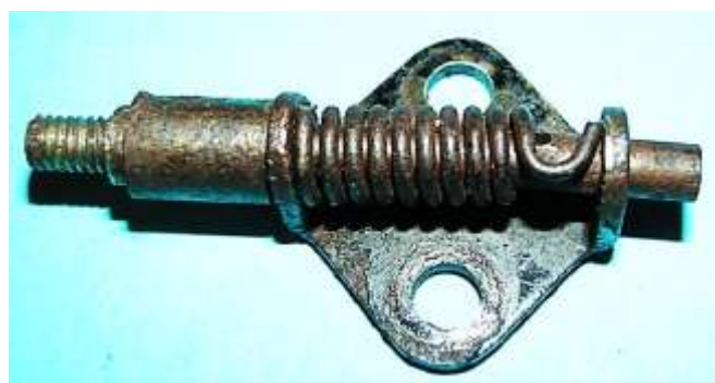
Bild 2.4: Kippvorrichtung: a) Bodenlöcher mit den Gewindebohrungen im Magneten im Hintergrund, b) Feder, Drehbolzen und Halteblech
