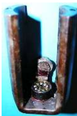
Bild 2.4: Kippvorrichtung: a) Bodenlöcher mit den Gewindebohrungen im Magneten im Hintergrund, b) Feder, Drehbolzen und Halteblech
