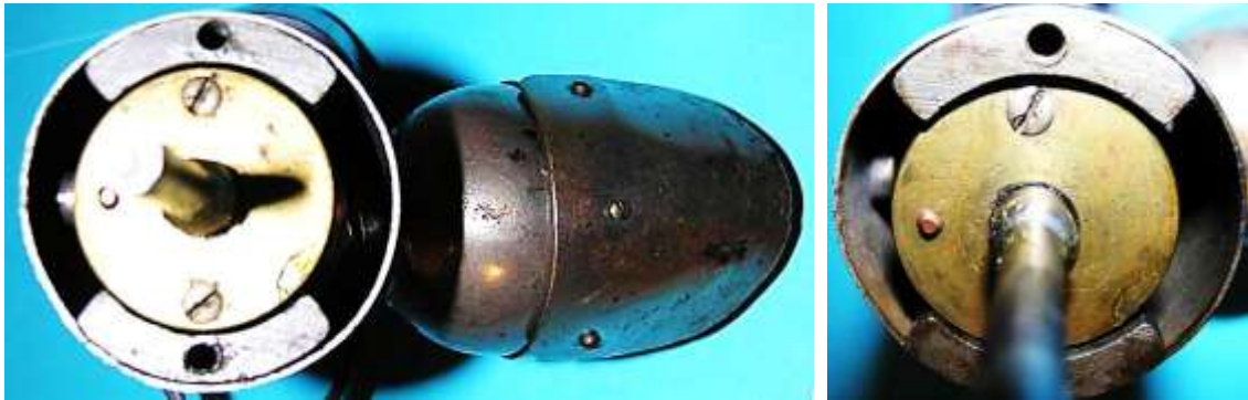
Bild 2.8: Ansicht der Stirnflächen des Magneten und des Ankers
