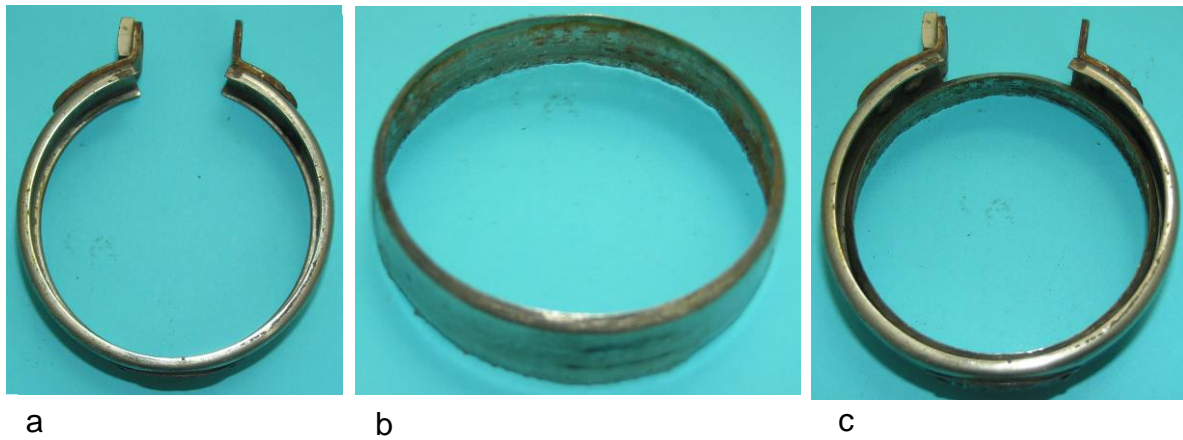
Bild 3.9: Halterung: a) Spannband, b) Bandage, c) Spannband mit Bandage
