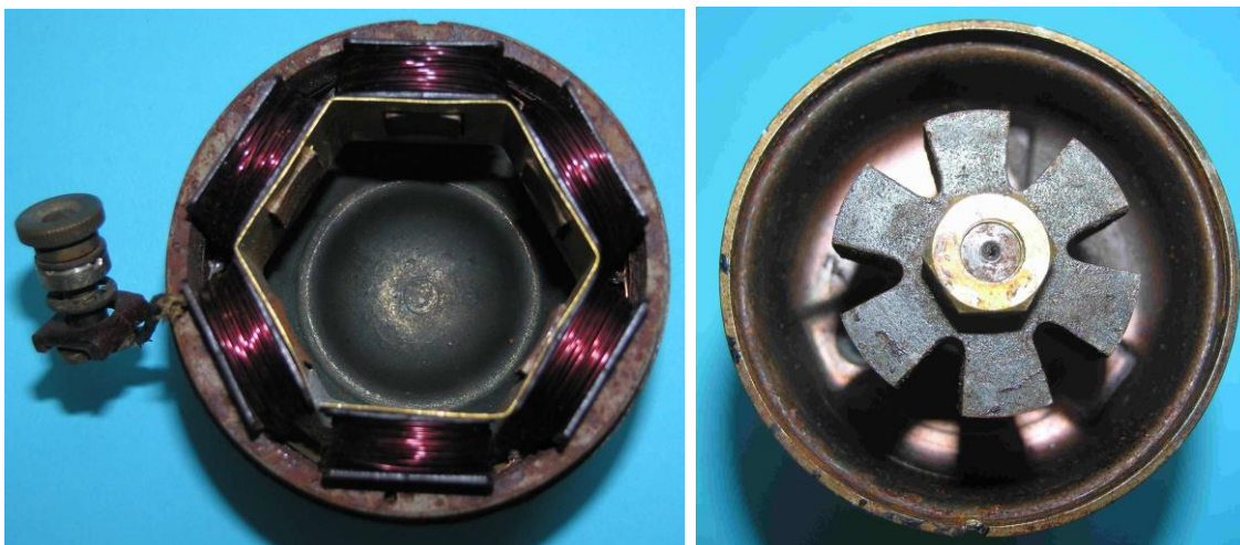
Bild 3.13: Baugruppen des Generators: a) Sechspoliger Anker, b) Polrad aus gegossenem Magnetstahl
