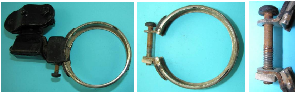
Bild 3.6: Kippvorrichtung mit Spannring, b) Spannband mit Spannbolzen, c) Spannbolzen
