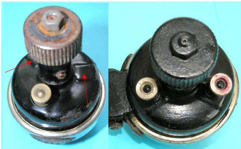
Bild 3.8: Hassia-Dynamos a) „Hassia 1“ mit einer b) „Hassia-Einbeck“ mit zwei Anschlussklemmen
