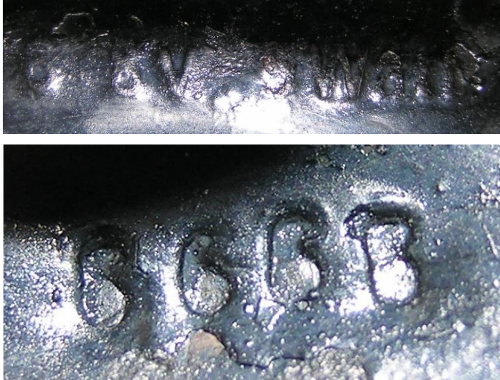
Bild 3.3: Beschriftung auf der Abdeckung der Kippvorrichtung, oben: Nenndaten 6 V-8 V, 5 W, unten: Fertigungsnummer: 8668 (siehe Pfeile im Bild 3.2)
