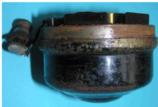
Bild 3.10; Baugruppen: a) Gehäusehals mit Reibrad, b) Gehäuseboden mit Anker
