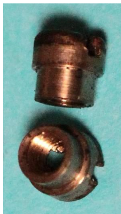
Bild 2.9: Schraubverbin- dung der Gehäuseteile a) Versenkte Schlitzmutter im Lagerhals, b) Konturen der Schlitzmutter
