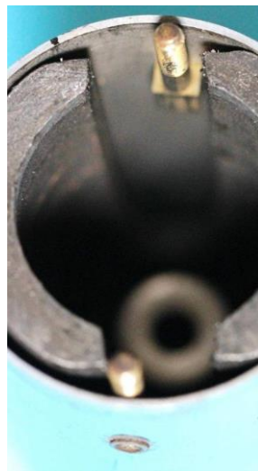
Bild 2.8: Befestigung der Gewindebolzen am Ge- häusemantel
