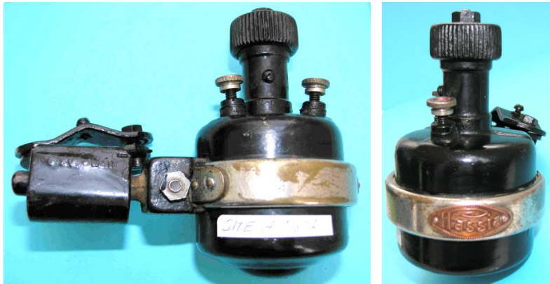
Bild 1.3: Hassia: 6-poliger Schuhkremdosens-Typ a) Zwei Kabelanschlussklemmen, b) Eine Kabelanschlussklemme
