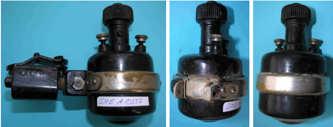
Bild 3.5: Entfernung des Spannring: a) Montierte Kippvorrichtung am Spannring, b) Entfernte Kippvorrichtung, c) Entfernter Spannring
