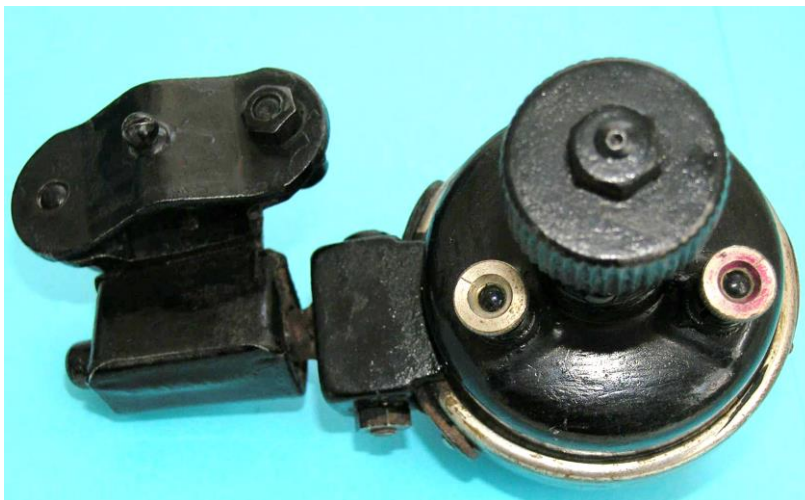
Bild 3.4: Position der Kabelanschlussbolzen
