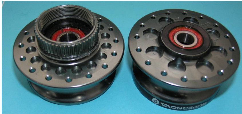
Bild 1.3: Gehäuseschalen mit Kugellager a) Seite mit einer Scheibenbremsaufnahme b) Steckerseite
