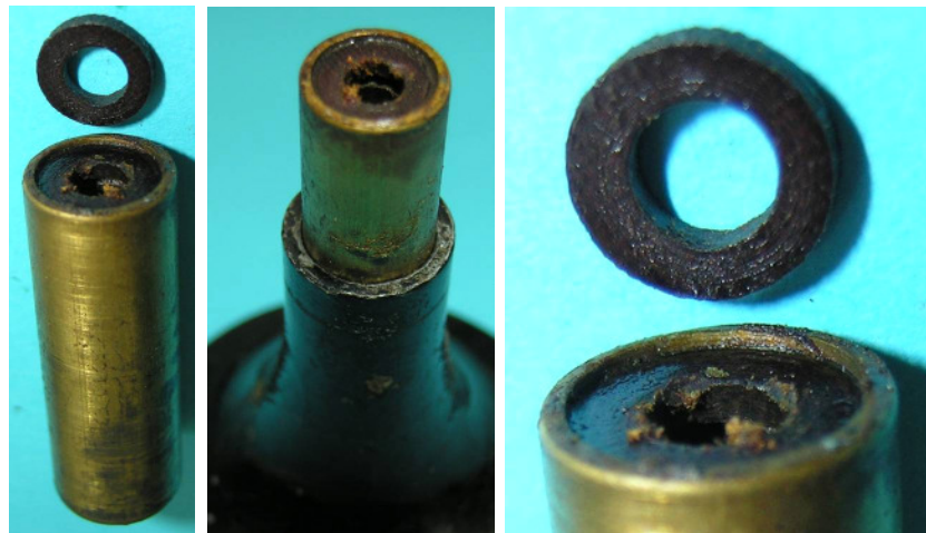
Bild 1.12: Gleitlager: a) Lagerhülse b) aus dem Lagerhals ragende Lagerhülse, c) abgehobene Lager- platte
