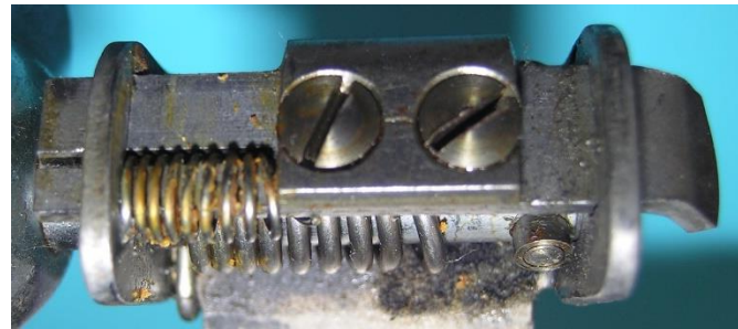
Bild 1.8: Verdrehung des Sperrstifts 2: a) Ruhestellung, b) Betriebsstellung
