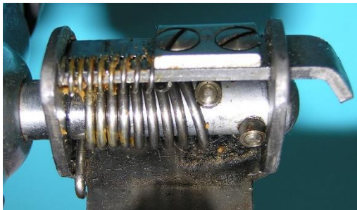
Bild 1.8: Verdrehung des Sperrstifts 2: a) Ruhestellung, b) Betriebsstellung
