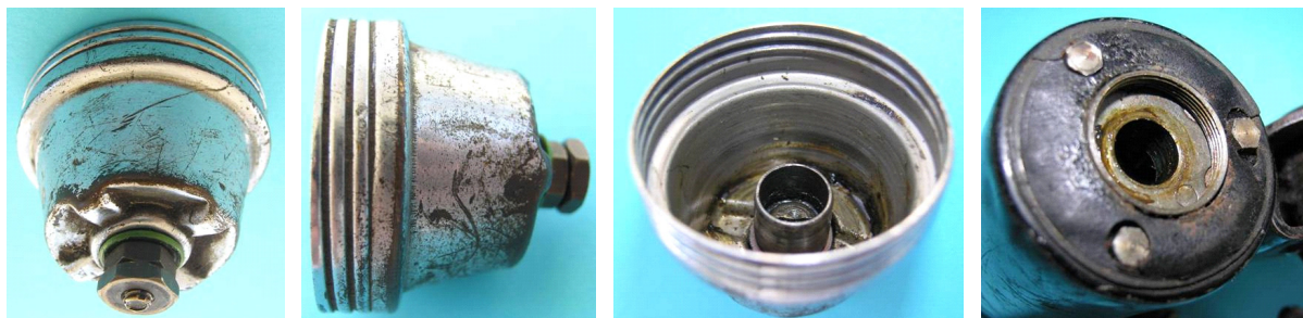
Bild 1.17: Schalterkappe: a) Schalterkappe mit Kabelanschluss, b) Eingewalztes Gewinde, c) Feststehender Schleifring in der Schalterkappe, d) Dichtung zwischen Gehäuseboden und Schalterkappe
