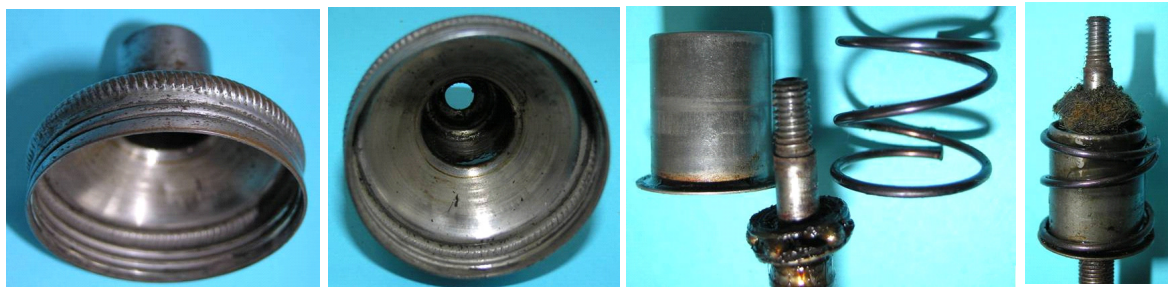
Bild 1.8: Lagerhals: a) Gewinde am Lagerhalsfuß, b) Sitz der Lagerhülse, c) Lagerhülse, Kugellager und Axialdruckfeder
