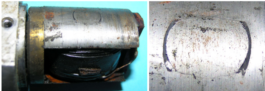
Bild 1.8: Fügspalt zwischen den Polschuhen und dem Spulenkern
