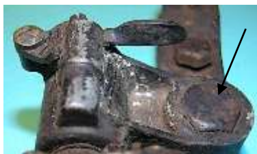
Bild 3.7: Angegossenes Rohr für die Rückstellfeder: a) Kippvorrichtung mit dem Halterbolzen, b) Bedienungshebel mit seiner Achse, c) Axiale Ausdehnung des Rohres mit Führungsschlitz für den Bedienungshebel
