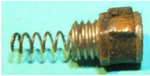
Bild 3.13: Massekontakt und Ölnippel: a) Massefeder und mit einer Federklammer-verschlossene Ölbohrung, b) Offene Ölbohrung
