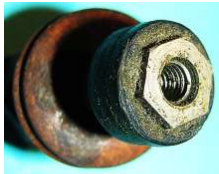
Bild 3.21: Bürstenhalter: a) Bürstenhalter mit abgesetztem Kunststoffrohr, b) Innengewinde für den Kabelanschlussbolzen
