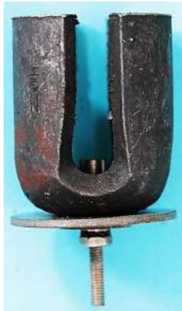
Bild 4.6: Spanscheibe: a) Logo des Magnetherstellers, b) Magnet mit Spanscheibe, c) Spanscheibe mit Schlitzschrauben
