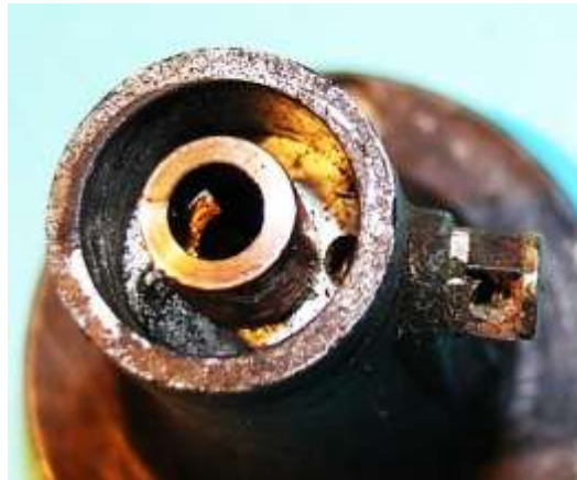
Bild 3.14: Oberes Öldepot: a) Eingelegter Filzring, b) Lager mit Ölfenster
