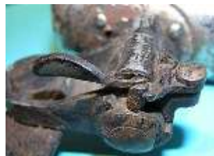
Bild 3.7: Angegossenes Rohr für die Rückstellfeder: a) Kippvorrichtung mit dem Halterbolzen, b) Bedienungshebel mit seiner Achse, c) Axiale Ausdehnung des Rohres mit Führungsschlitz für den Bedienungshebel
