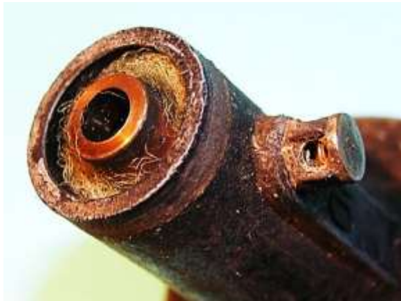
Bild 3.14: Oberes Öldepot: a) Eingelegter Filzring, b) Lager mit Ölfenster
