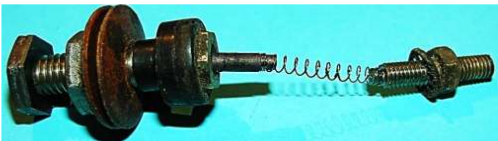
Bild 3.21: Bürstenhalter: a) Bürstenhalter mit abgesetztem Kunststoffrohr, b) Innengewinde für den Kabelanschlussbolzen
