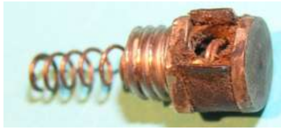
Bild 3.13: Massekontakt und Ölnippel: a) Massefeder und mit einer Federklammer-verschlossene Ölbohrung, b) Offene Ölbohrung
