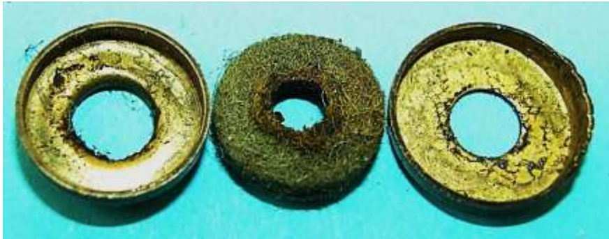
Bild 2.10: Öldepot des Spurlagers
