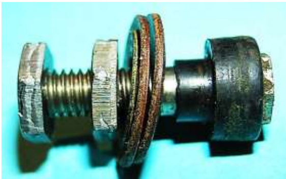
Bild 3.21: Bürstenhalter: a) Bürstenhalter mit abgesetztem Kunststoffrohr, b) Innengewinde für den Kabelanschlussbolzen
