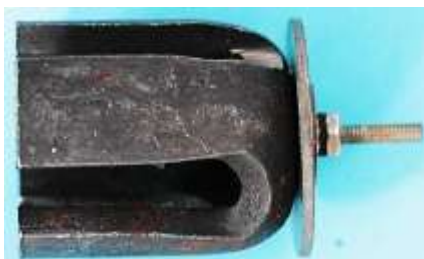
Bild 4.8: Spannung führender Kontakt: a) Zentrale Position des Kontaktbolzens, b) Kontaktbolzen mit Kohlebürste und Isolierteilen
