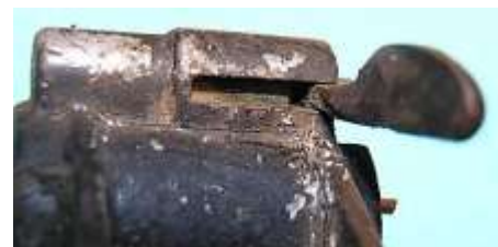
Bild 3.7: Angegossenes Rohr für die Rückstellfeder: a) Kippvorrichtung mit dem Halterbolzen, b) Bedienungshebel mit seiner Achse, c) Axiale Ausdehnung des Rohres mit Führungsschlitz für den Bedienungshebel
