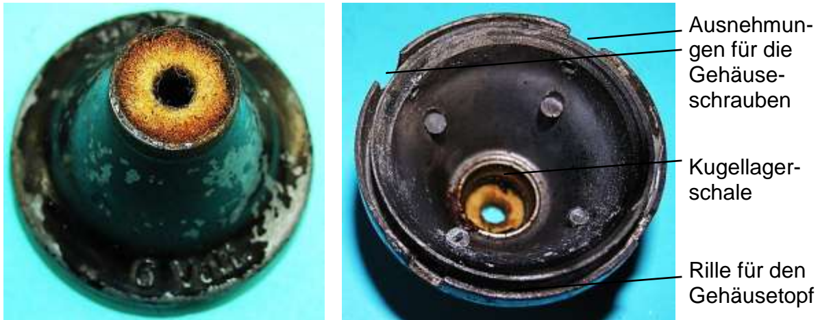
Bild 2.3: Lagerhals: a) Filzring zur Abdeckung des Kugellagers, b) Vermerk der Nennspannung auf dem Lagerhalsfuß
