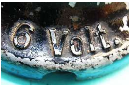
Bild 2.2: Bezeichnung der Nennspannung auf dem Lagerhalsfuß
