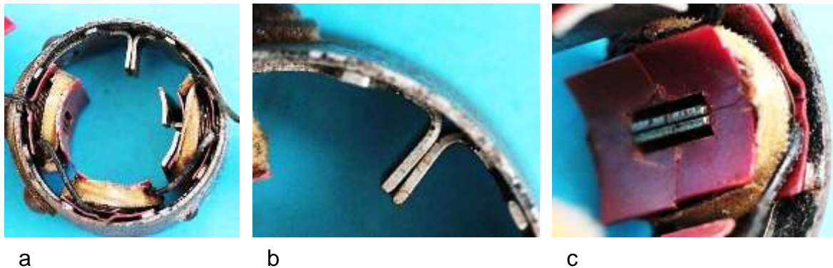
Bild 5.8: Montage der Ankerspulen: a) Drei Spulen und ein Polschuh eingesetzt, b) Halber Polschaft, c) Freier Raum für die Polschaftabschnitte an den Polschuhen
