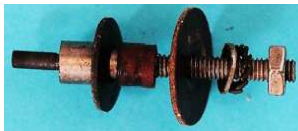
Bild 4.8: Spannung führender Kontakt: a) Zentrale Position des Kontaktbolzens, b) Kontaktbolzen mit Kohlebürste und Isolierteilen
