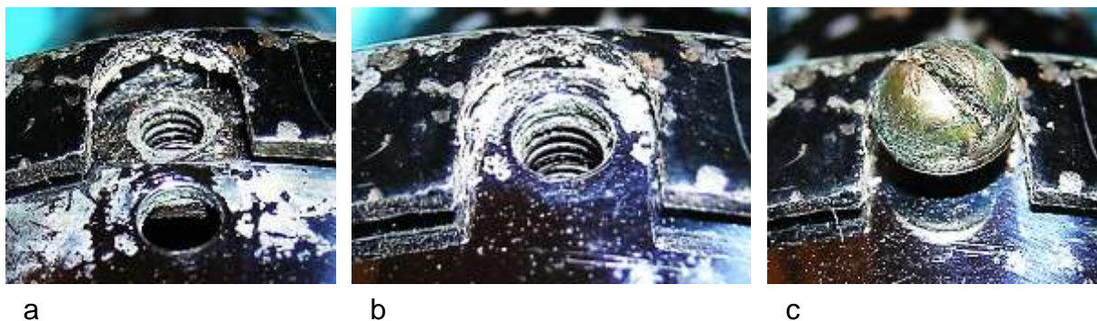
Bild 2.4: Schraubverbindung des Lagerhalsfußes mit dem Gehäusetopf: a) Bohrung im Gehäusetopf und Gewindeloch im Lagerhalsfuß, b) Ineinander geschobene Gehäuseteile, c) Eine der vier Schlitzschrauben
