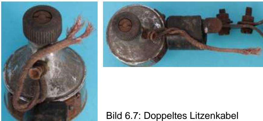
Bild 6.6: Begrenzung des Drehwinkels: a) Nach innen eingebogener Blechzapfen, b) Anschlag des Blechzapfens am Sperrstift
