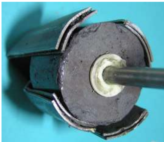
Bild 18.5: Keramisches Polrad zwischen den Ankerpolen
