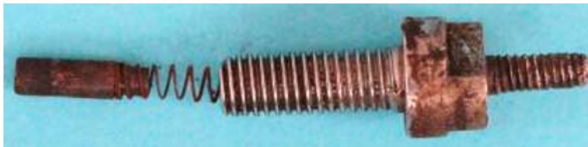
Bild 2.25: Kombination aus Kabelanschlussbolzen und Bürstenhalter mit Bürste
