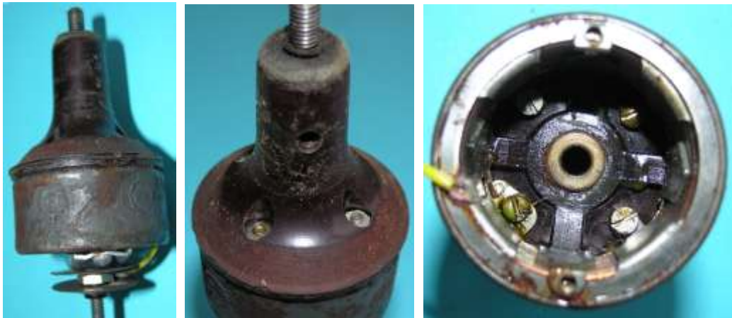
Bild 12.6: Lagerhals und Anker: a) Vollständige Generatoreinheit, b) Versenkte Muttern der Verschraubung, c) Schraubenköpfe der Verschraubung
