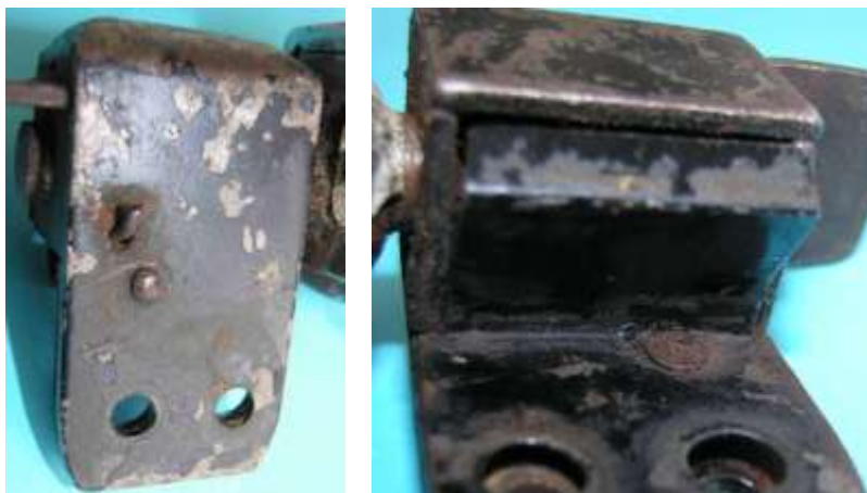
Bild 5.31: Befestigung der Abdeckung a) Nietkopf auf der Rückseite des Basisblechs b) Flacher Nietkopf auf der Abdeckseite
