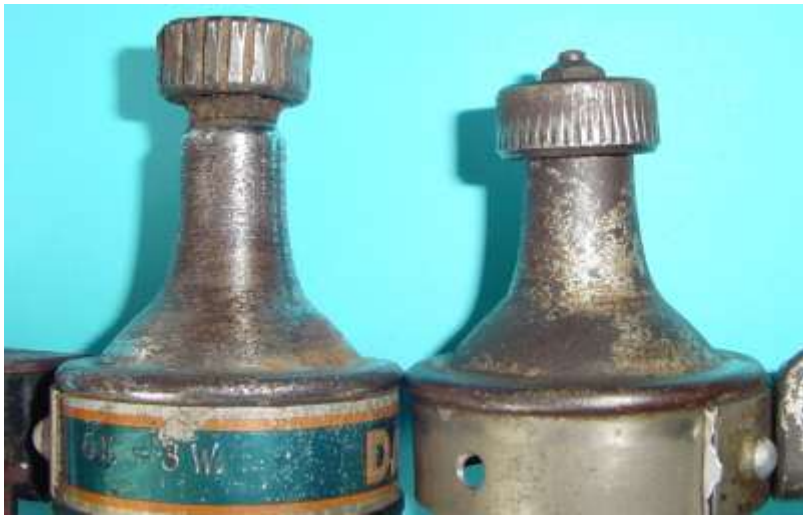
Bild 7.37: Profile der Reibräder der Dynamos von Daimon 52 und Bateria 52
