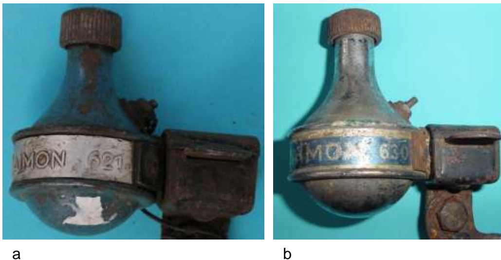
Bild 11.17: Kugeldynamos: a) Typ 621, Manteldurchmesser 48 mm, b) Typ 630, Manteldurchmesser 58 mm
