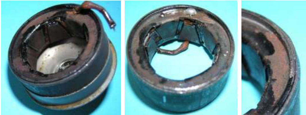
Bild 6.12: Klauenpolanker: a) Anker mit Bodentopf, b) Joch, zwei Klauenpolringe und Spule, c) Schnittkanten eines Klauenpolrings und des Jochrings
