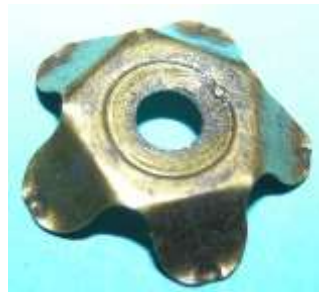
Bild 8.11: Feder für den Axialspielausgleich: a) Feder mit Polrad, b) Feder mit Anlaufscheibe, c) Vertiefungen an den Federfüßen zum Einklinken in die Pollücken
