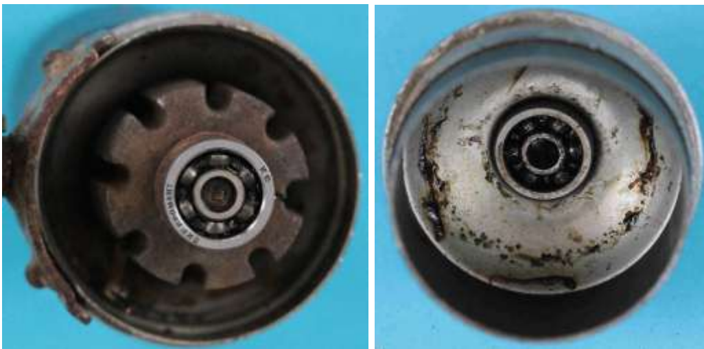
Bild 9.8: Lagerung des Polrades: a) Polrad mit unterem Kugellager, b) Boden mit unterem Kugellager
