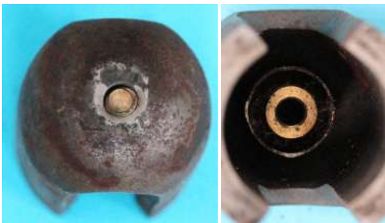
Bild 2.23: Spurlager: a) Verankerung im Magnetjoch, b) Lagerhülse und Öldepot im Innenraum des Magneten
