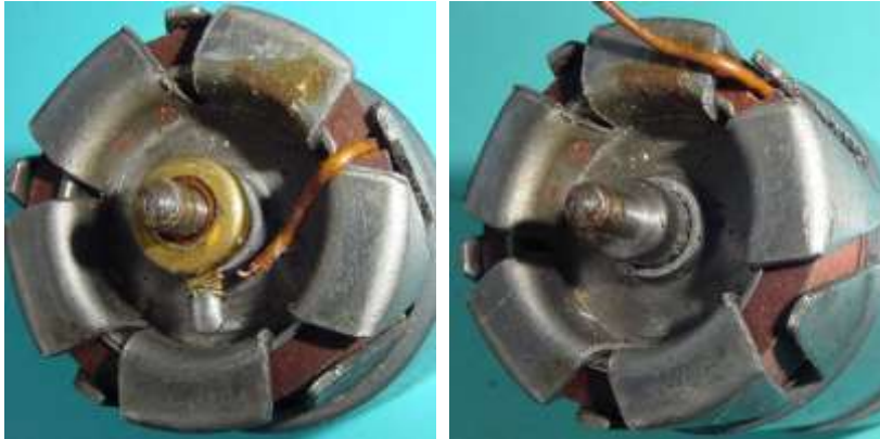
Bild 7.26: Wellenzapfen mit Spannung führendem Anschluss
