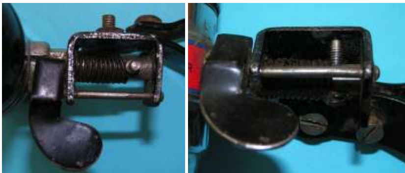
Bild 2.57: Rundstab als Drehachse für das Fußpedal
