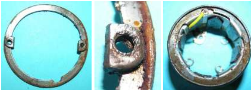
Bild 12.15: Stegtring: a) Ring mit zwei Gewindelöchern, b) Lasche mit Gewindeloch, c) Anker ohne Steg-ring
