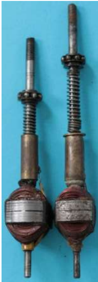
Bild 2.50: Ankergeometrien: a) Unbeschrifteter Anker mit Schraubverbindung, b) RAPID
