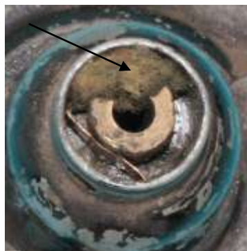
Bild 2.12: Lagerschmierung: a) Ölbohrung im Lagerhals, b) Unvollständiger Ölfilz , c) Ausgeschnittenes Lagerrohr und Blecheinlage hinter der Ölbohrung
