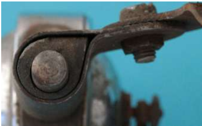
Bild 17.6: Behelfsmäßige Schelle zur Befestigung des Halters an der Kippvorrichtung
