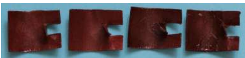
Bild 4.20: Vier Isolierelemente für die Wicklungsköpfe auf jeder Stirnseite des Ankers
