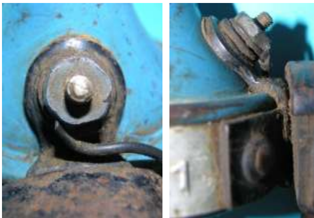
Bild 10.5: T-Flansch zur Befestigung der Kippvorrichtung am Lagerhalstopf
