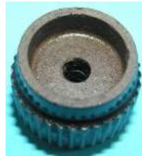
Bild 5.35: Reibrad aus Duroplast: a) Versenkte Schlitzmutter, b) Raum für die Schlitzmutter, c) Raum für den Lagerhalskopf
