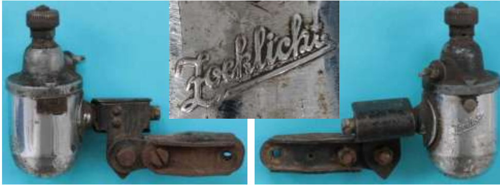
Bild 2.27: Zweipoliger Dynamo mit Tulpenmagnet
