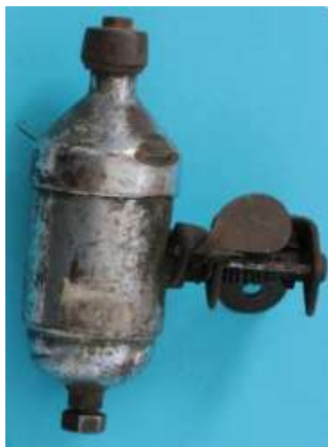
Bild 2.30: Dynamos mit Drahtfederverbindung; a) Rapid, 1,8 W, massiver Basiskörper der Kippvorrichtung, b) Kippvorrichtung mit Fußpedal
