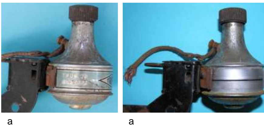
Bild 6.8: Gehäusentrennung a) Gehäusemantel mit Zierband, b) Trennspalt zwischen Lagerhalstopf und Bodentopf
