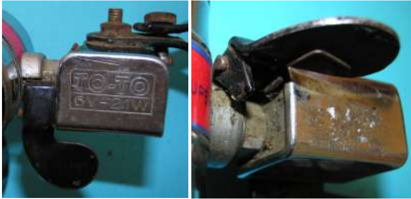
Bild 2.56: Kippvorrichtung in der Ruhestellung: a) Klinke in der Nut, b) Feder zum Einklinken in die Ruhestellung
