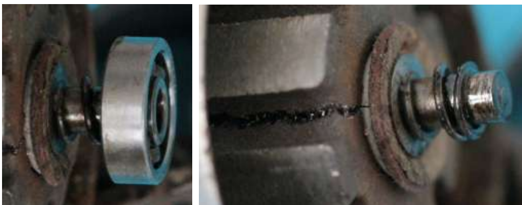
Bild 9.9: Axialspielausgleich: a) Unteres Kugellager, b) Schraubenfeder für den Axialspielausgleich
