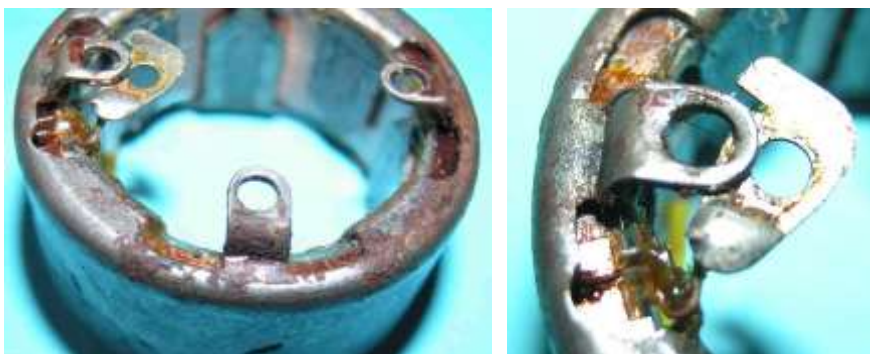
Bild 12.13: Masseanschluss: a) Oberer Ankerseite, b) Spulenanschluss mit Kabelschuh
