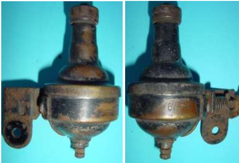
Bild 7.6: King 1: Zweiteiliges Messing- gehäuse
