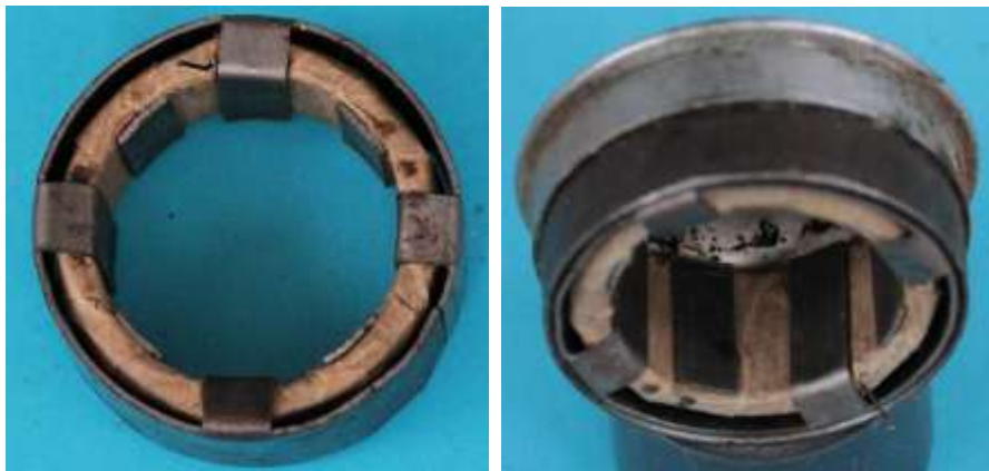
Bild 9.6: Anker: a) Klauenpolanker, b) Klauenpolanker mit Zusatzjoch
