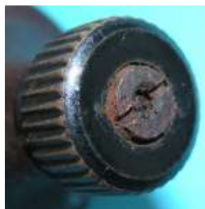
Bild 5.3: Befestigung der Reibräder: a) Reibrad mit einer Mutter gekontert (Bild 5.1a), b) Sicherung des Reibrades mit einem Splint (Bild 5.1b), c) Versenkte Kontermutter (Bild 5.1c) im Kunststoffreibrad
