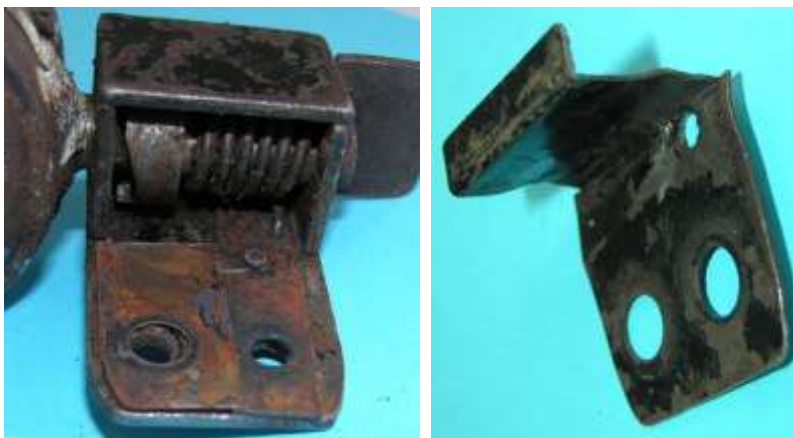
Bild 5.30: Einzelteile: a) Blattfeder b) Abdeckblech
