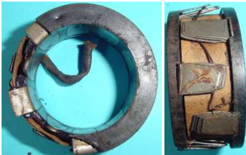
Bild 5.11: Ankerwicklung mit Klauenpolschuhen: a) Spannung führender Anschluss, b) Masseanschluss
