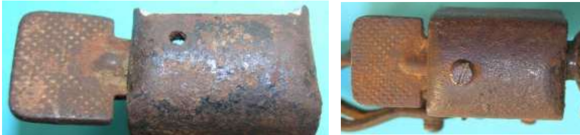
Bild 5.21: Gewindebohrung im Basisblech zur Fixierung der Rückstellfeder
