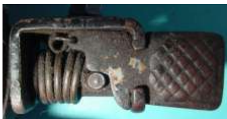
Bild 7.21: Zwei Stellungen der Kippvorrichtung: a) Arretierungsstellung, b) Arbeitsstellung
