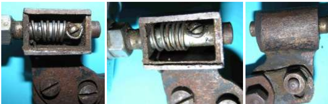
Bild 2.36: Kippvorrichtung: a) Ruhstellung, b) Betriebsstellung, c) Massiver Basiskörper
