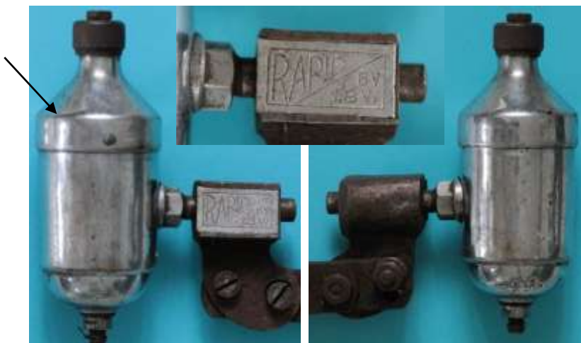
Bild 2.33: Dynamo mit Drahteinzug und massivem Basiskörper der Kippvorrichtung
