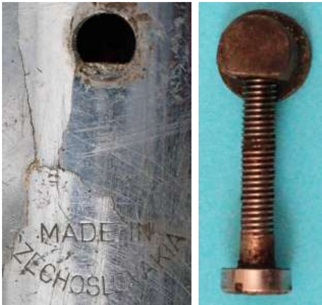
Bild 2.21: Schraubverbindung: a) Bohrung im Gehäusemantel mit flacher Seite, b) Gewindebolzen und Gegenstück mit Bund und radialer Gewindebohrung
