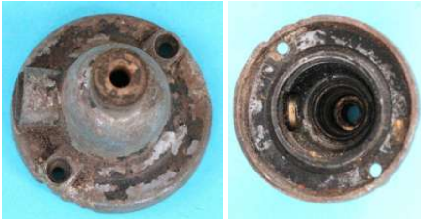
Bild 2.22: Lagerhals: a) Stützen für den Spannung führenden Anschluss, b) Lagerschale und Bürstenhalter
