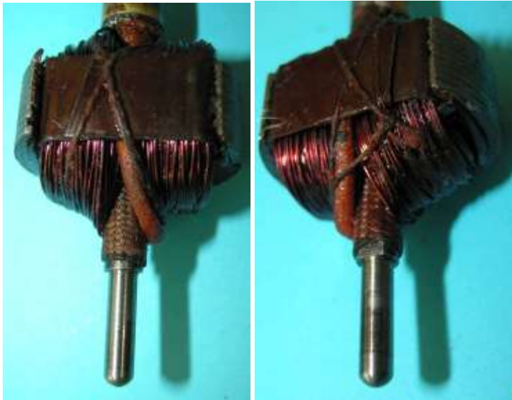
Bild 2.65: Einseitige Fläche auf der Welle: a) Runde Seite, b) Abgeflachte Seite
