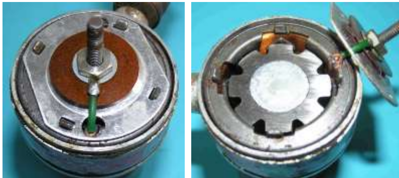
Bild 12.21: Demontierter Boden a) Kontaktplatte mit Kabelanschlussbolzen b) Anker und Polrad im Lagerhalstopf
