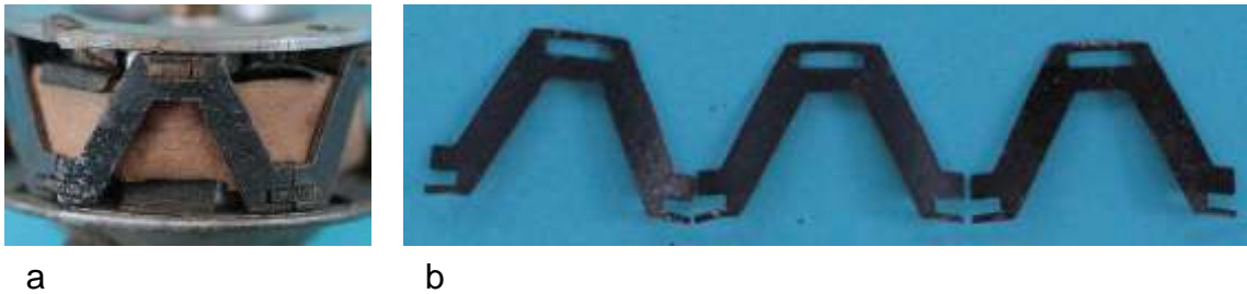
Bild 8.5: V-förmige Elemente des Ankerjochs: a) Fünf Ankerjochblechpakete verbinden die geblechten Klauenpole, b) Aneinanderreihung der Ankerjochblechpakete
