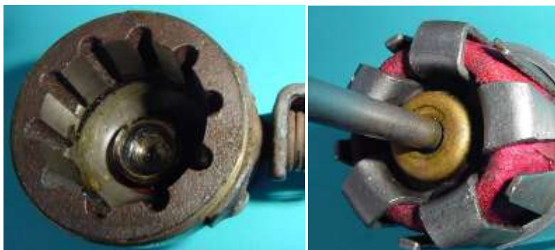
Bild 7.2: Elektromagnetisch aktive Baugruppen, Polrad und rotierender Klauenpolanker
