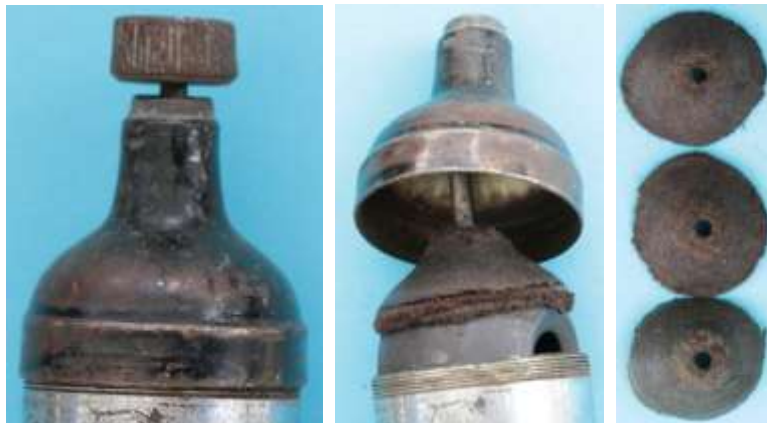
Bild 2.46: Gehäuseteile, a) Lagerhals und Gehäuse- topf mit Feingewinde ver- schraubt b) Jochbogen mit Filz abge- deckt, c) Drei Filzmatten
