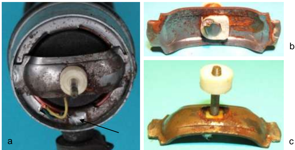
Bild 15.9: Kontaktsteg: a) Eingeklinkt in den Langlöchern des Lagerhalstopfes, b) Isolierter Einsatz für den Kabelanschlussbolzen, c) Kunststoffmutter zur Befestigung des Kabelanschlussbolzens
