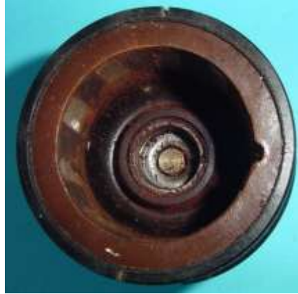
Bild 7.39: Zwei Ausführungen des Bodentopfes mit Lager- schale und Kabel- anschlussbolzen a) Bateria 52 b) Daimon 52
