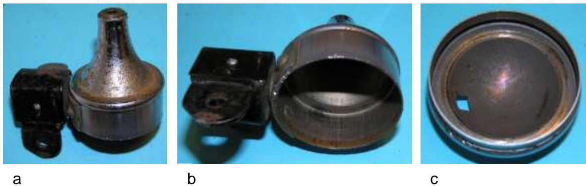
Bild 11.7: Stahlgehäuse: a) Lagerhalstopf mit Kippvorrichtung, b) Innenraum des Lagerhalstopfes, c) Boden
