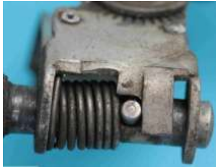
Bild 17.23: Positionen des Sperrstiftes: a) Ruhestellung, b) Betriebsstellung
