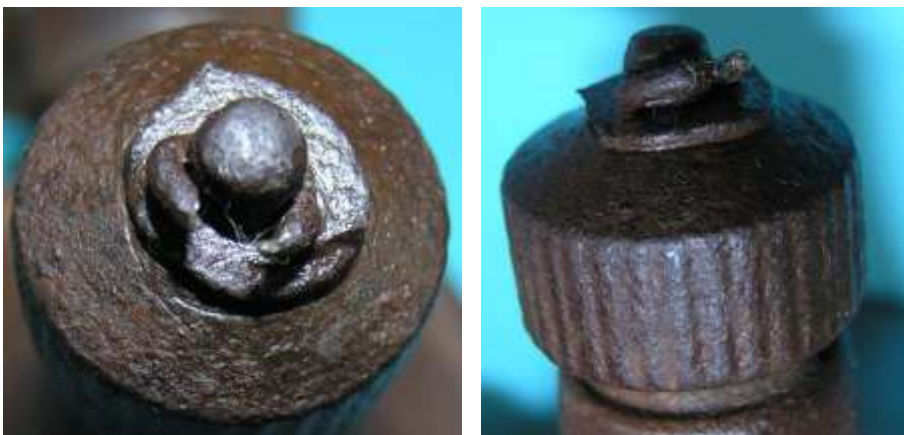
Bild 5.17: Splint zur Sicherung des Reibrades
