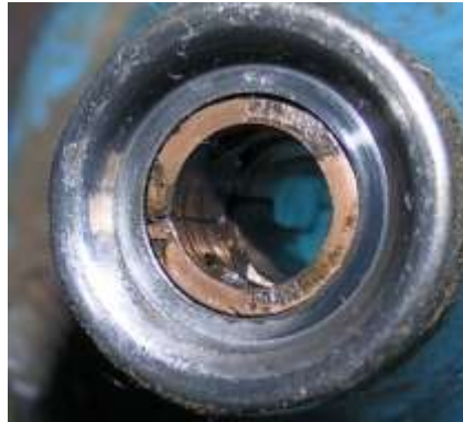
Bild 10.13: Gleitlager mit ineinander verzahnter Rohrnaht
