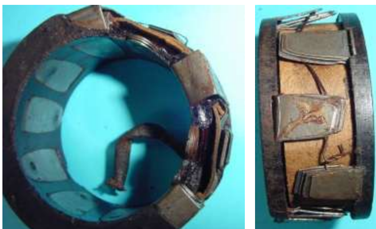
Bild 1.10: Anker mit tangential geblechten Polen a) Eingegossene Polschuhe b) Berührungsflächen mit dem ferromagnetischen Gehäuse
