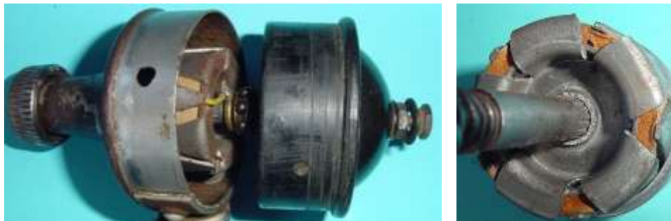
Bild 7.33: Baugruppen: a) Herausgezogener Bodentopf, b) Klauenpolanker
