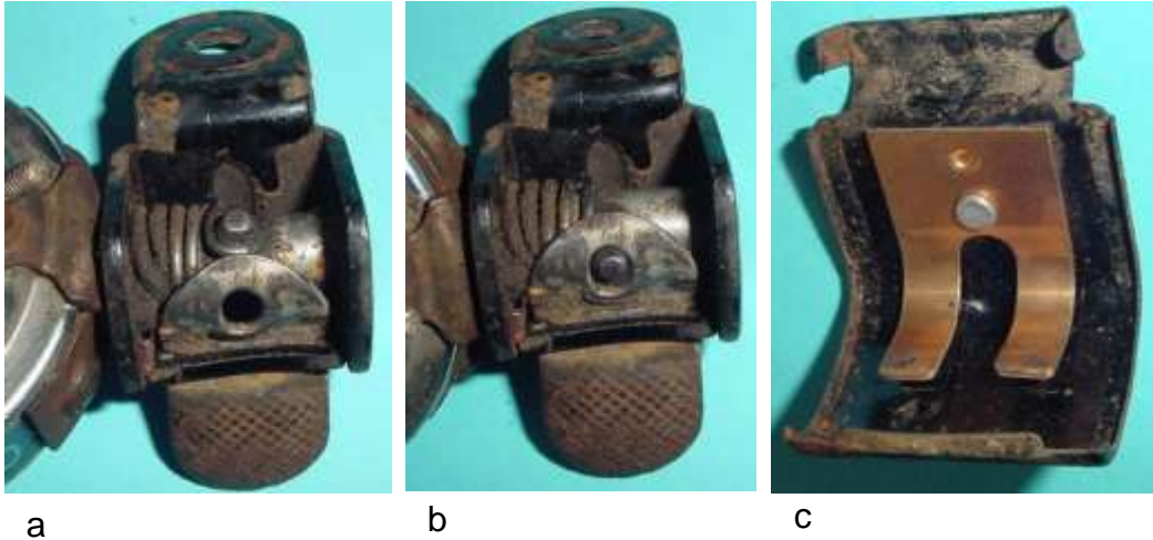
Bild 11.23: Abdeckung der Kippvorrichtung entfernt: a) Befestigung der Druckfeder am Sperrstift, b) Bohrung des Bedienungshebels im Eingriff mit dem Sperrbolzen, c) Angenietete Rückstellfeder
