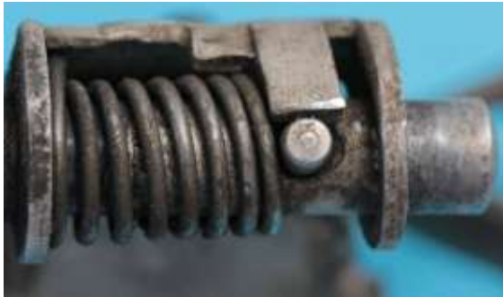
Bild 17.23: Positionen des Sperrstiftes: a) Ruhestellung, b) Betriebsstellung
