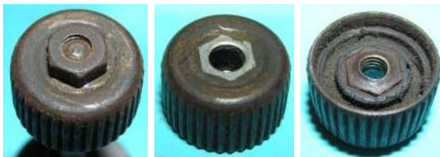
Bild 15.13: Stahlreibrad: a) Reibrad mit Kontermutter, b) Eingegossenes Gewindestück, c) Unterseite
