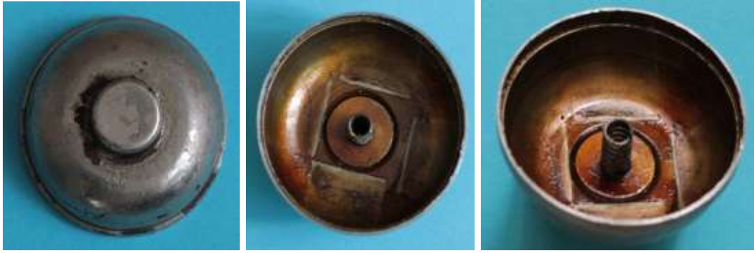
Bild 4.17: Boden: a) Ausstülpung des Lagersitzes, b) Innenseite des Bodens, c) Feder für den Axialspielausgleich
