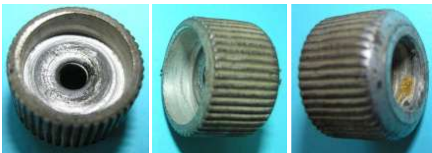
Bild 18.2: Reibrad: a) Unterer Raum zum Schutz des Lagers, b) Lauffläche, c) Oberer Raum zum Versenken der Kontermutter
