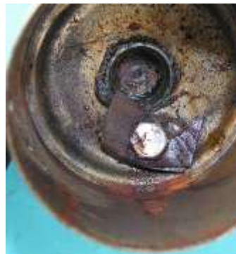
Bild 5.36: Anker: a) Masseanschluss, b) Untere Lagerschale und Spannung führender Ka- belanschlussbolzen
