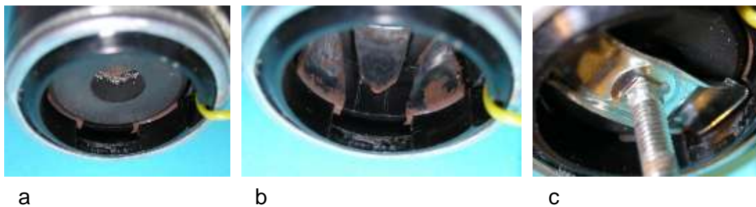
Bild 13.5: Einfügen des Stegs unter dem Abschlussring aus Duroplast: a) Polrad lässt die Lücke für den Steg frei, b) Ankerpole und Steglücke, c) Eingesetzter Steg
