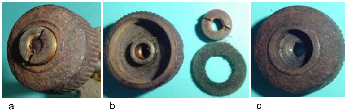
Bild 11.20: Reibrad: a) Reibrad und versenkte Kontermutter, b) Filzkammer des Reibrades mit Filz und Schlitzmutter, c) Raum für die Kontermutter
