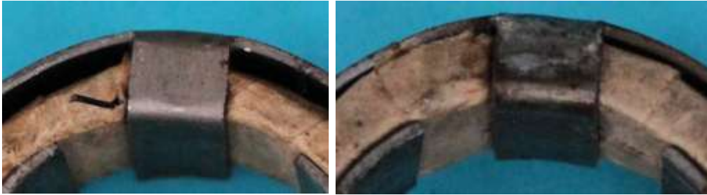
Bild 9.7: Spulenanschlüsse: a) Drahtende zum Kabelanschlussbolzen, b) Lötstelle für den Masseanschluss
