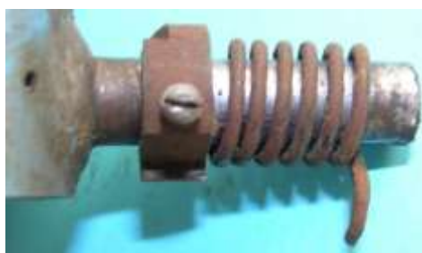
Bild 5.23: Drehbolzen: a) Schweißnaht am Gehäusemantel, b) Druckfeder und Kulissenscheibe
