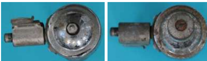
Bild 17.11: Gehäusegestaltung: a) Bodenansicht, b) Lagerhals und Reibrad
