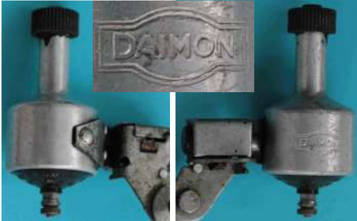
Bild 1.5: Daimon-Dynamo mit einem UNION-Körper und der Kippvorrichtung von Daimon
