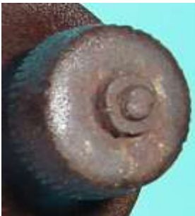
Bild 5.3: Befestigung der Reibräder: a) Reibrad mit einer Mutter gekontert (Bild 5.1a), b) Sicherung des Reibrades mit einem Splint (Bild 5.1b), c) Versenkte Kontermutter (Bild 5.1c) im Kunststoffreibrad
