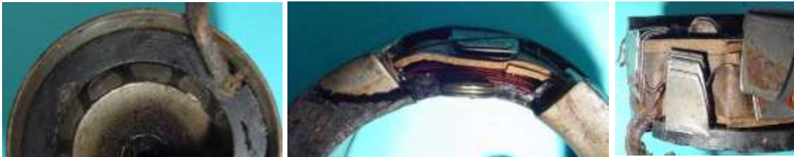
Bild 5.9: Ankerspule mit Klauenpolschuhen
