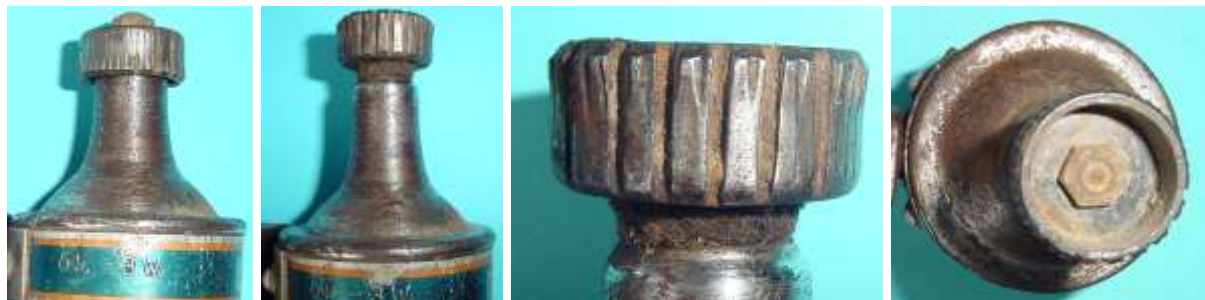
Bild 7.38: Drehung des Reibrades zur Verbesserung der Drehmomentübertragung
