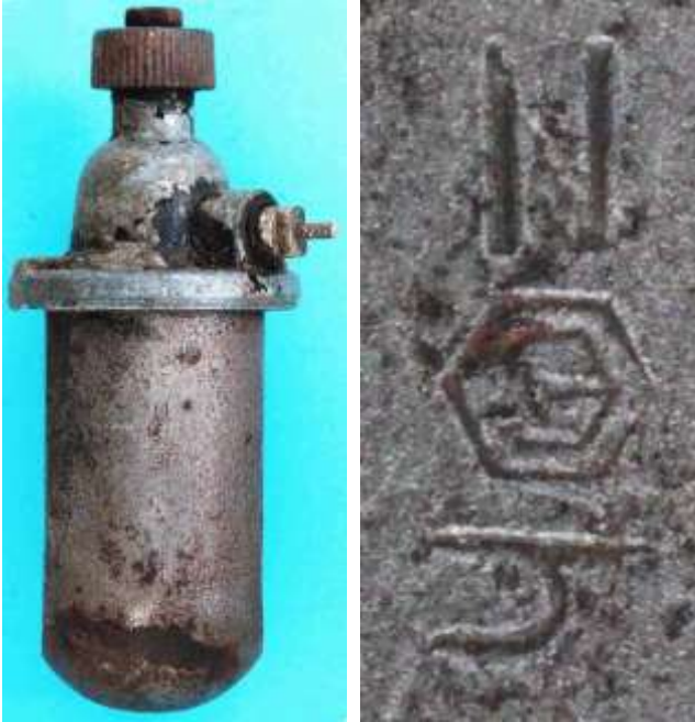
Bild 2.20: Kennzeichnung des Dauermagneten (310 g) mit Firmenlogo, N für Nordpol und einem gedrehten h
