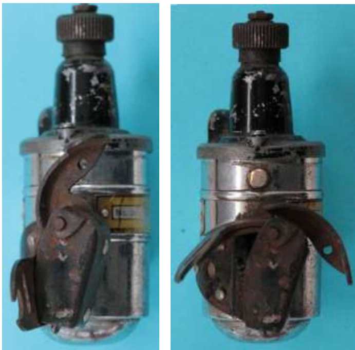
Bild 2.7: Kippvorrichtung: a) Ruhestellung b) Betriebsstellung
