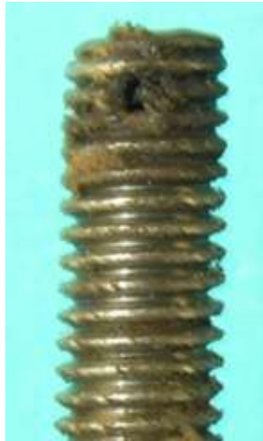
Bild 5.2: Reibradsicherung a) Splint und Scheibe über dem Reibrad b) Bohrung in der Welle
