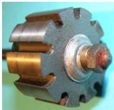
Bild 8.10: Polrad: a) Obere Stirnseite, b) untere Stirnseite
