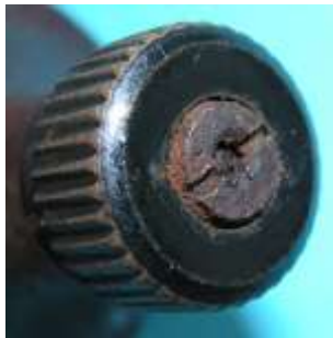
Bild 5.35: Reibrad aus Duroplast: a) Versenkte Schlitzmutter, b) Raum für die Schlitzmutter, c) Raum für den Lagerhalskopf
