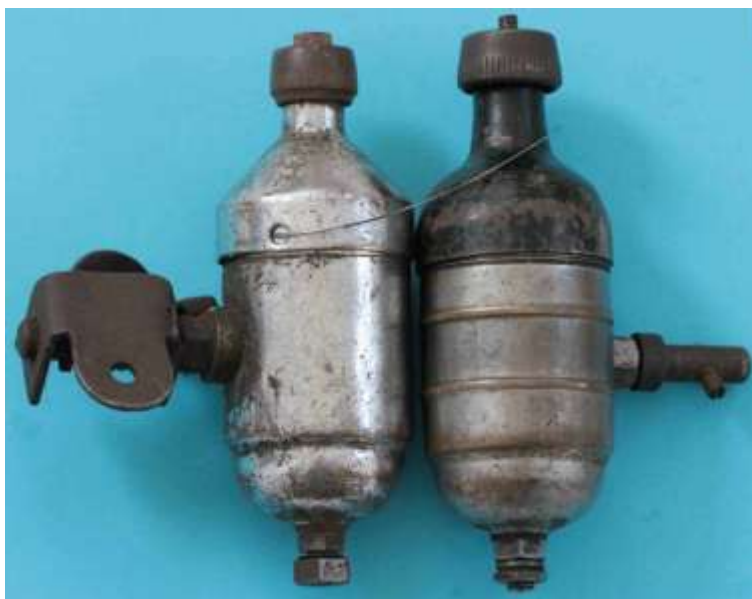
Bild 2.41: Unbeschriftete Dynamos: a) Mit Drahtfederverbindung b) Mit Schraubverbindung
