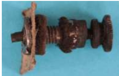
Bild 2.11: Spannung führender Kontakt: a) Kabelanschluss, b) Bürstenhalter und Kabelanschlussbolzen, c) Kupferbürste mit Druckfeder
