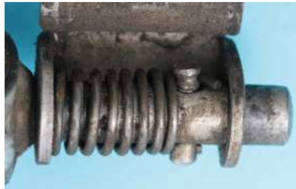
Bild 17.24: Kippvorrichtung: a) Nieten zu Befestigung des Abdeckblechs, b) Druckfeder mit Sperrstift
