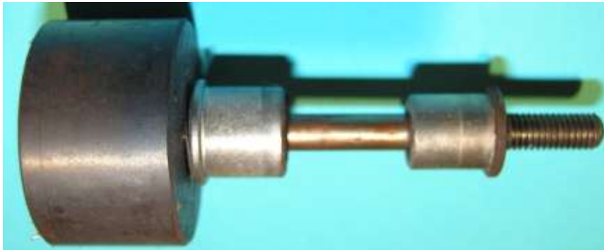
Bild 15.11: Polrad mit Gleitlager. Durchmesser 12 mm und 10 mm, Wellendurchmesser 5 mm, Magnetdurchmesser 30 mm
