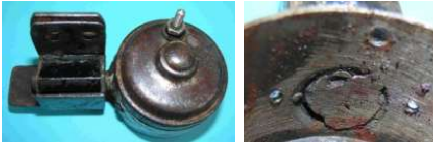
Bild 5.32: Drehbolzen: a) Außen kein Flansch, b) Verputzte Schweißstelle
