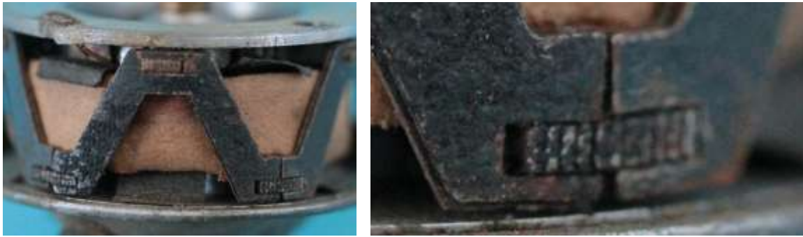
Bild 1.11: Polschuhe radial geblecht mit meanderförmigem Ankerjoch
