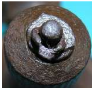
Bild 5.3: Befestigung der Reibräder: a) Reibrad mit einer Mutter gekontert (Bild 5.1a), b) Sicherung des Reibrades mit einem Splint (Bild 5.1b), c) Versenkte Kontermutter (Bild 5.1c) im Kunststoffreibrad
