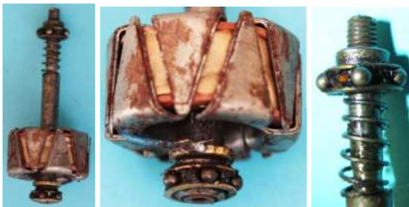
Bild 17.21: Läufer: a) Klauenpolanker mit Welle und Kugellagern, b) Anker mit isoliertem Kugellager, c) Feder für den Axialspielausgleich und verschiebbares Kugellager
