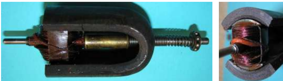
Bild 2.67: Position des Ankers zwischen den Polschuhen: a) Seitenansicht, b) Stirnansicht
