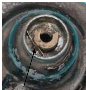
Bild 2.12: Lagerschmierung: a) Ölbohrung im Lagerhals, b) Unvollständiger Ölfilz , c) Ausgeschnittenes Lagerrohr und Blecheinlage hinter der Ölbohrung
