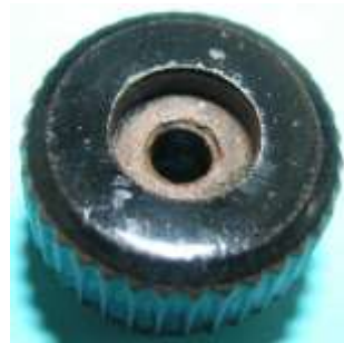
Bild 5.35: Reibrad aus Duroplast: a) Versenkte Schlitzmutter, b) Raum für die Schlitzmutter, c) Raum für den Lagerhalskopf
