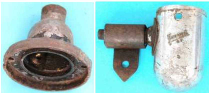
Bild 2.17: Gehäuse: a) Lagerhals aus Aluminiumguss, b) Gehäusetopf aus Messing mit angenietetem Flansch
