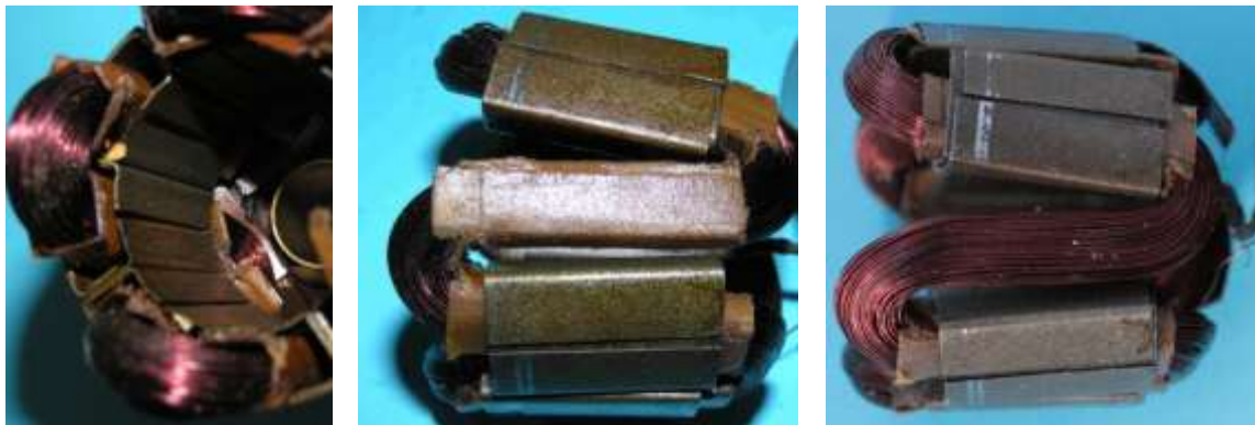
Bild 4.24: Aufbau des Ankers: a) Polflächen, b) Drei Blechelemente einer Spulenseite entfernt, c) Spulenseite
