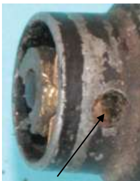
Bild 2.12: Lagerschmierung: a) Ölbohrung im Lagerhals, b) Unvollständiger Ölfilz , c) Ausgeschnittenes Lagerrohr und Blecheinlage hinter der Ölbohrung
