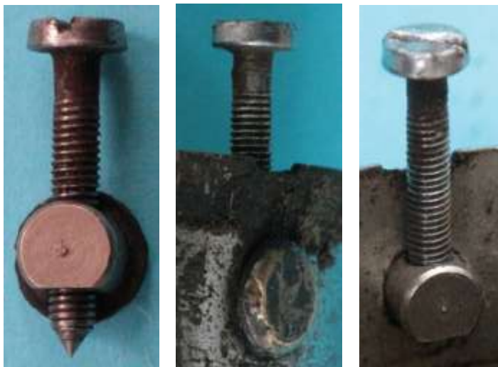
Bild 2.8: Schraubverbindung des Lagerhalses mit dem Gehäusetopf
