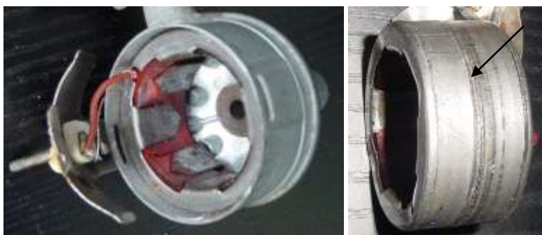
Bild 15.4: Klauenpolanker: a) Eigepresst im Lagerhalstopf, b) Trennlinie zwischen den Klauenpolkränzen
