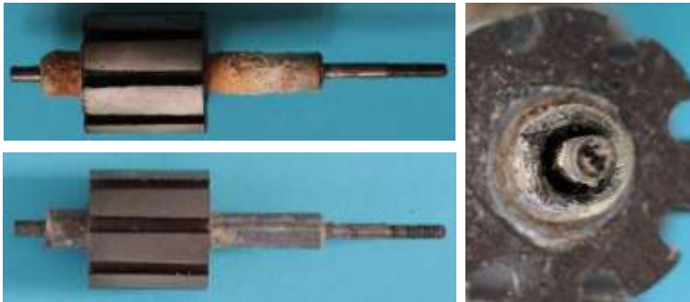
Bild 4.18: Mit Zinn eingegossenes Polrad a) Zinnflächen mit Zinnschwamm belegt und gesäubert b) Zinnhülse am unteren Wellenende
