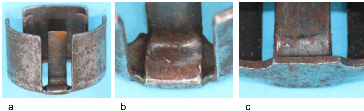
Bild 3.12: Zweifache Abwinklung des Polschuhs: a) Gesamtansicht des Polschuhs, b) Ansicht der Biegezone von außen, c) Ansicht vom Innenraum
