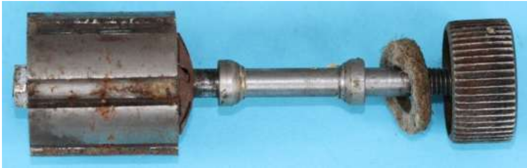
Bild 3.9: Welle mit Polrad, verschiebbaren Konen, Fettdepot und Reibrad
