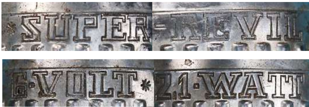
Bild 3.2: Umlaufendes Schriftband mit der Markenbezeichnung „REVIL“, der Typenbezeichnung „SUPER“ und den Nenndaten 6 Volt und 2,1 Watt
