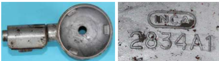
Bild 3.5: Innenraum der Bodenschale: a) Stützen für den Anker, b) Schriftzug INKA mit der Werkzeugnummer
