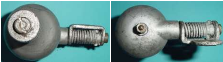
Bild 2.5: Äußere Elemente a) Reibrad, b) Kabelanschluss
