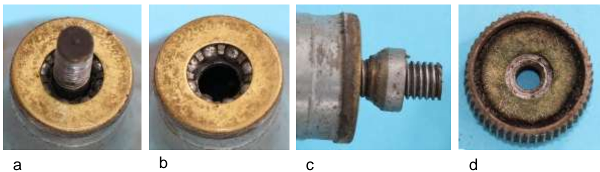
Bild 3.7: Oberes Kugellager: a) Lager mit Welle, b) Lager mit Messingkappe, c) Verschiebbarer Konus
