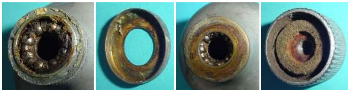
Bild 2.9: Oberes Kugellager: a) Kugellager, b) Abdeckung des Kugellagers, c) Aufgedrückte Abdeckung, d) Fettdepot im Reibrad
