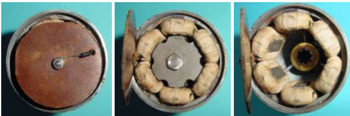
Bild 2.7: Ankerwicklung: a) Anschlussstützpunkt der Wicklung, b) Wicklungsköpfe der Ankerwicklung und Stirnseite des Polrades, c) Ankerbohrung mit dem Blick auf das untere Kugellager
