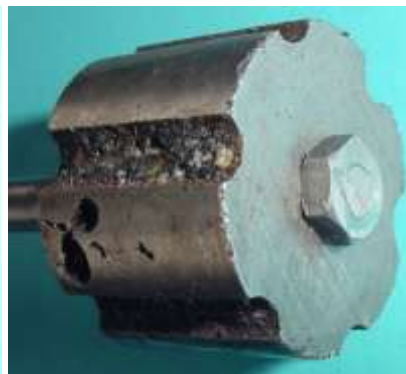
Bild 2.11: Lunker im Magnetmaterial des Polrades
