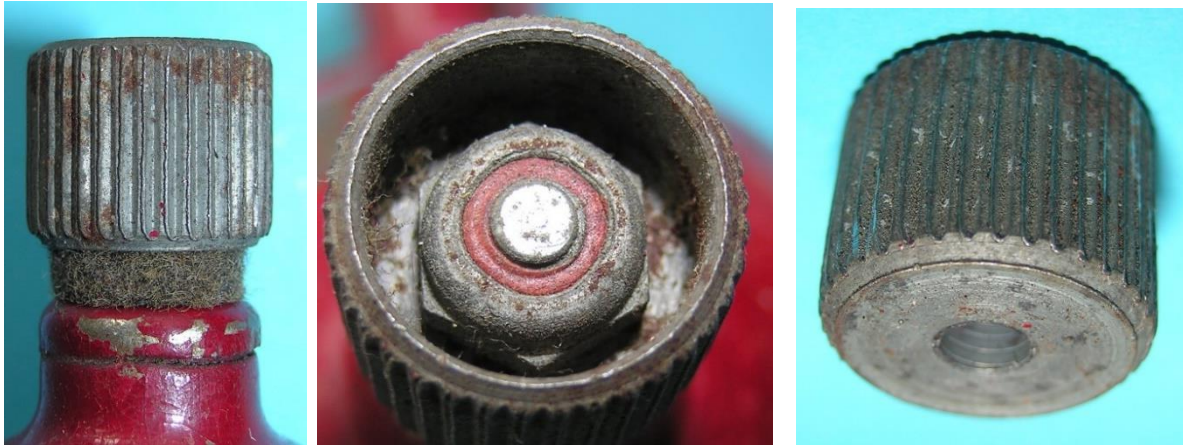
Bild 3.24: Reibrad: Durchmesser 16 mm, Länge 13 mm: a) Filzring zwischen Gleitlager und Reibrad, b) Versenkte Kontermutter, c) Ebene Fläche auf der Unterseite
