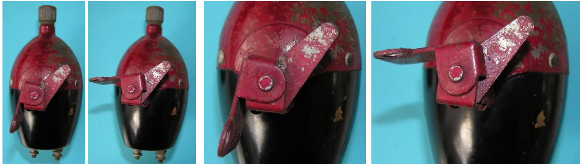
Bild 3.11: Stellungen der Kippvorrichtung: a) Ruhestellung, b) Betriebsstellung
