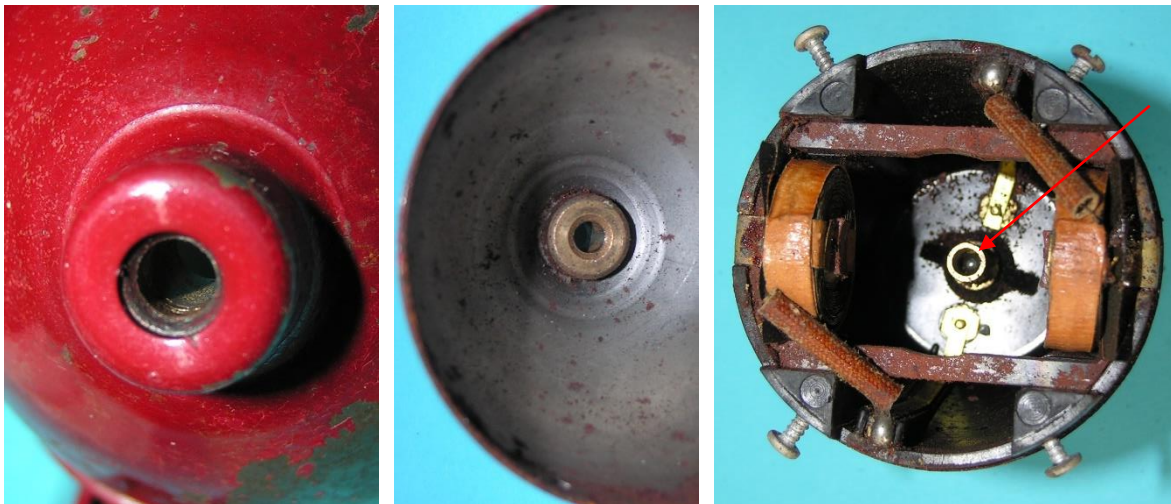
Bild 3.25: Lagerung: a) und b) Gleitlager im Lagerhals, c) Spurlager im Boden
