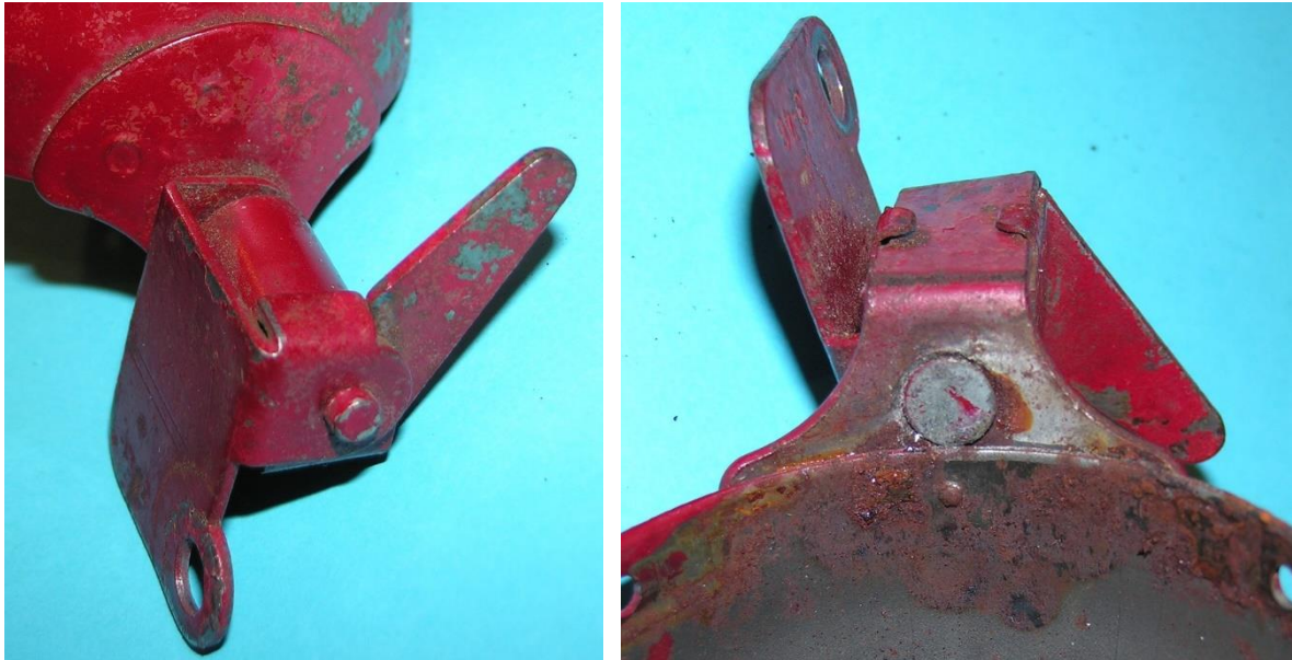
Bild 3.5: Angeschweißter Flansch der Kippvorrichtung
