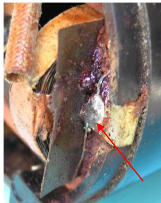
Bild 3.19: Kontakte: a) Am Polschuh angelegtes Masseblech, b) Lötstelle an der Kontaktstelle mit dem Lagerhalstopf, c) Leiterbahn zwischen dem Kabelanschlussbolzen und dem Spulenende
