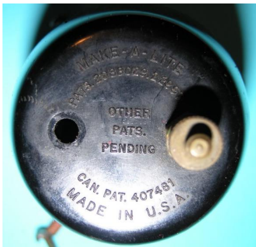
Bild 1.2: Im Werkzeug eingearbeitete Informationen: Markenname, Produktionsstandort, Patenthinweise
