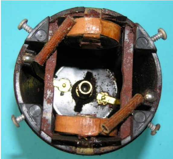
Bild 3.17: Anker: a) Blechpaket mit ausgeprägten Polen und zwei Ankerspulen, b) Blechpaket aus 6 Blechen der Stärke 0,7 mm stark
