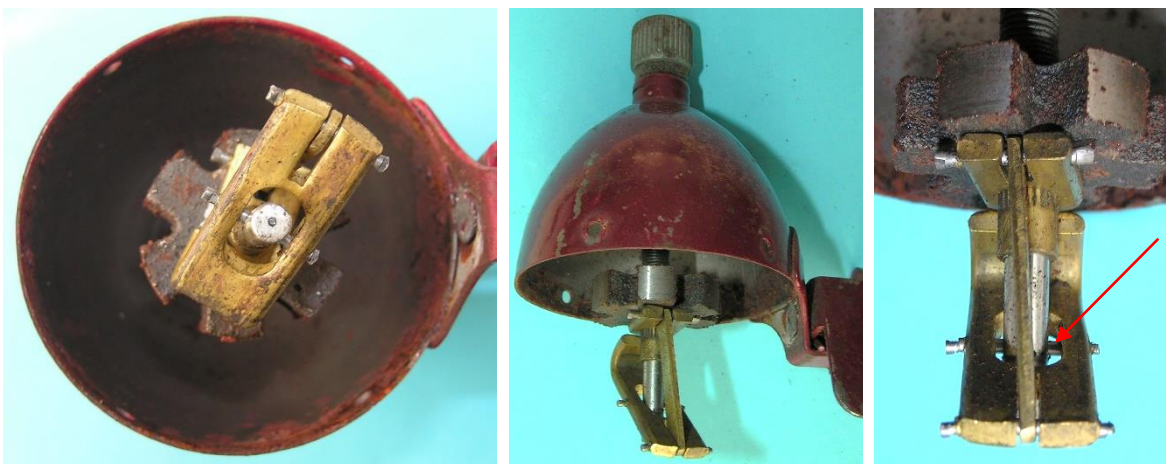
Bild 3.12: Fliehkraftregler: a) Polrad mit Fliehkraftregler im Lagerhalstopf, b) Axiale Länge im Vergleich zum Lagerhalstopf, c) Befestigung des Reglers an der Welle
