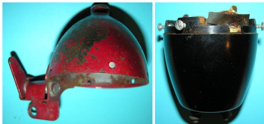
Bild 3.2: Lagerhalstopf und Bodentopf bilden das Gehäuse
