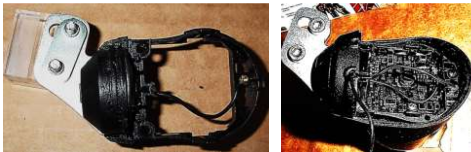
Bild 2.8: a) Montage- rahmen mit Kippvorrich- tung, b) Fixierung der Leiterplatte mit dem Mon- tagerahmen
