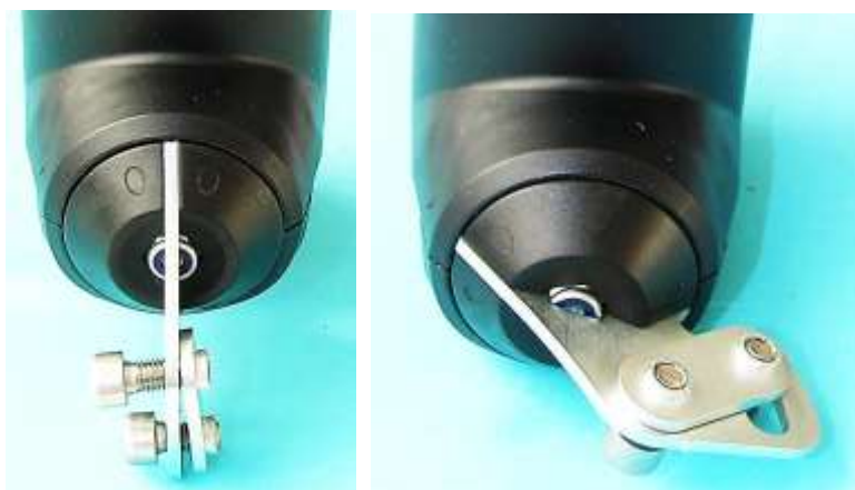
Bild 2.12: Maximaler Verdrehwinkel: a) Ruhestellung b) Betriebsstellung
