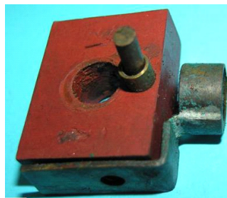
Bild 1.24: Vinidurblock mit den Kontaktelementen: a) Masseverbindung der Lampenfassung mit dem Magneten, b) Holzschraube, c) Bürste mit Bürstenhalter, d) Fußkontakt und Lampenfassung
