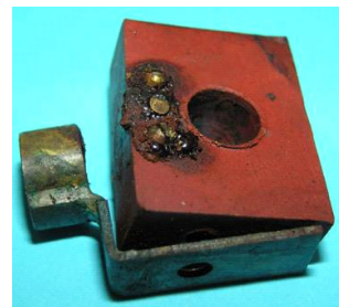
Bild 1.24: Vinidurblock mit den Kontaktelementen: a) Masseverbindung der Lampenfassung mit dem Magneten, b) Holzschraube, c) Bürste mit Bürstenhalter, d) Fußkontakt und Lampenfassung
