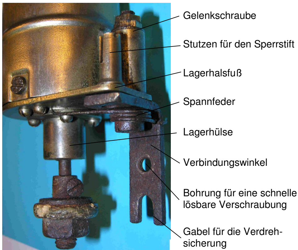
Bild 1.6: Konstruktionselemente am Lagerhalsfuß
