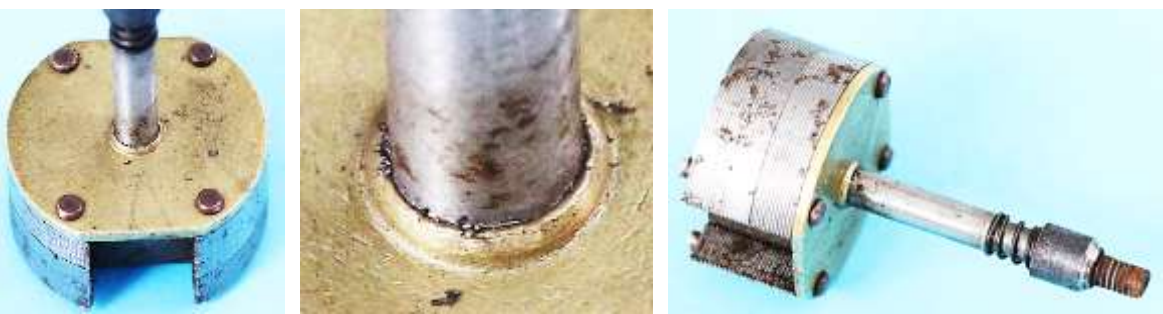
Bild 2.11: Befestigung der Welle senkrecht auf der oberen Messingplatte
