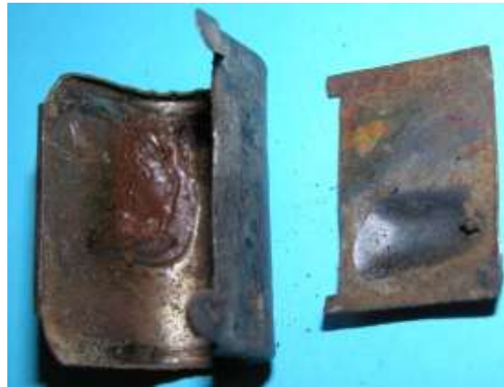
Bild 2.13: Abdeckung der Kippvorrichtung a) Basisblech, b) Backblech c) Schutzblech für die Kulissenbahn
