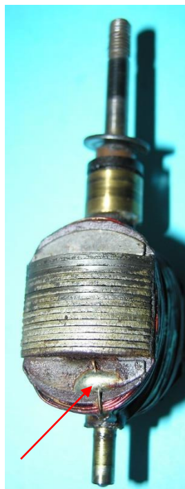
Bild 7.9: Anker: a) Position des Ankers im Tulpenmagnet, b) Blechpaket mit 15 Blechen der Stärke 1 mm, c) Spulenseiten der Ankerwicklung
