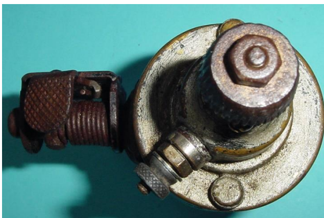
Bild 1.26: Am Lagerhalsfuß angehängter Gehäusetopf: a) Abgedeckte Schlitzmuttern auf dem Lagerhalsfuß, b) Am Gehäusetopf angenietete Gewindebolzen
