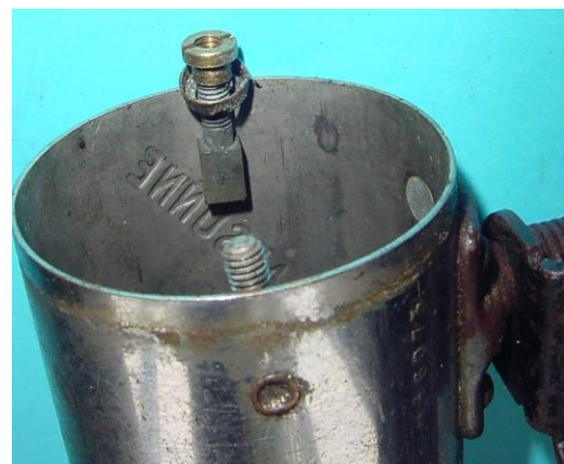
Bild 1.26: Am Lagerhalsfuß angehängter Gehäusetopf: a) Abgedeckte Schlitzmuttern auf dem Lagerhalsfuß, b) Am Gehäusetopf angenietete Gewindebolzen
