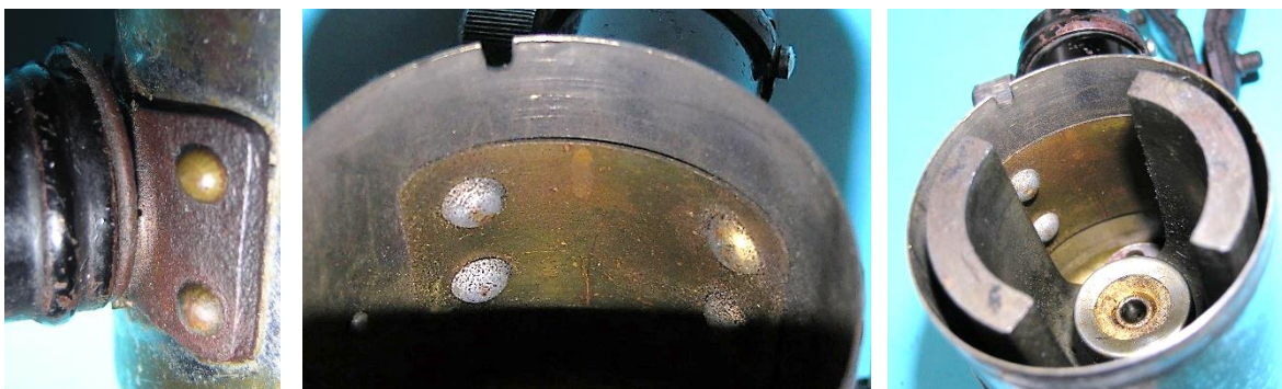
Bild 7.11: Flanscbefestigung mit erhabenen Nietköpfen und einem Zusatzblech: a) Außerhalb des Gehäuses, b) Innerhalb des Gehäusetopfes, c) Raum zwischen der Gehäusewand und dem Magneten für die Nietköpfe
