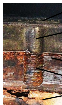
Bild 3.28: Verwendung der Setznut für die Verdrehsicherung der Lagerschale
