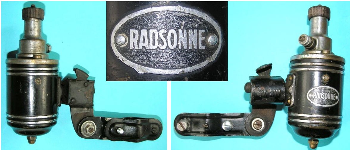
Bild 6.46: Radsonne Typ 62S mit einteiligem Flansch und den Nenndaten auf dem Abdeckblech der Kippvorrichtung
