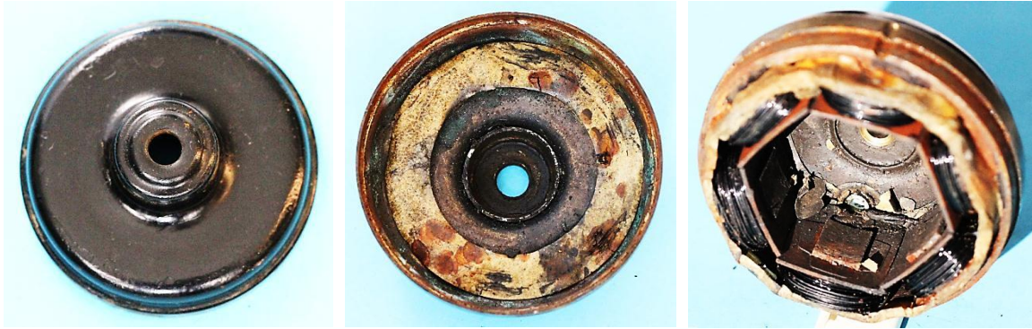
Bild 3.26: Obere Lagerschale Anker in der unteren Lagerschale
