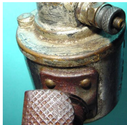
Bild 6.9: Befestigung des einteiligen Flansches Gestaltung mit vier Nieten
