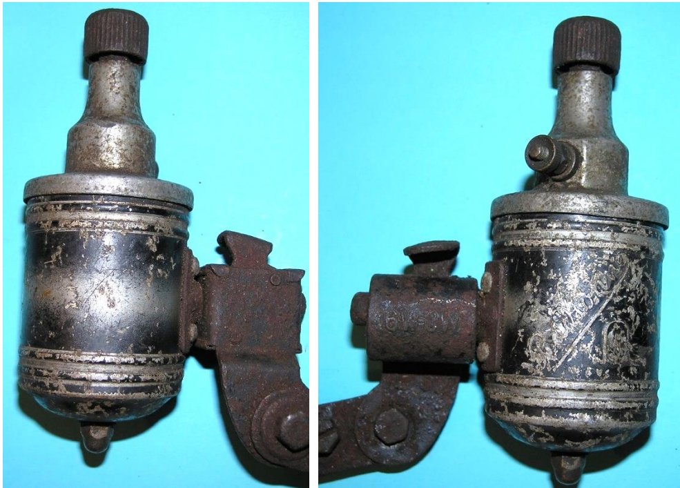
Bild 9.16: Dynamo mit rundem Lagerhalsumlauf und eingepprägter Beschriftung im Gehäusemantels (Originalreibrad ist ausgetauscht)
