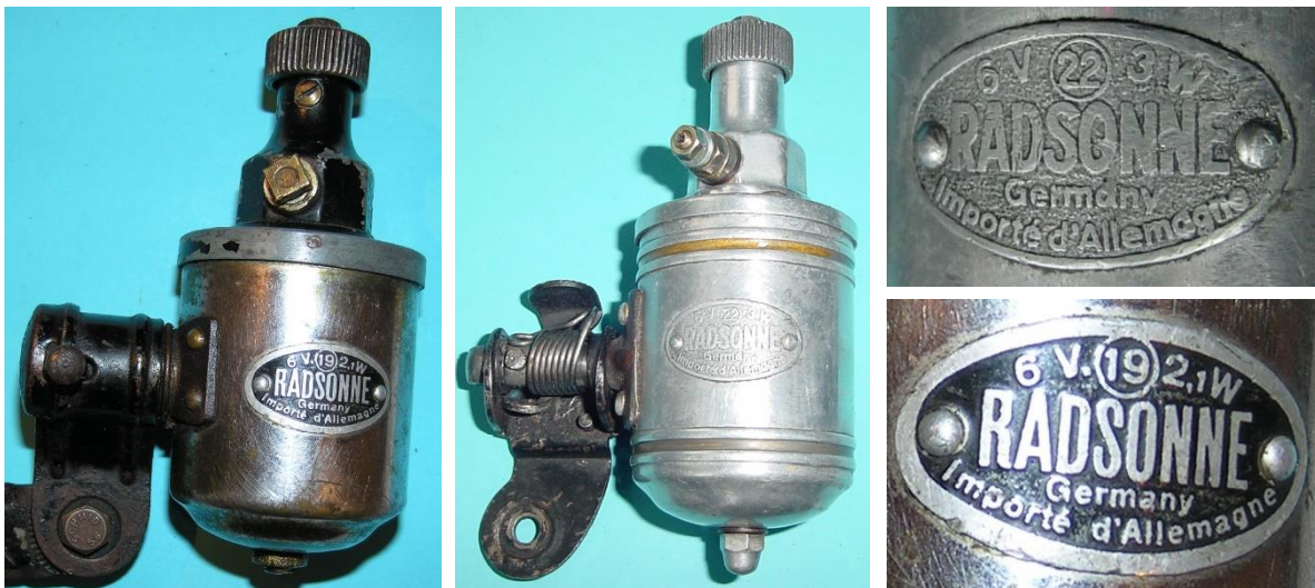
Bild 1.16: Im Kreis eingeschlossene Typennummern zwischen den Nenndaten
