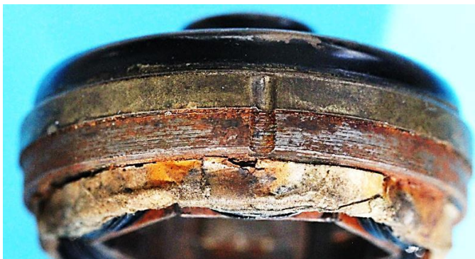
Bild 3.28: Verwendung der Setznut für die Verdrehsicherung der Lagerschale
