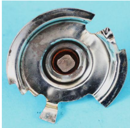
Bild 11.27: Spannung führender Anschluss: a) Kabelbolzen mit Lötstützpunkt, b) Oberseite der Kontaktplatte mit isoliert eingesetztem Kabelbolzen
