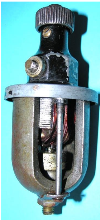
Bild 7.9: Anker: a) Position des Ankers im Tulpenmagnet, b) Blechpaket mit 15 Blechen der Stärke 1 mm, c) Spulenseiten der Ankerwicklung
