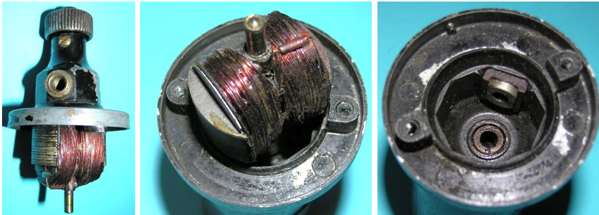
Bild 7.12: Lagerhals: a) Lagerhals mit verschlossener Ölbohrung und der Bohrung für den Bürstenhalter mit Kabelanschlussbolzen, b) Ankerwellenende mit Axiallagerkugel, c) Innere Konturen des gegossenen Lagerhalses
