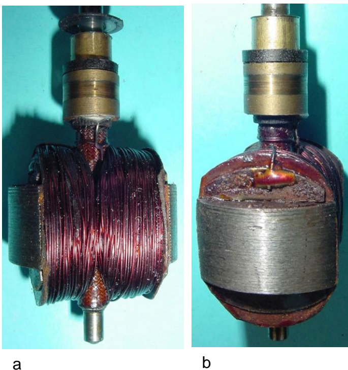
Bild 6.17: Spulenanschlüsse: a) Verbindung mit dem Schleifring b) Masseverbindung mit dem abgewinkelten Ankerendblech, Ankerdurchmesser: 32 mm, Blechpaketlänge: 15 mm
