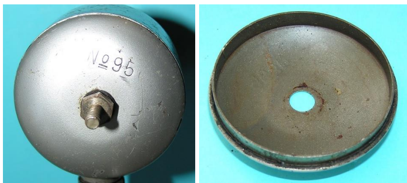
Bild 11.11: Beschriftungen: a) Am Boden eingeprägte Typennummer, b) Rand des Stahlbodens
