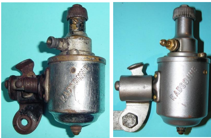
Bild 6.1: Dynamomas mit schräggestelltem Markennamen in Druckbuchstaben und massivem Drehbolzen
