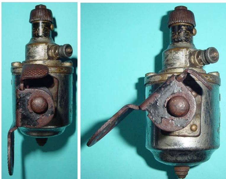
Bild 6.11: Maximale Verdrehung des Dynamokörpers: a) Ruhestellung b) Betriebsstellung
