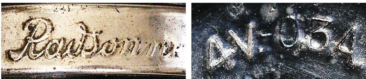
Bild 3.21: Beschriftungen: a) Markenname auf dem Spannband, b) Nenndaten im Boden eingeprägt
