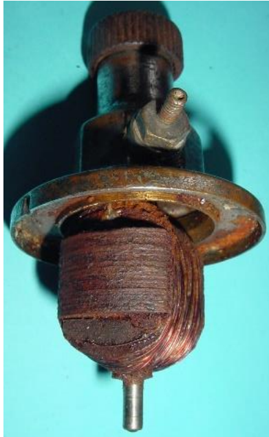
Bild 8.15: Anker mit Lagerhals: a) Ankerwicklung in der Pollücke, b) Polschuh
