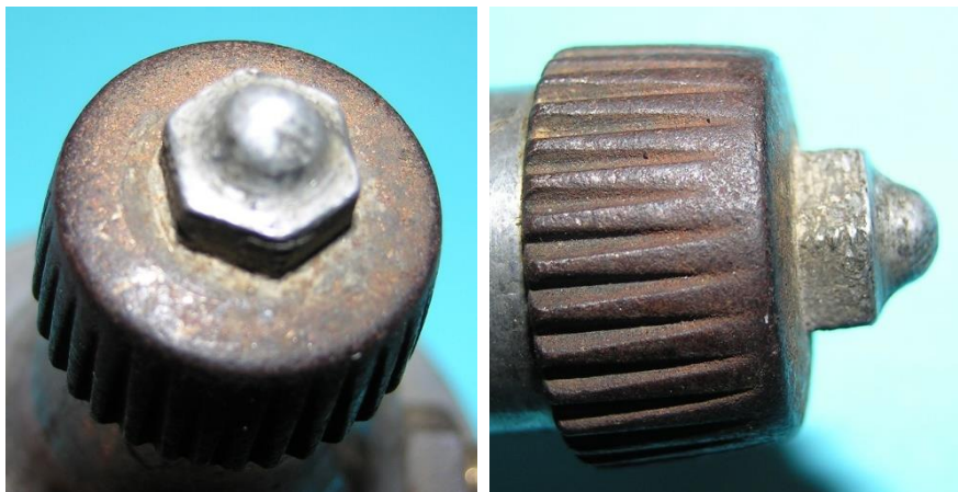
Bild 9.15: Befestigung des Reibrades mit einer Hutmutter
