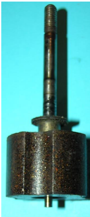
Bild 10.7: Polrad: Durchmesser 30 mm, Länge 20 mm, a) Pollücke zwischen den Polflächen, b) Stirnflächen des Walzenmagneten mit der gewölbten Lagerfläche auf dem Wellenende
