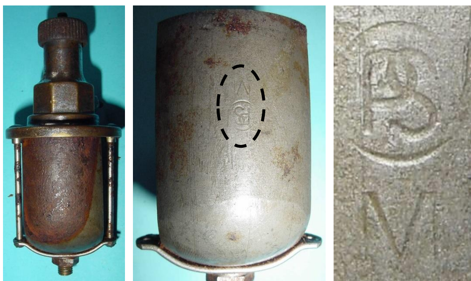
Bild 8.14: Kennzeichnung des Magneten mit dem Logo der Firma P. Schlesinger
