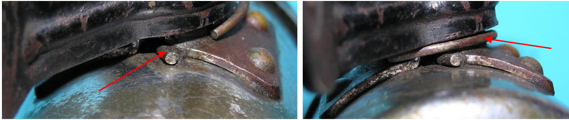
Bild 7.6: Fixierung der Druckfeder im Schlitz des Flansches: a) Federdrahtring verschoben, b) Einengung der Staubkanäle mit einem Drahtfederdrahtring
