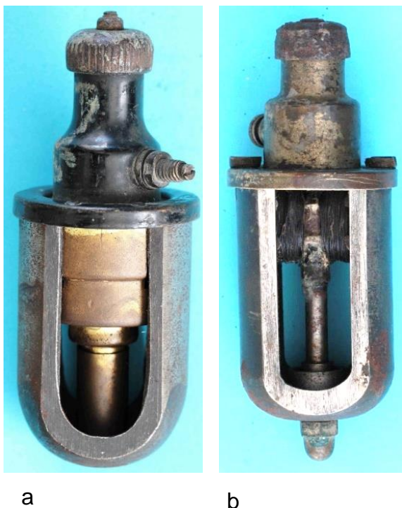
Bild 4.2: Läuferlagerung: a) Lagertopf b) Kugellager im Magnetjoch
