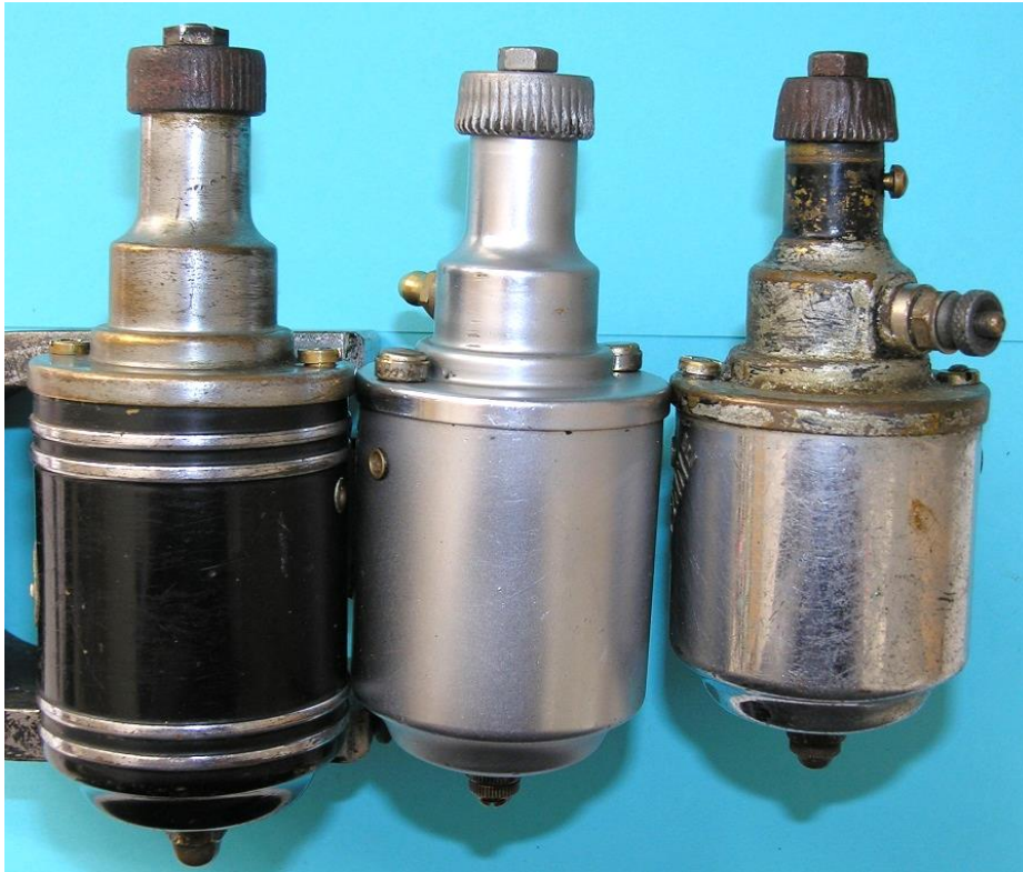
Bild 1.25: Radsonne- Ausführungen der Gruppe 1 a) Typ 62S b) Typ 26 oder 36 c) Typ 16
