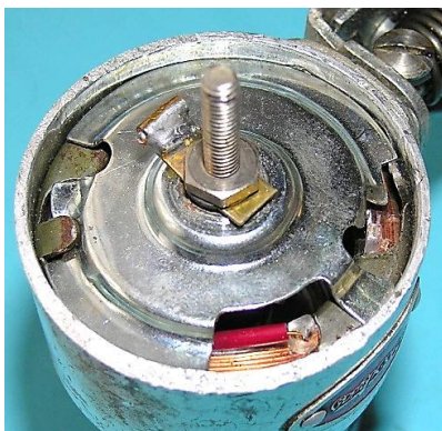
Bild 11.29: Aufgeklappte Kontaktplatte: a) Eingebaute Kontaktplatte, b) Stirnseite des Generators, c) Oberseite der Kontaktplatte
