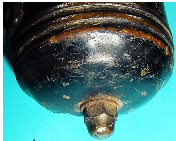
Bild 8.2: Befestigung des Gehäusetopfes: a) Hutmutter für die Spannbolzen des Magneten, b) Hutmutter für die Befestigung des Gehäusetopfes am Magneten
