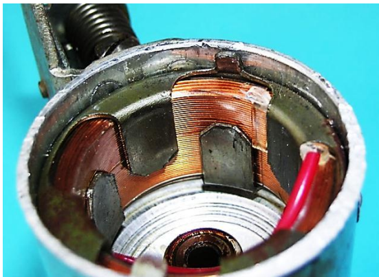
Bild 11.28: Kontaktplatte: a) Axiale Ausdehnung der Klauenpole, b) Lasche zur Befestigung der Kontaktplatte, c) Hochgebogene Lasche
