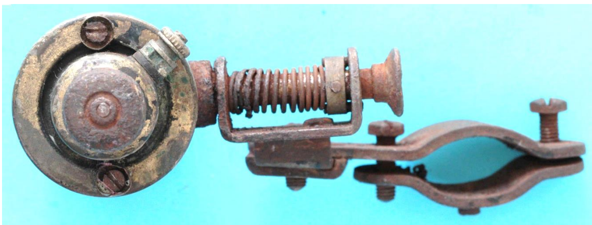
Bild 4.9: Ansicht von oben: 1-Reibrad, 2-Schrauben zur Magnetbefestigung, 3-Kabelanschluss, 4-Bedienungsknopf auf dem Drehbolzen,
