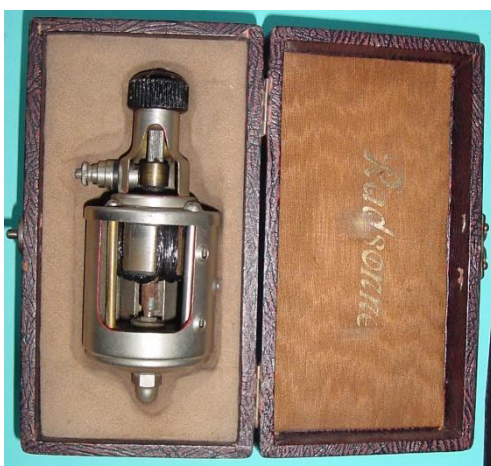
Bild 5.2: Schnittmodell des Magnetstabdynamos in einer Schmuckkassette
