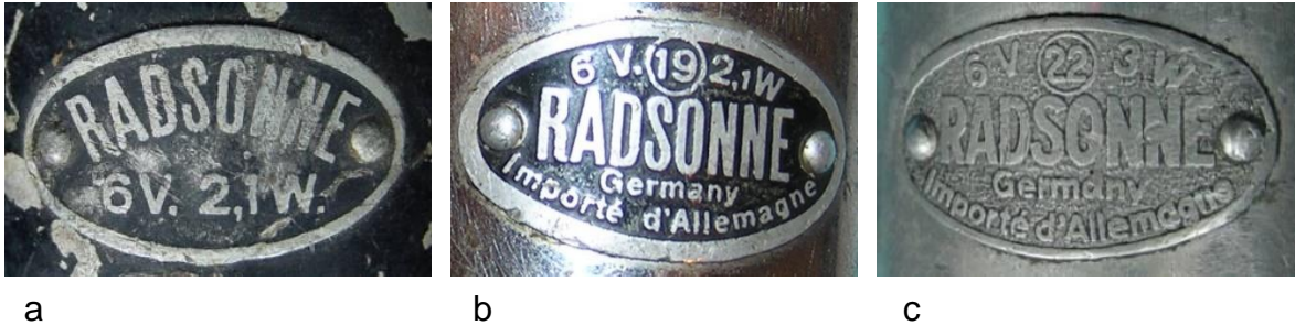
Bild 1.19: Ovale Firmenschilder aufgenietet: a) Nennleistung 2,1 W, b) Typ-Nr.19 für 2,1 W, Fertigungsnummer: 122137 c) Typ-Nr.22 für 3 W
