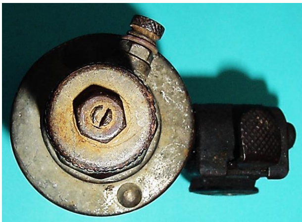
Bild 8.2: Befestigung des Gehäusetopfes: a) Hutmutter für die Spannbolzen des Magneten, b) Hutmutter für die Befestigung des Gehäusetopfes am Magneten
