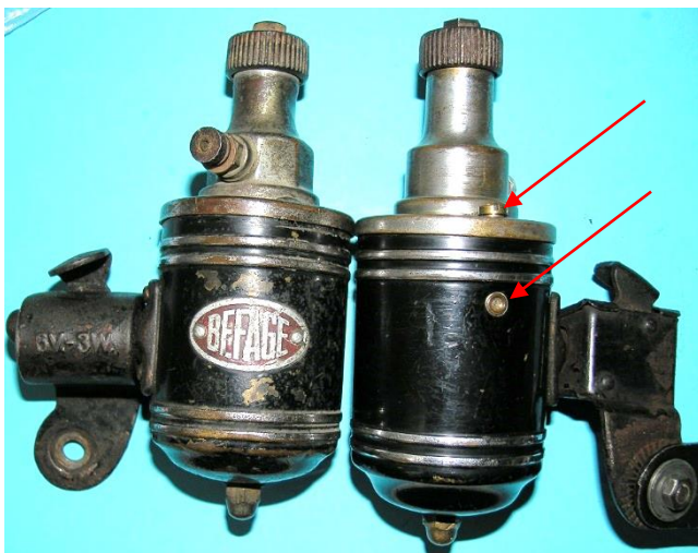
Bild 8.1: Unterschied der Gehäusetopfhöhe von Befage und Typ62S: a) Gruppe 3, Befage, 69 mm b) Gruppe 2, Typ 62S, 74 mm
