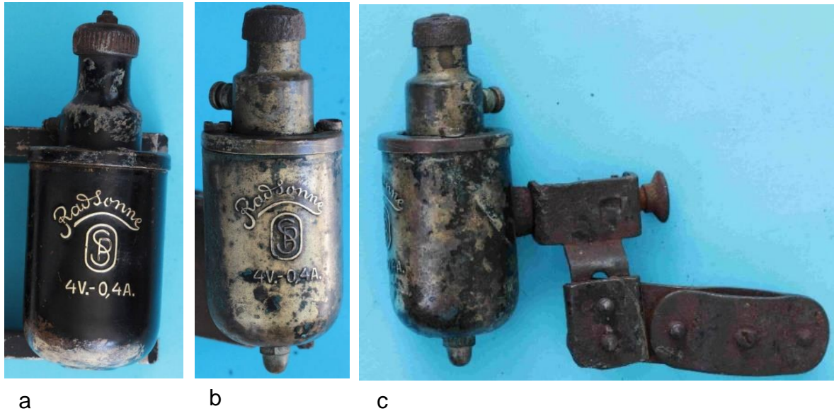
Bild 4.1: Zwei Exemplare der ersten Tulpenmagnetdynamo-Generation: a) und b) Frontseiten, c) Rückseite der Kippvorrichtung
