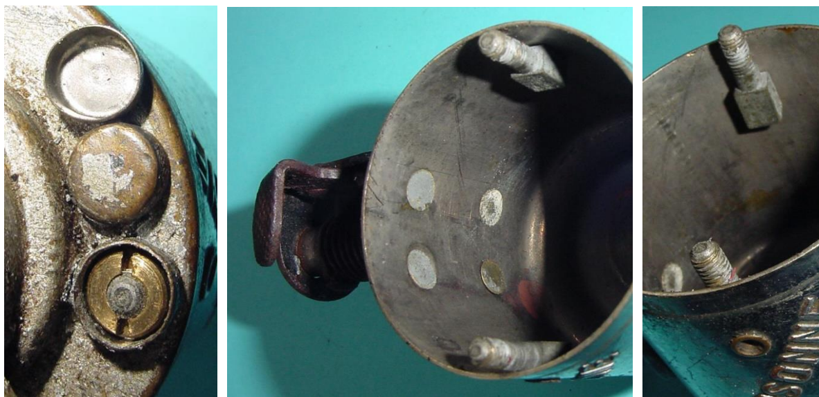
Bild 6.7: Befestigung des Gehäusetopfes am Lagerhalsfuß: a) Schlitzmutter mit Staubkappen, b) Nietköpfe auf der Innenseite, c) Angenietete Stehbolzen
