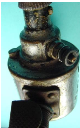
Bild 6.9: Befestigung des einteiligen Flansches Gestaltung mit vier Nieten
