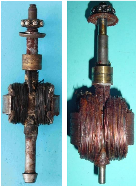
Bild 1.36: Doppel-T-Anker mit Kugellager im Lagerhals
