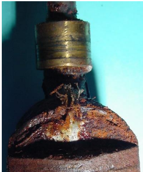
Bild 8.16: Kontaktierung: a) Schleifring mit Spulenanschluss, b) Lötstelle auf dem Ankerendblech
