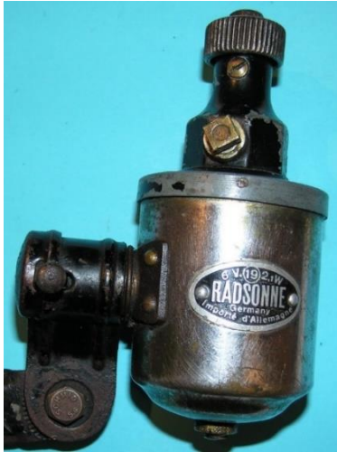
Bild 1.34: Radsonne Typ 19 mit einer anderen patentierter Kippvorrichtung; Fertigungsnummer Nr. 122137; zwei-polig, Leistung: 2,1 W
