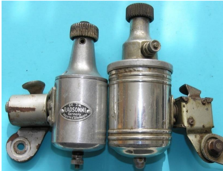
Bild 1.40: Ablösung der Tulpenmagnetdynamos: a) Blätterpoldynamo, Gewicht: 340 g b) Tulpenmagnetdynamo, Gewicht: 510 g
