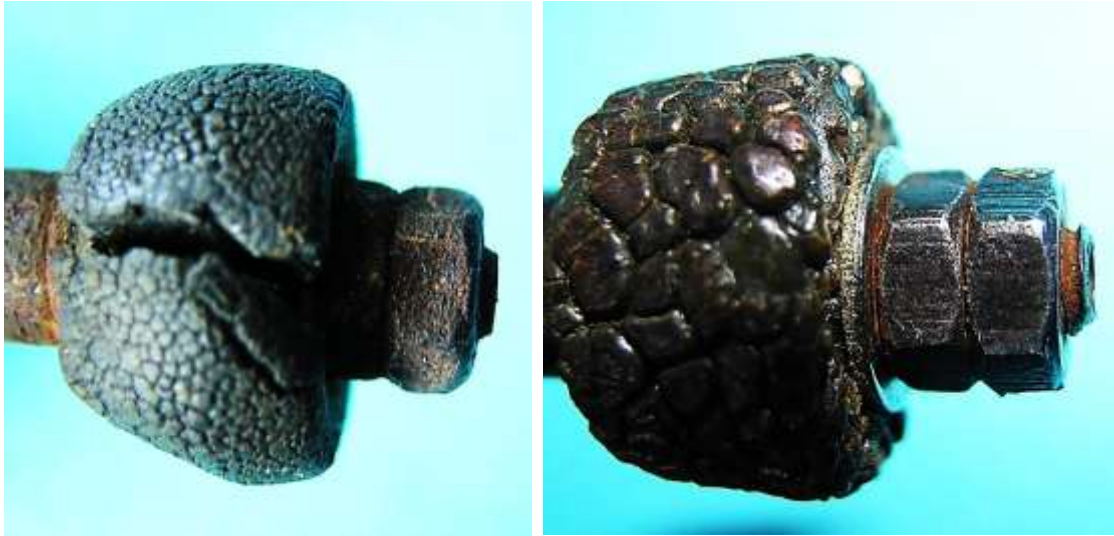
Bild 2.19: Reibrad: a) vom Dynamo mit Blechgehäuse, b) vom Dynamo mit Aluminiumlagerschilde
