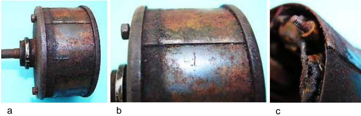
Bild 2.9: Gehäusemantel: a) Ränder an den Lagerschildern zur Fixierung des Mantels, b) Trennstelle des Mantels, c) Unbefestigte Überlappung des Mantelblechs
