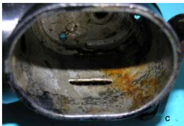
Bild 3.16: Drehbolzen und Druckfeder: a) Drehbolzenkammer beschriftet mit BLOC. ALTERNACYCLE, b) Durchbruch von der Kammer zum Generatorraum, c) Sicherung gegen eine axiale Verschiebung des Drehbolzens
