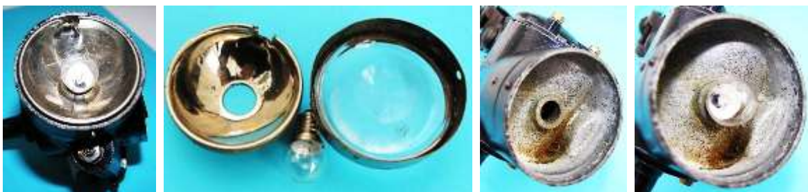
Bild 3.14:: Scheinwerfer: a) Scheinwerfer komplett, b) Spiegel, c) Lampe, d) Glaslinse, e) Lampenfassung (Masseverbindung), f) eingeschraubte Lampe
