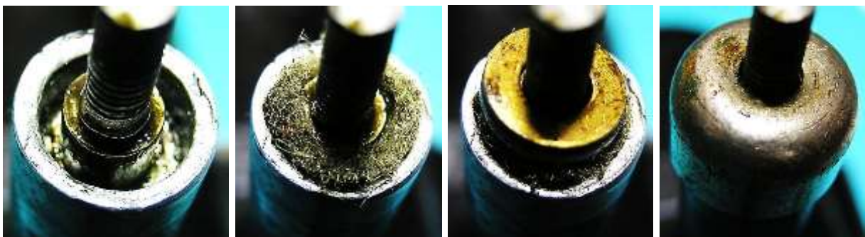
Bild 3.19: Fettdepot für das Gleitlager: a) Oberes Gleitlager, b) Filzring, c) Scheiben, d) Lagerhaube
