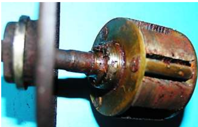
Bild 2.4: Von zwei Messingplatten an den Stirnseiten des Polrades werden die Magnetscheiben zusammengepresst.
