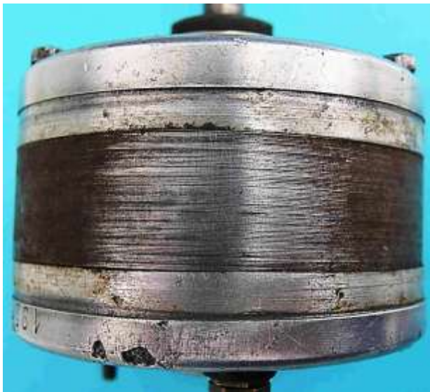
Bild 2.15: Blechpaket mit Distanzringen und Lagerschalen
