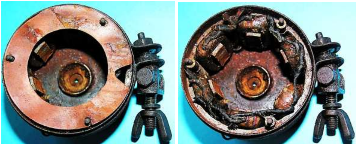
Bild 2.5: Anker: a) Papierisolation zwischen den Ankerwicklungsköpfen und dem Lagerschild, b) Sechs Formspulen auf den ausgeprägten Polen
