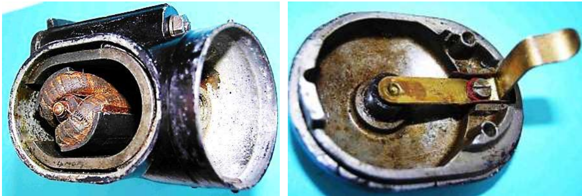
Bild 3.12: Gehäuseteile: a) Gehäuse ohne Boden, b) Innenansicht des Bodens
