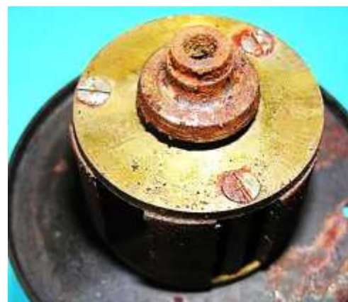
Bild 2.4: Von zwei Messingplatten an den Stirnseiten des Polrades werden die Magnetscheiben zusammengepresst.
