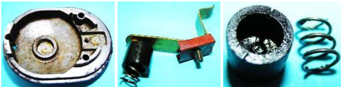
Bild 3.13: Kontaktfeder: a) Boden, b) Kontaktblech zwischen dem Gleitkontakt und der Lampe, c) Axialdruckfeder
