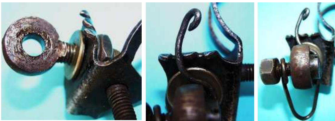
Bild 2.18: Blech mit den Nuten zum Einrasten der Feder und geschlossene Öse zur Befestigung der Halterung am Spannband
