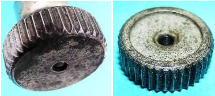
Bild 3.20: Massives Reibrad mit Gewindebohrung
