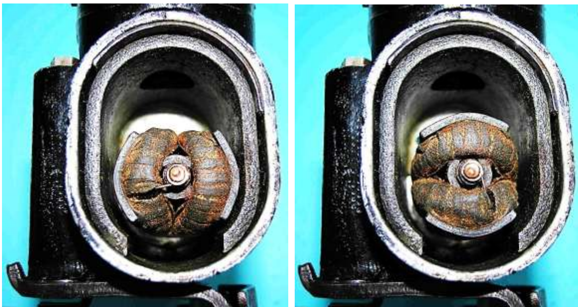
Bild 3.6: Zwei charakteristische Stellungen des Ankers im Dauermagnetfeld
