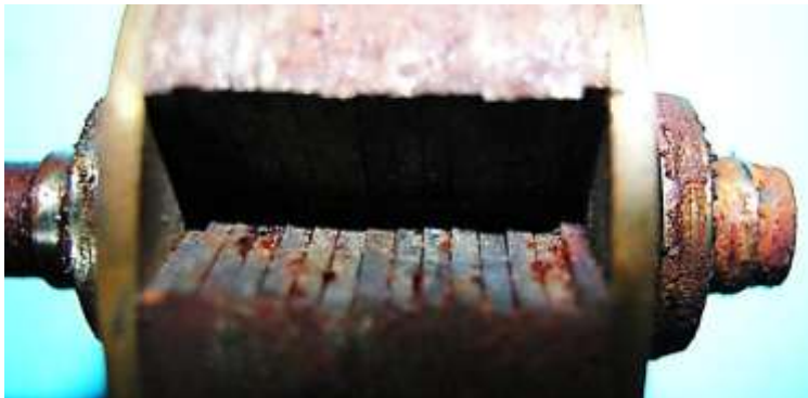
Bild 2.3: Aus 6-nutigen 1,5 mm starken Magnetstahlblechen zusammengesetztes Polrad
