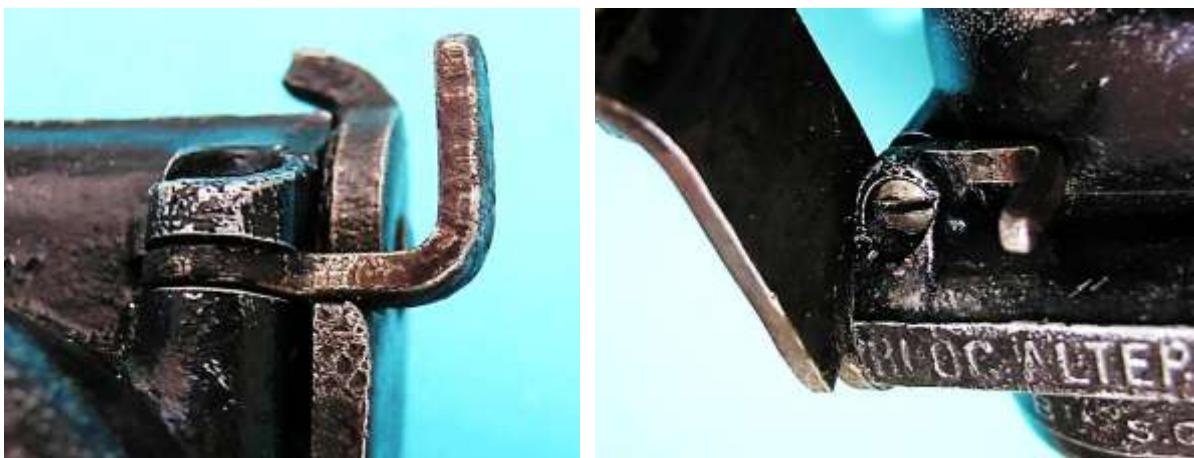
Bild 3.18: Sperrklinke: a) Ruhestellung, b) Betriebsstellung
