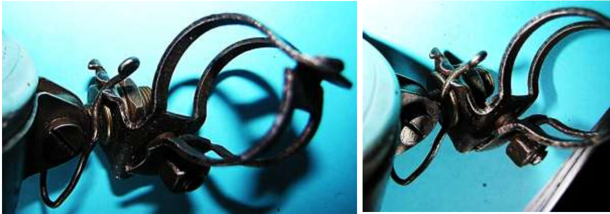
Bild 2.16: Druckfeder in den Raststellungen
