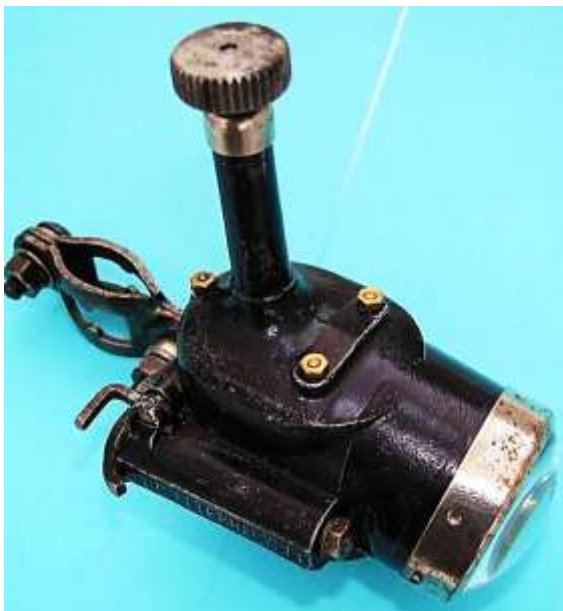
Bild 3.2: Verschraubung des Bodens mit dem Gehäuse mit drei Stahlbolzen (rechts Originalbolzen)
