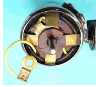
Bild 1.7: Kontaktgruppe: a) Klauenpolanker mit Polrad, b) Eingesetzte Montageplatte des Kabelanschlussbolzens, c) Eingesetzte vierarmige Federklemme für den Massekontakt
