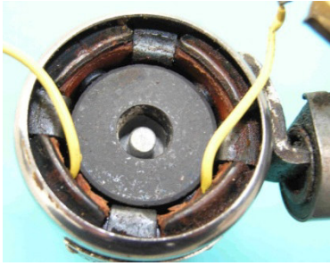
Bild 1.7: Kontaktgruppe: a) Klauenpolanker mit Polrad, b) Eingesetzte Montageplatte des Kabelanschlussbolzens, c) Eingesetzte vierarmige Federklemme für den Massekontakt
