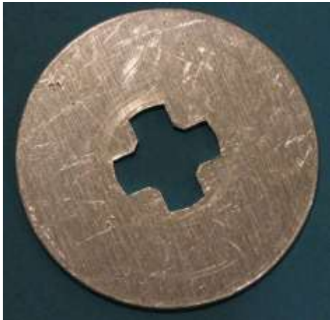
a Bild 2.43: Anker: a) Wirbelstromscheibe, b) und c) Antriebsritzeln
