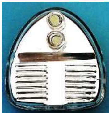
Bild 2.21: Lampe mit zwei LE-Dioden: a) Lampenansicht mit Plexiglasschutzkappe, b) Leuchtdioden und Reflektor bei abgenommener Schutzkappe, c) Anker mit Leuchtdioden im Gehäuse
