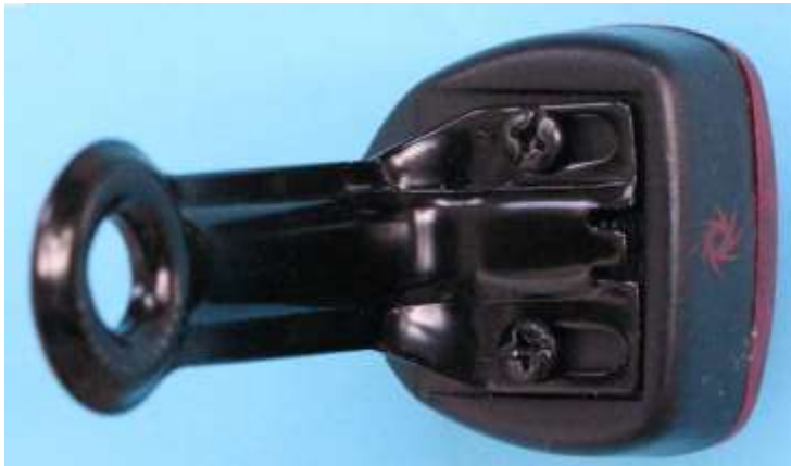
Bild 2.27: Langlöcher im Halter zur Einstellung des Luftspalts
