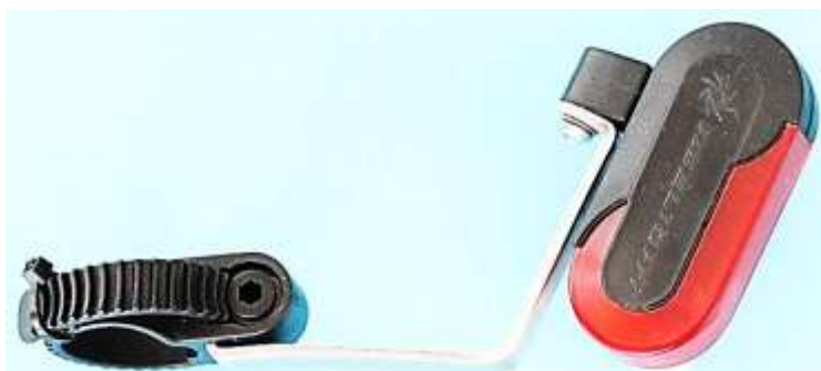
Bild 2.6: CITY Supreme: Polrad, Anker mit einer Spule und LED-Lampen in einem Gehäuse, Antrieb erfolgt über die magnetische Kopplung mit der Aluminiumfelge
