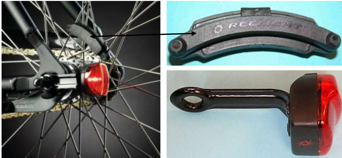
Bild 2.5: Das Gehäuse mit LED-Lampen und Anker ist an der Radachse mit einem Halter befestigt
