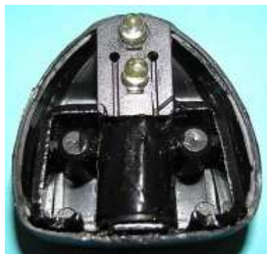
Bild 2.21: Lampe mit zwei LE-Dioden: a) Lampenansicht mit Plexiglasschutzkappe, b) Leuchtdioden und Reflektor bei abgenommener Schutzkappe, c) Anker mit Leuchtdioden im Gehäuse
