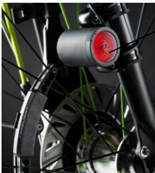
Bild 2.4: Generator mit Drahtverbindung zum Scheinwerfer und zum Rücklicht SL500 (Firmenfoto)
