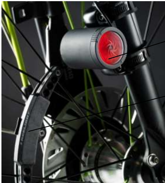
Bild 2.12: Ankerwicklung und Kondensator gemeinsam in einem Gehäuse; Magnet an den Speichen befestigt; Scheinwerfer und Rücklicht mit Kabel angeschlossen, SL500, Firmenfoto
