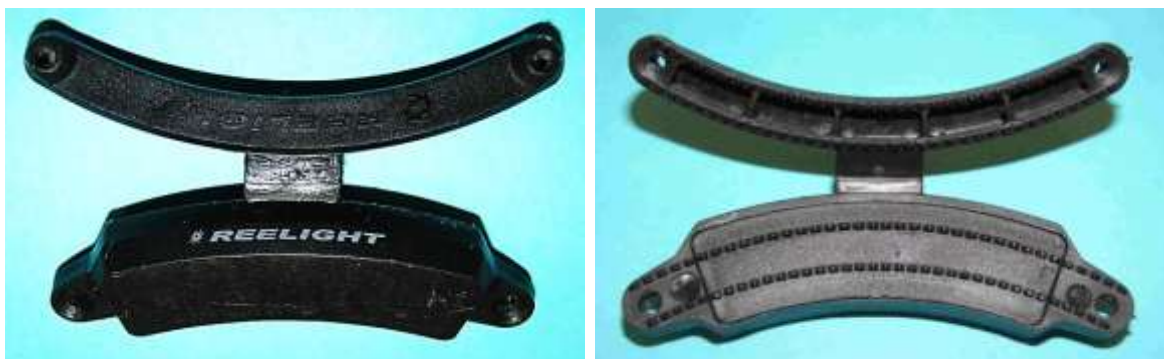
Bild 2.9: Aufgeklappte Schale, mit der das Magnetsystem an den Speichen befestigt ist
