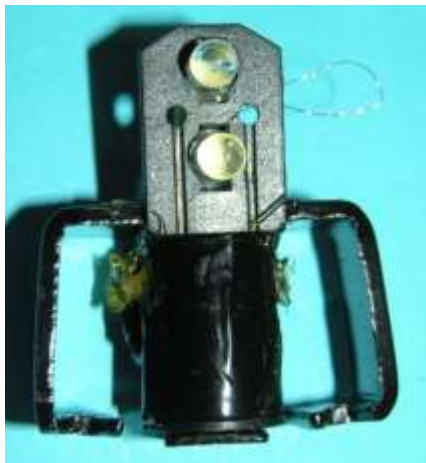
Bild 2.21: Lampe mit zwei LE-Dioden: a) Lampenansicht mit Plexiglasschutzkappe, b) Leuchtdioden und Reflektor bei abgenommener Schutzkappe, c) Anker mit Leuchtdioden im Gehäuse
