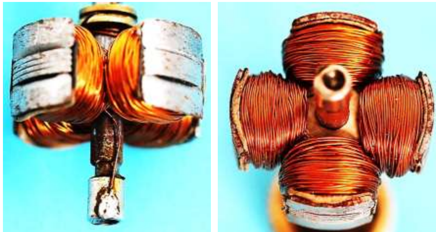
Bild 2.8: Anker: a) Vollständiger Sternanker b) untere Wicklungsköpfe
