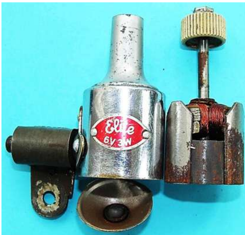
Bild 3.4 Baugruppen: a) Dreiteiliges Gehäuse mit Kippvorrichtung, b) Generator mit Reibrad
