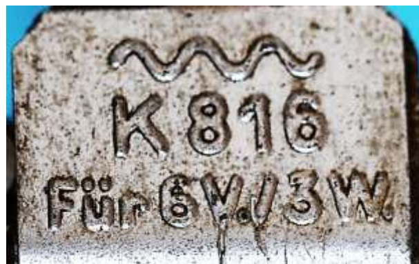
Bild 2.2: Beschriftungen: a) Firmenschild, b) Nenndaten auf der Kippvorrichtung
