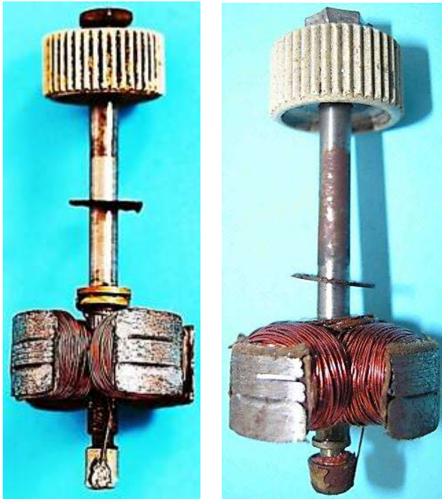
Bild 1.3: Anker Ausführungen: a) Fribu, b) Elite
