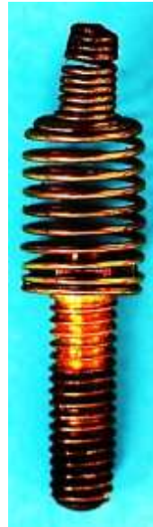
Bild 2.10: Kabelanschlussbolzen mit eingezogener Schraubenfeder als Schleifkontakt
