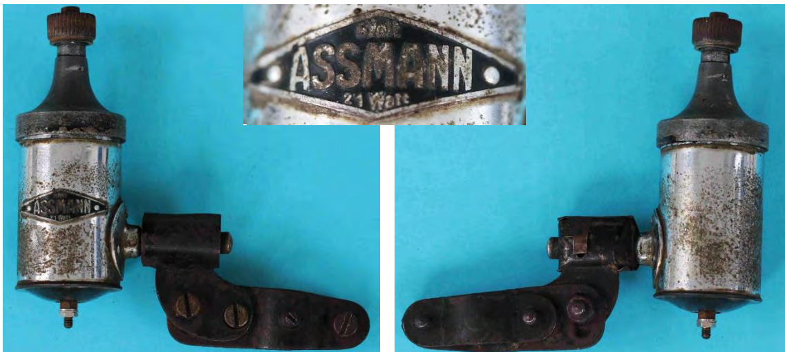
Bild 1.7: Assmann ohne Fußpedal, Leistung 2.1 W
