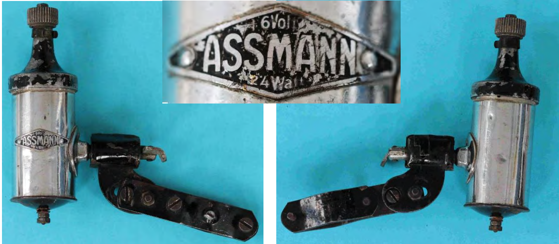
Bild 1.8. Assmann mit Fußpedal. Leistung 2,4 W
