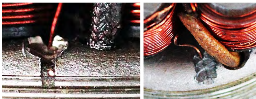
Bild 2.20: Technologien zum Anschluss der Spule an das Ankerjoch
