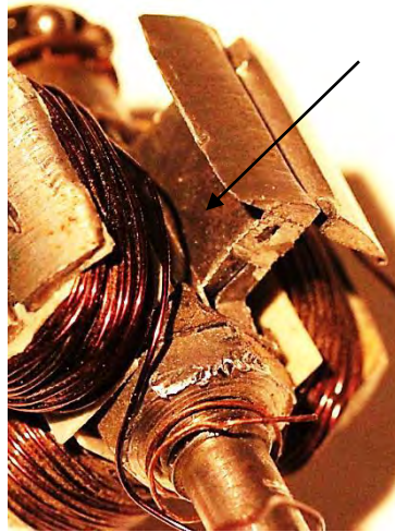
Bild 3.14: Abgewickelter Pol: a) Isolierung des Polschaftes, b) Blanker Polschaft
