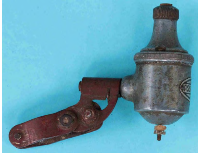
Bild 1.11: Tulpenmagnetdynamos: a) Gezogenen Aluminiumgehäusetopf, b) Gegossene Gehäuseteile
