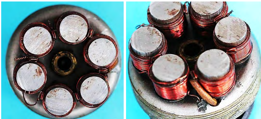
Bild 2.19: Spurlager und Polflächen des Ankers (A2)
