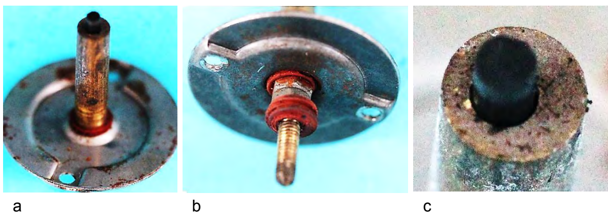
Bild 3.26: Spannteller und Bürstenhalter: a) Bürstenhalter mit Bürste, b) Kabelanschlussbolzen, c) Positionierung der Bürste außerhalb der Drehachse
