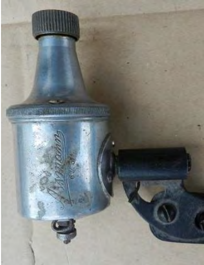
Bild 1.11: Tulpenmagnetdynamos: a) Gezogenen Aluminiumgehäusetopf, b) Gegossene Gehäuseteile
