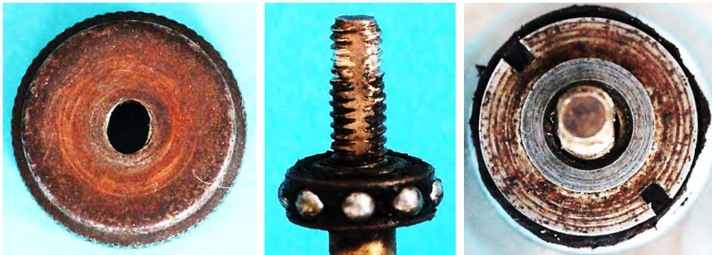
Bild 2.7: Befestigung des Reibrades: a) Reibrad mit ovaler Bohrung, b) Wellenende mit Schlüsselflächen, c) Mutter zur Einstellung des Axialspiels
