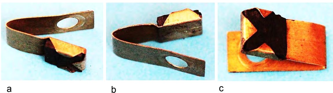
Bild 3.8: Blattfeder mit eingeklemmter Kohlebürste
