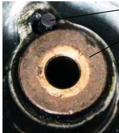
Bild 1.9: Massekontaktbürste im Lagerhals
