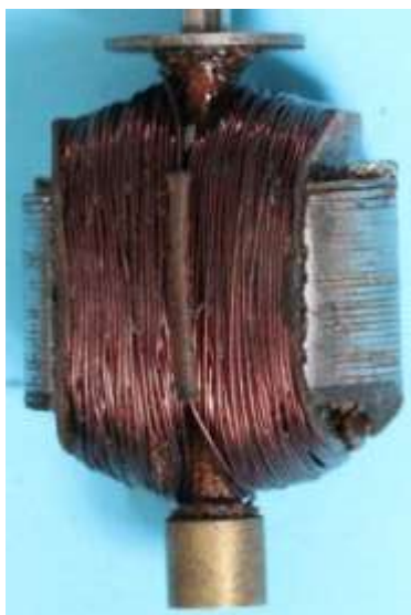
Bild 1.11: Anker: a) Ankerwicklung, b) Ankerblechpaket
