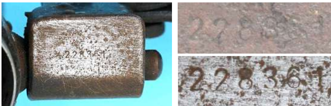
Bild 1.3: Abdeckung der Kippvorrichtung mit der Fertigungsnummer 228361
