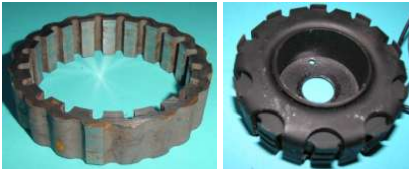
Bild 7.1: AlNiCo-Magnet im Nabendynamo 1938
