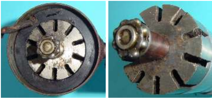
Bild 3.5: Massives Polrad mit gefrästen Pollücken
