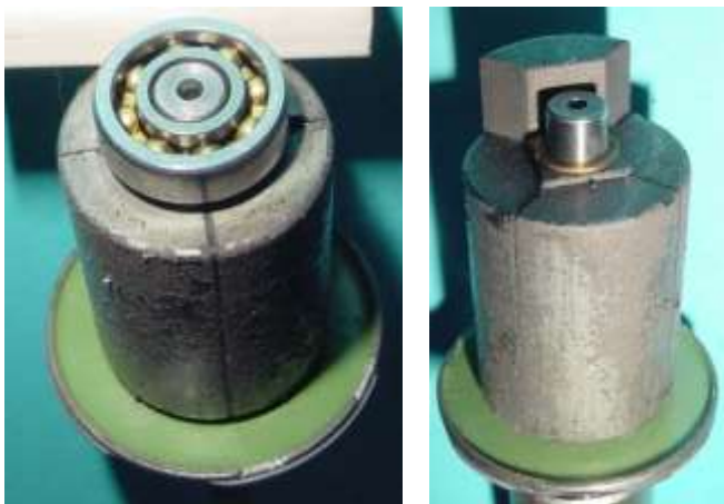
Bild 8.3: Vierpoliges Polrad im Seitendynamo mit selbsthaltenden Magnetsegmenten
