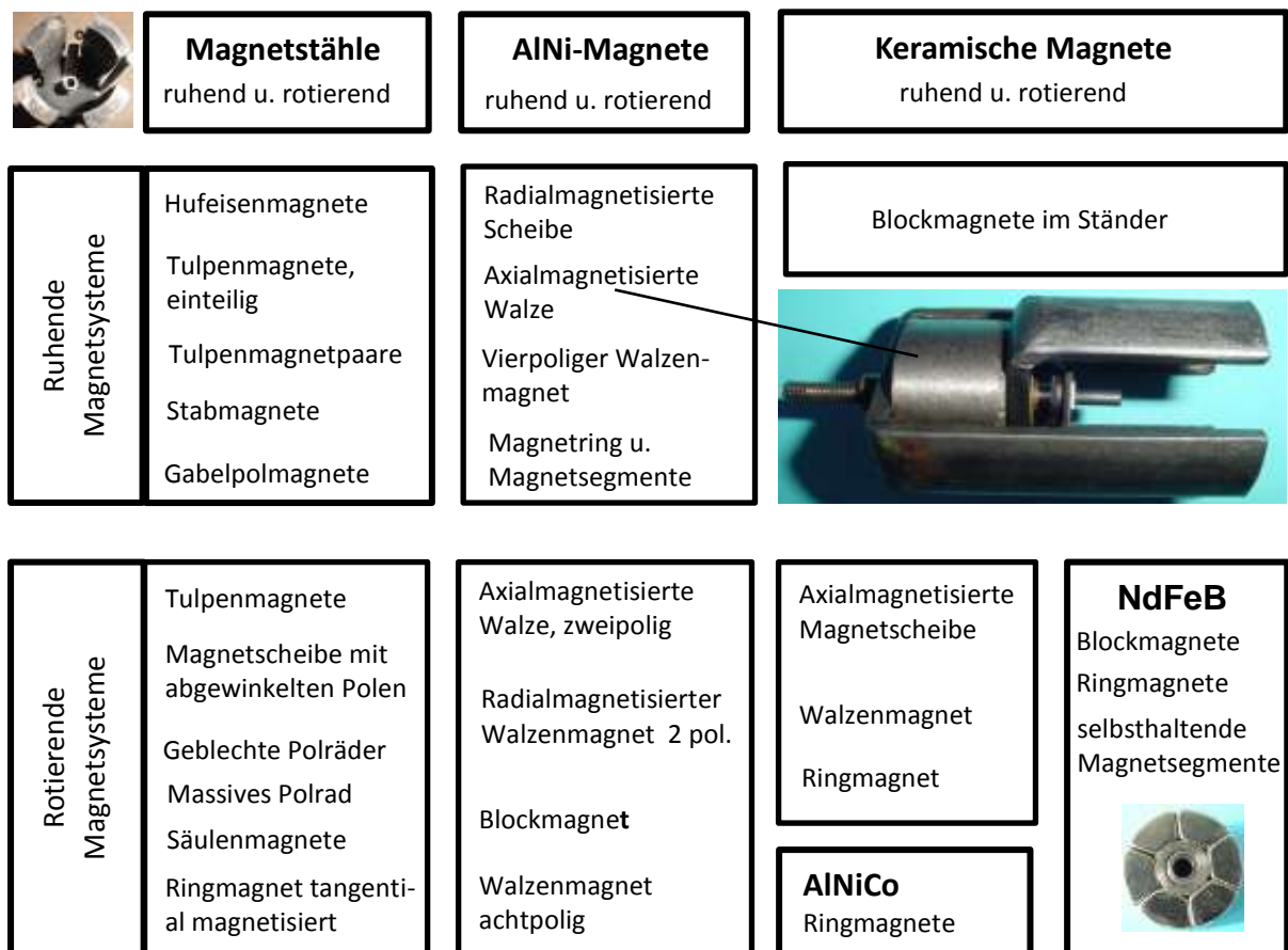
Bild 1.1: Magnetmaterialien und konstruktive Gestaltung ruhender und rotierender Erregersysteme
