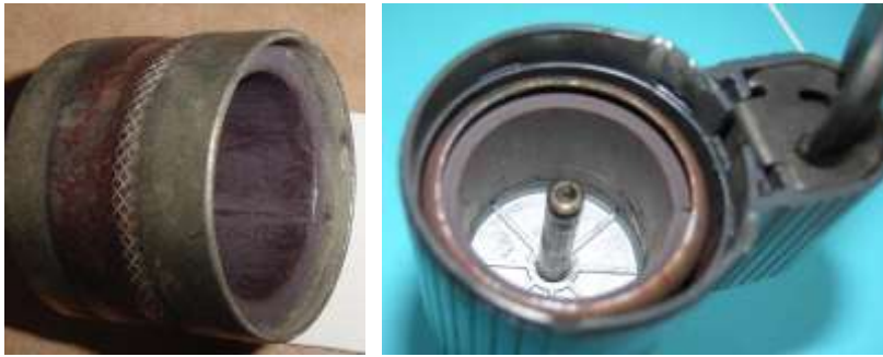
Bild 6.3: Kunststoffgebundene Magnetstreifen a) Walzendynamo b) Seitendynamo
