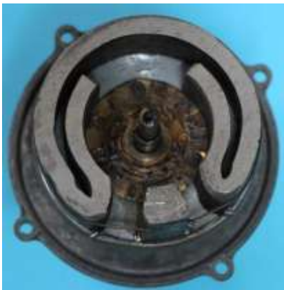
Bild 3.3: Polrad mit eingeklappten magnetischen Polschuhen
