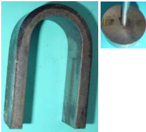
Bild 1.5: Gegenüberstellung eines Hufeisenmagneten von 1910 mit einem Walzenmagneten von 1956
