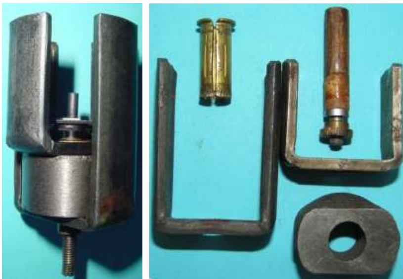
Bild 4.1: Axialmagnetisierte Magnetwalze mit ferromagnetischen Gabelpolen
