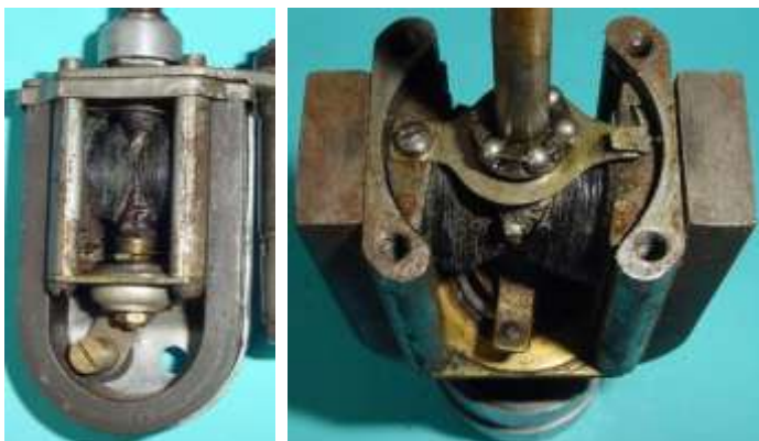
Bild 2.2: Hufeisenmagnet mit einem Anker in der Hufeisenebene
