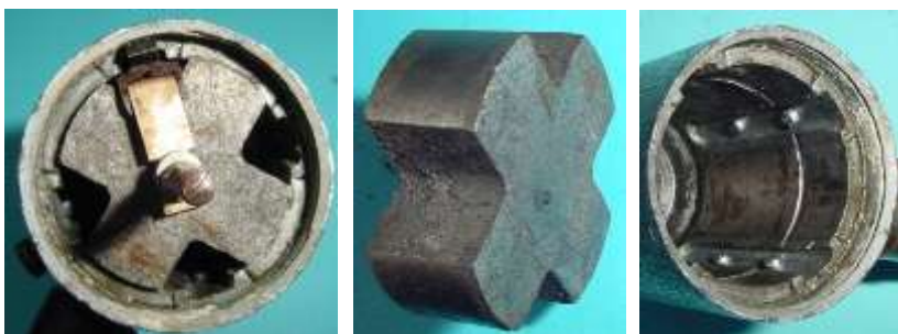
Bild 4.2: Radialmagnetisierter Magnetstern: a) An ferromagnetische Stäbe angepasster Magnet, b) Sternmagnet, c) Eingegossene ferromagnetische Stäbe
