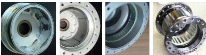
Bild 8.1: Bestückung der Naben mit NdFeB-Magneten:
