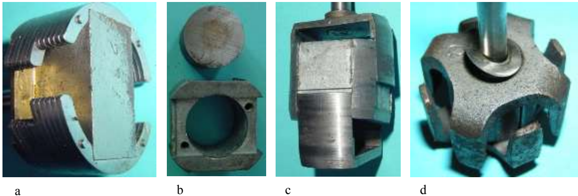
Bild 5.1: Zweipolige Dauermagnete mit ferromagnetischen Polschuhen: a) 2-polig mit geblechten Polschuhen, b) Zylindrischer Magnet mit Aluminiumtragkörper, c) Gabelpolschuhe für b) (4-polig), d) 8-polige Klauenpolanordnung
